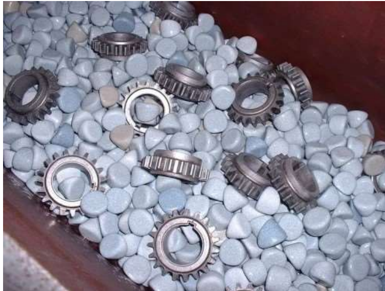
Obrázek 5 Omílání ozubených kol [11]
