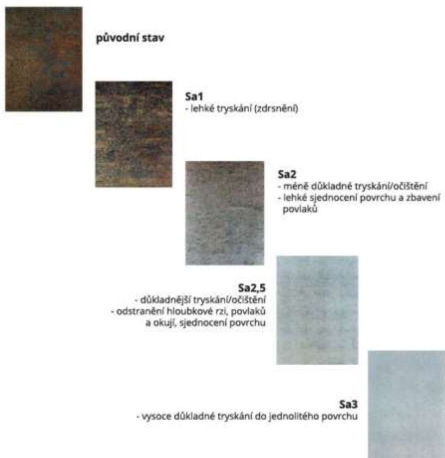
Obrázek 8 Ukázka stupně přípravy povrchu dle ČSN EN ISO 8501-1 [3]
