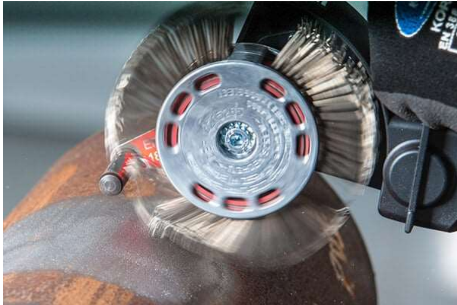
Obrázek 20 Ukázka tryskání štětinami [27]
