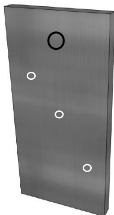
Obrázek 30: Ukázka měření vzorku na třech místech
