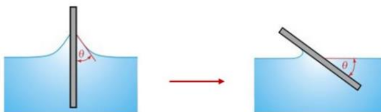
Obrázek: Naklánějící se destička, která je závislá na kontaktním úhlu [36]
