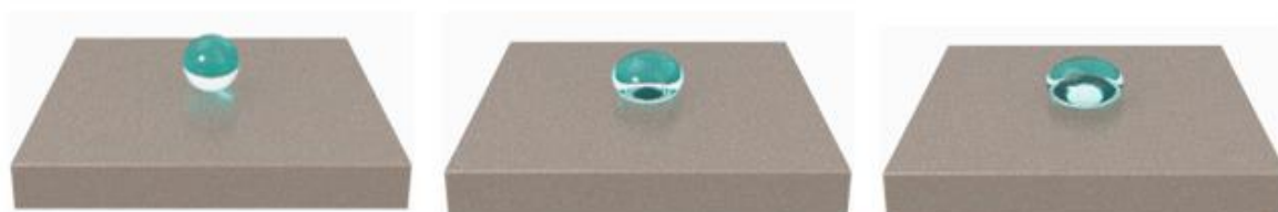
Obrázek 11: Ukázka kapky, která povrch špatně smáčí. [33]
