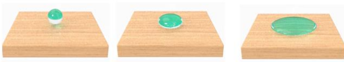
Obrázek 10: Ukázka kapky, která má střední povrchovou energii. [33]
