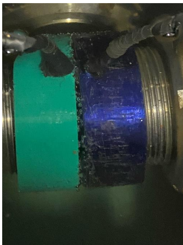
Obrázek 65 Formace a strhávání bublin plynů po zapnutí čerpadla
