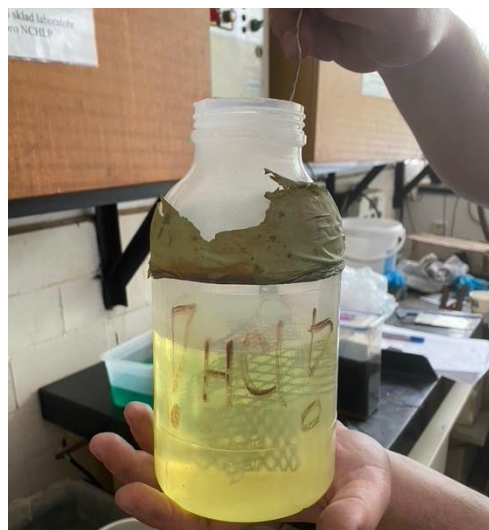
Obrázek 48 Odmašťování v ultrazvukové čističce a moření v kyselině chlorovodíkové
