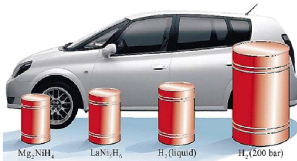
Obrázek 27 Vizualizace objemu 1kg vodíku skladovaného v kovových hydridech ( Mg_2NiH_4 a LaNi_5H_6 ), v kapalně formě a pod tlakem [83]
