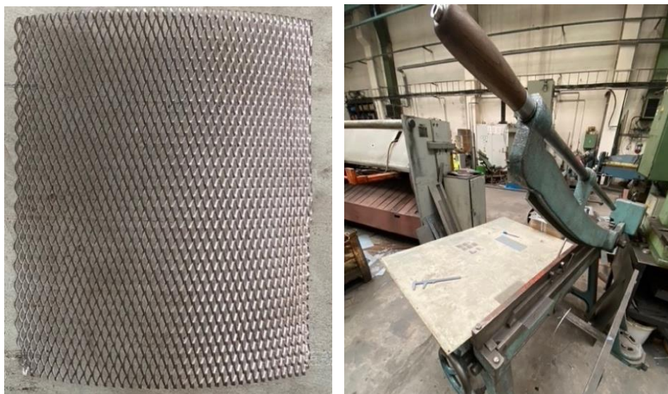
Obrázek 46 Tabule titanové mřížky a proces dělení pruhů na pákových nůžkách
