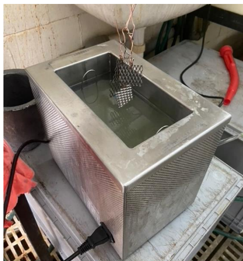
Obrázek 48 Odmašťování v ultrazvukové čističce a moření v kyselině chlorovodíkové
