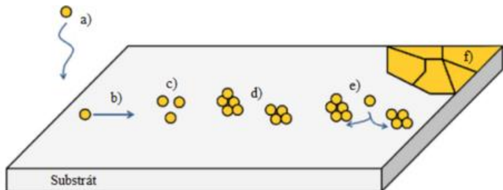
Obrázek 31 Schéma postupného vzniku povlaku a) Atomy povlakuujícího materiálu jsou přesouvány do blízkosti substrátu b) Dochází k sorpci a difuzi c) Na povrchu substrátu se postupně shlukují atomy d) Vznik prvních ostrůvků e) Růst ostrůvků až do vytvoření souvislé vrstvy f) Růst souvislé vrstvy [305]
