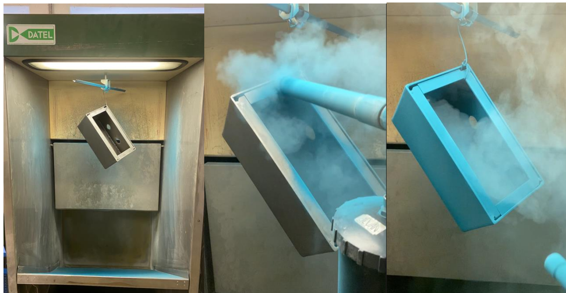
Obrázek 43 Zavěšení výrobku do stříkacího boxu a následný proces nanášení prášku
