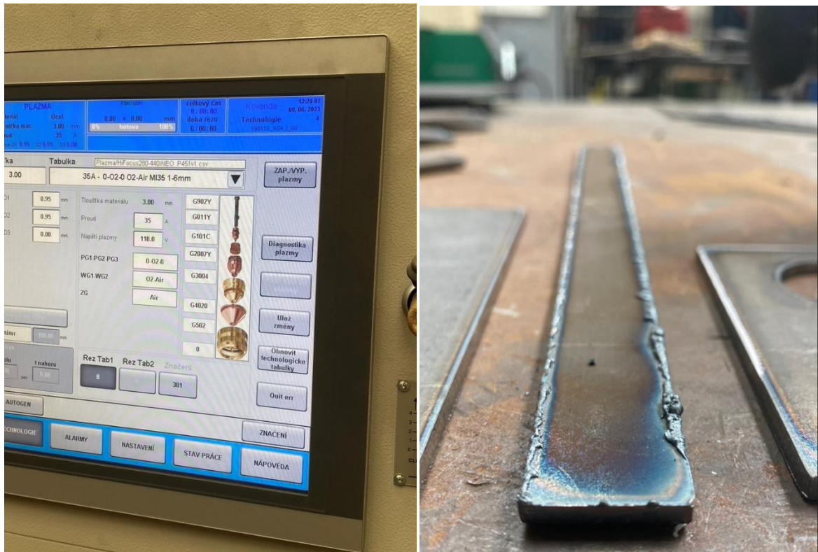
Obrázek 39 Snímek sestavy trysky a opalky na hranách polotovaru
