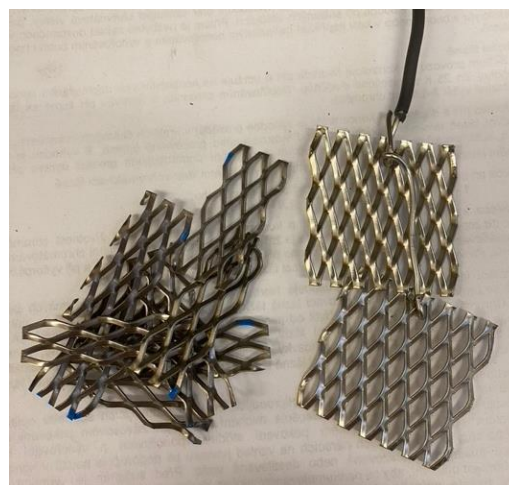
Obrázek 49 Proces galvanického niklování a srovnání povrchu titanových mřížek (vlevo) a poniklovaných mřížek (vpravo)
