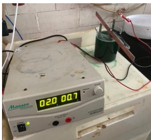
Obrázek 49 Proces galvanického niklování a srovnání povrchu titanových mřížek (vlevo) a poniklovaných mřížek (vpravo)
