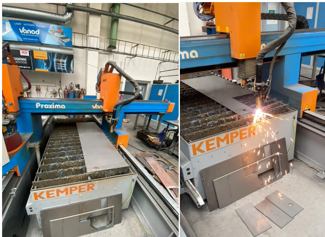
Obrázek 38 Plazmová řezačka Proxima od společnosti Vanad, na které byly zhotoveny díly nádob
