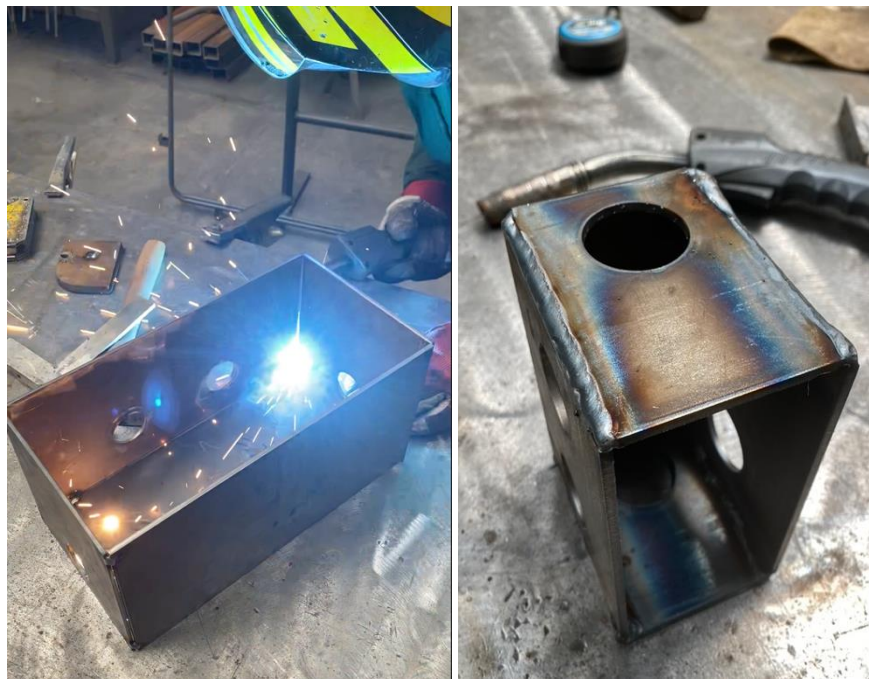
Obrázek 40 Příprava bodovými svary a výsledný svařenec
