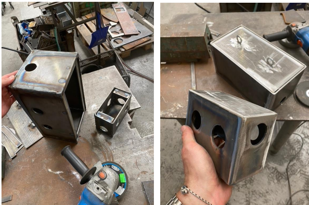
Obrázek 41 Nádoby před broušením a po broušení svarových ploch
