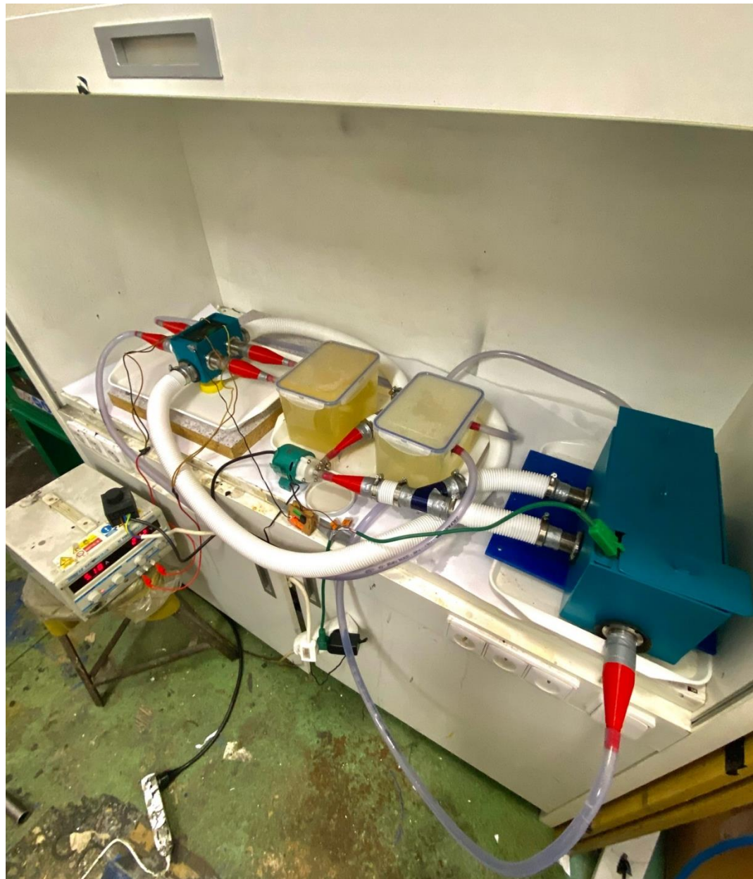
Obrázek 66 Finální sestava bezmembránového elektrolyzáru
