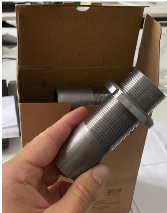
Obrázek 50 Nátrubek osazený závitem M35x1.5 a maticí stejného typu
