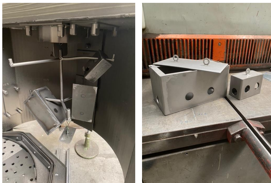
Obrázek 42 Navěšení dílů v tryskacím prostoru tryskače a výsledný sjednocený povrch dílů po tryskání
