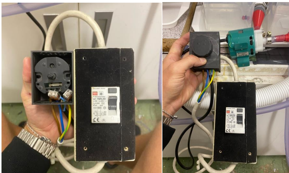
Obrázek 59 Zapojení chemického čerpadla na zdroj a frekvenční měnič pomocí wagu svorek
