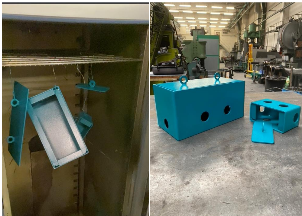
Obrázek 44 Proces vytvrzování reaktoplastu v peci při teplotě 180 °C a finální podoba nalakovaných nádob
