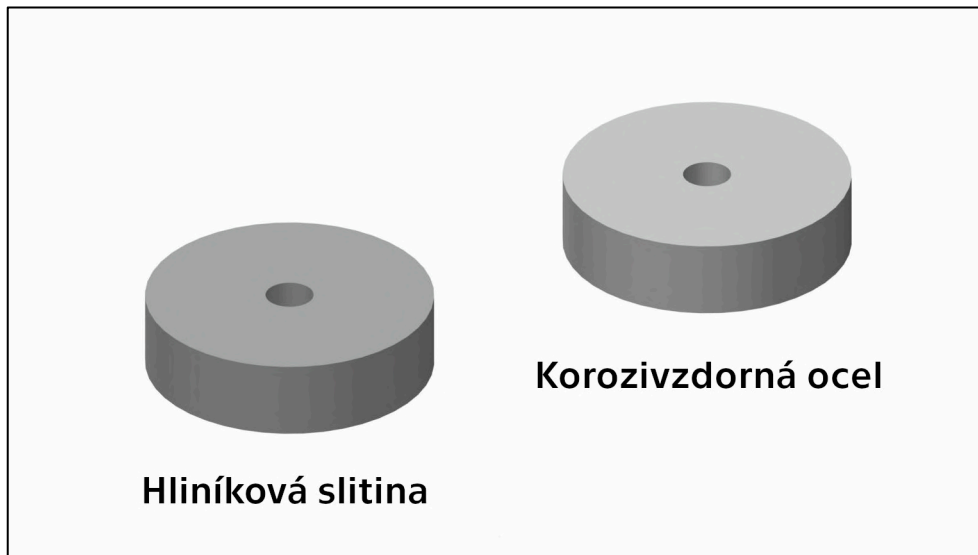
Obr. 24 – Vzorky pro difúzní svařování po dělení a vrtání vodicích děr
