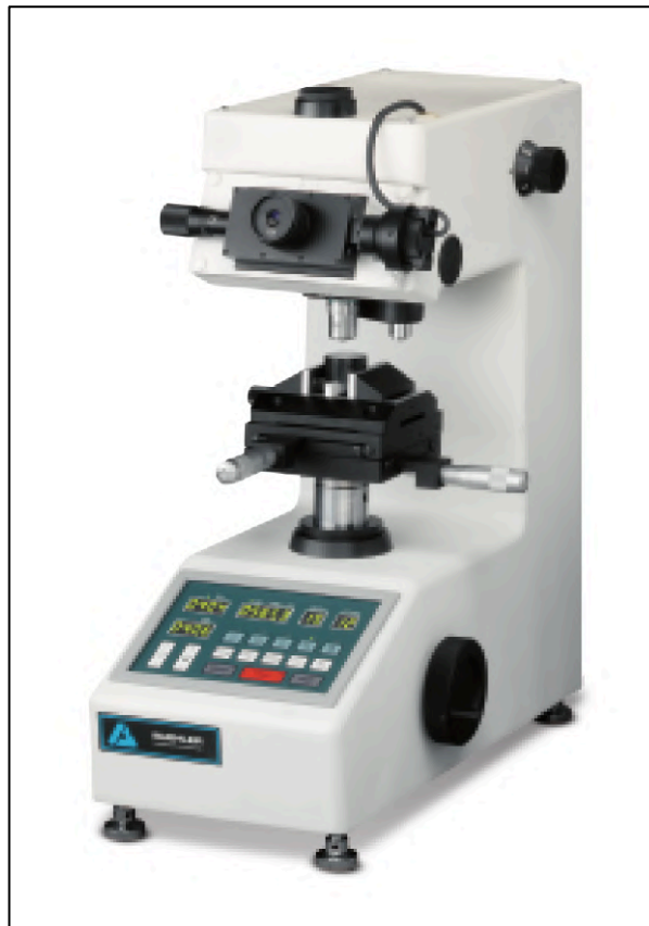
Obr. 39 – Použitý tvrdoměr Buehler IndentaMet 1100
