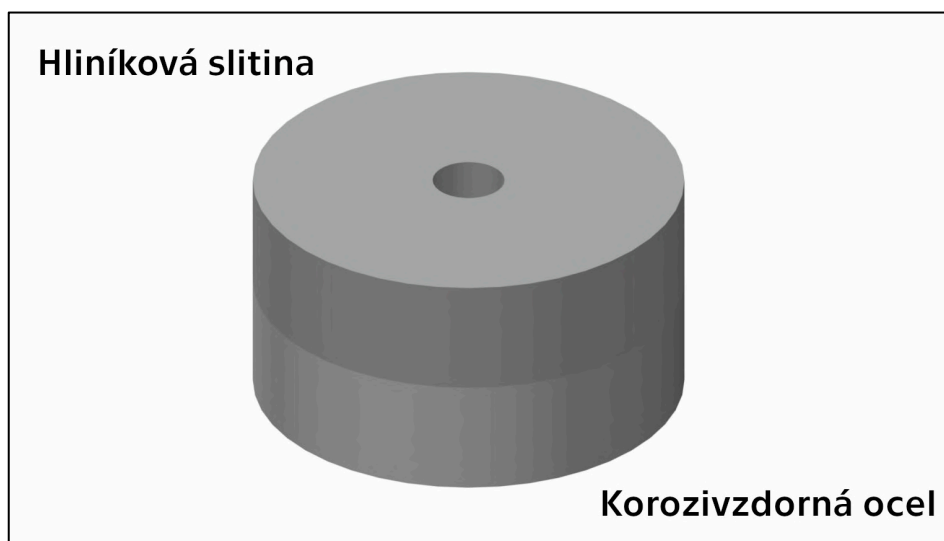
Obr. 33 – Difúzně svažené vzorky po vyjmutí ze svařovacího zařízení
