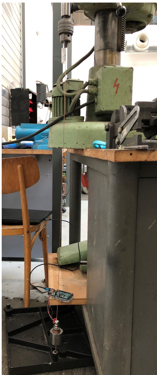
Obr. P.4: Druhý experiment: rotor s pevně připevněnou částí statoru.
