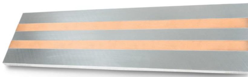
Obr. 5: Elektricky vodivá vrstva z Cu připravená technologií CS [12].
