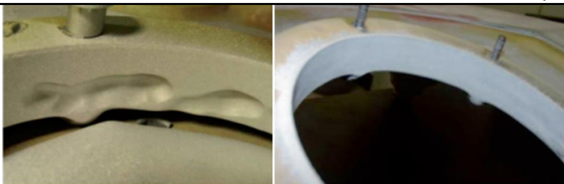
Obr. 7: Příklad opravy převodové skříně helikoptéry. Vlevo – porušená oblast před opravou.
