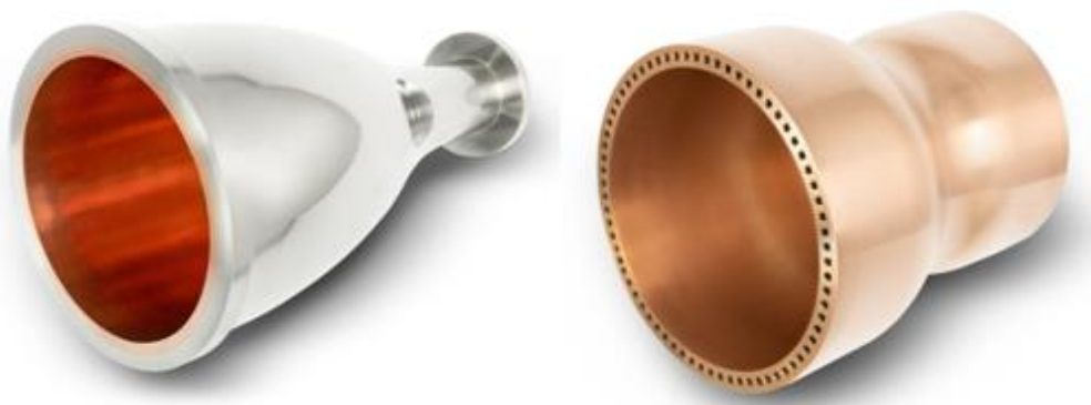
Obr. 8: Spalovací komory pro raketu aditivně vyrobené technologií CSAM. Vlevo je komora tvořená dvojicí materiálu Inconel + CuCrZr. Vpravo je komora se složitou vnitřní strukturou a chladicími kanálky [12].
