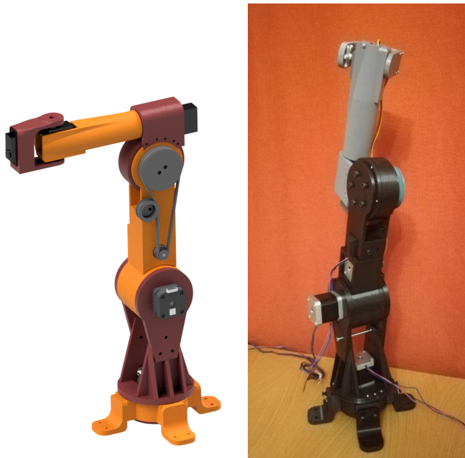
Obrázek 3.18: Prototyp ramene s dvojitou cykloidní převodovkou
