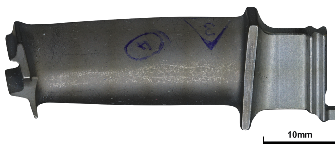
Obrázek 1: Rotorová lopatka prvního stupně vysokotlaké turbíny turbohřídelového motoru TV3-117.
