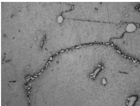
Obrázek 9: Zipper-like struktura tvořená karbidy typu M_{23}C_6 v superslitině Rene 41. [2]
