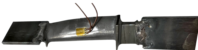
Obrázek 62: Zkušební vzorek lopatky s připevněným tenzometrem (Lopatka L1 - délka vrubu 1,1 mm) a přivařenými destičkami pro uchycení do zkušebního stroje. Pozn.: Přibližná délka lopatky s destičkami je 100 mm.
