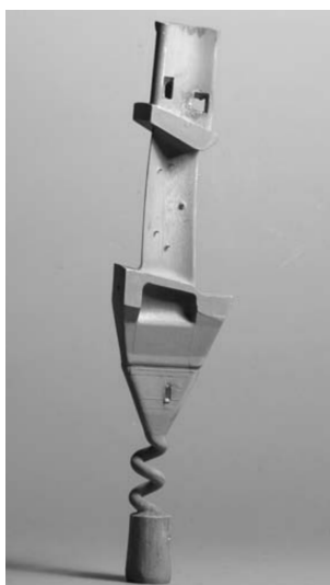
Obrázek 10: Voskový model lopatky s grain selectorem. [1]
