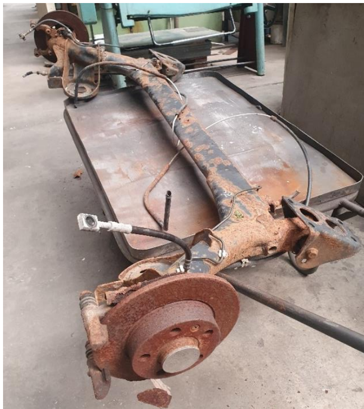
Obr. 30: Zadní náprava automobilu Škoda Fabia I před mechanickou úpravou
