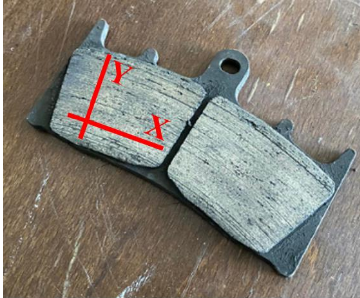
Obr. 42: Naznačení směrů při měření drsnosti brzdové destičky
