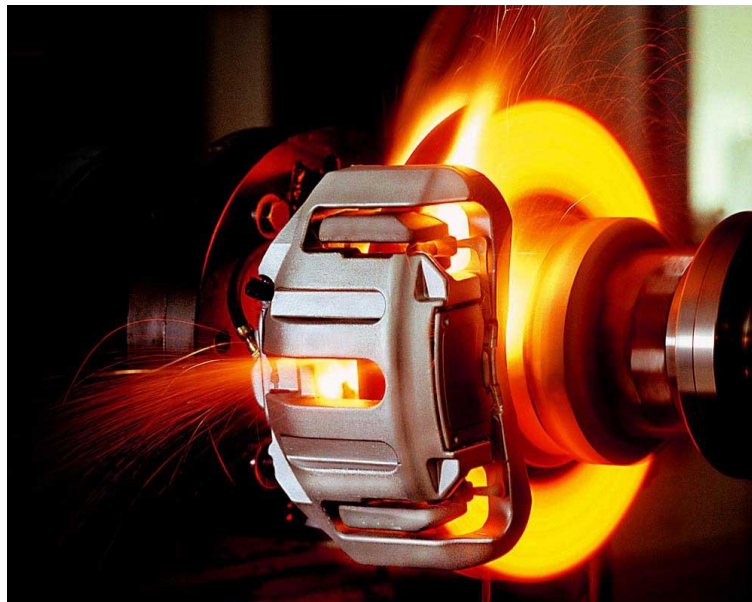
Obr. 15: Brzdový systém během testování [20]
