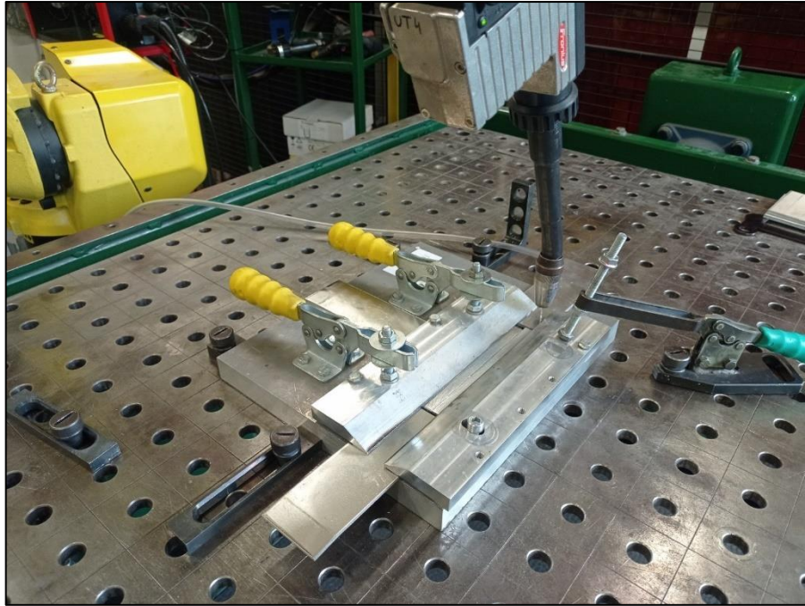
Obr. 19- Upnutí základního materiálu pomocí přípravku.
