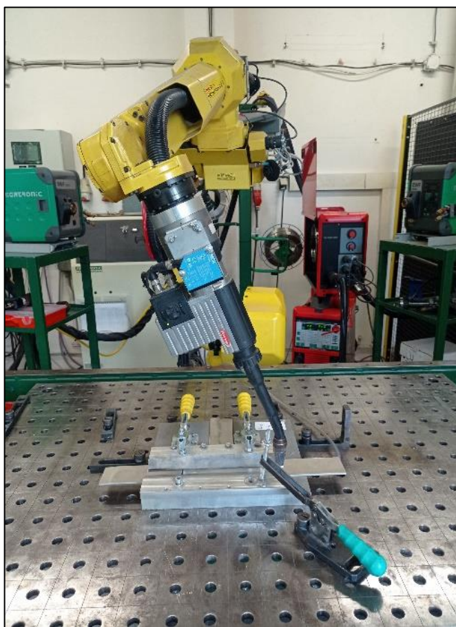
Obr. 12- Ukázka robota Fanuc a svařovacího přípravku.
