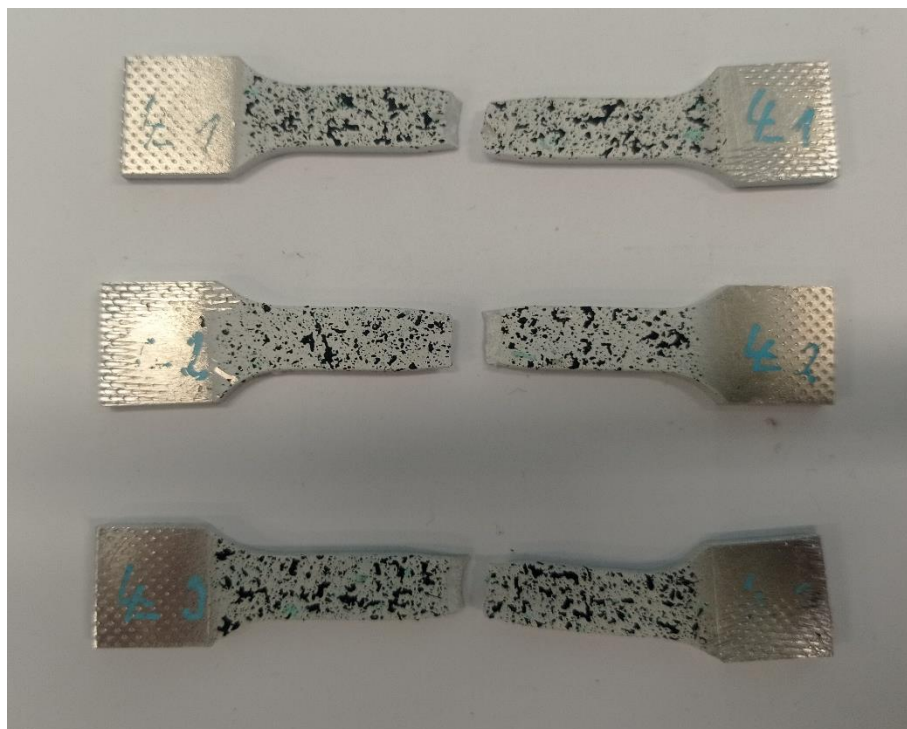
Obr. 44- Vzorek po zkoušce tahem-OK Autrod 5183
