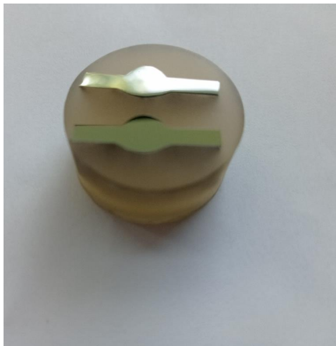
Obr. 23- Vzorek určený pro analýzu makrostruktury.
