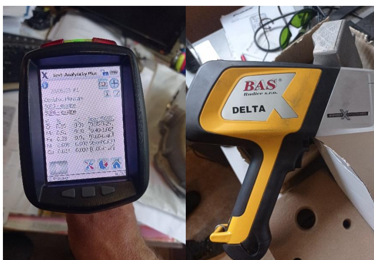
Obr. 14- Ukázka z měření chemického složení základního materiálu.
