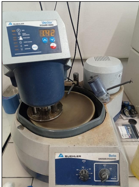
Obr. 22- Leštění pomocí zařízení Buehler Grinder-Polisher Beta s automatickou hlavou Vector.
