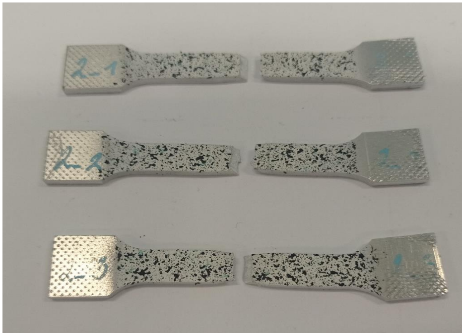
Obr. 46- Vzorek po zkoušce tahem-OK Autrod 5087.
