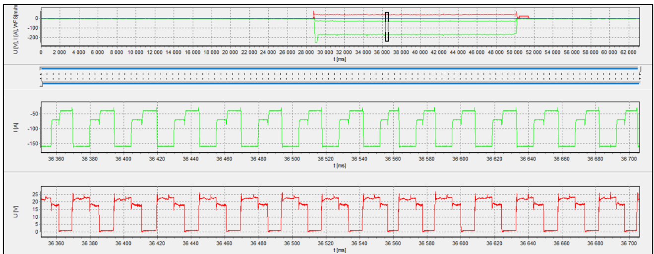
Obr. 21- Průběh proudu a napětí v závislosti na čase při režimu CMT.
