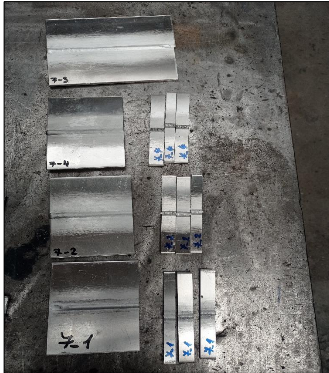
Obr. 35- Hrubé dělení svařených vzorků pro obrobení do požadovaného tvaru.
