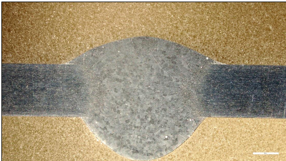
Obr. 26- Makrostrukturní analýza-vzorek OK Autrod 5183.
