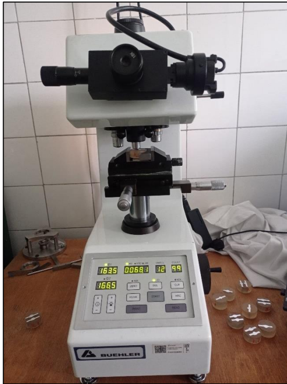
Obr. 30- Univerzální tvrdoměr Buehler IndentaMet 1104.
