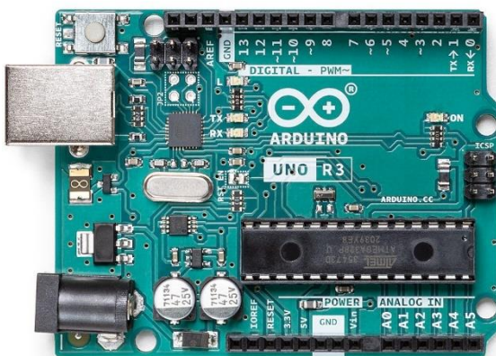
Obrázek 22 Vývojová deska Arduino Uno Rev3 [34]
