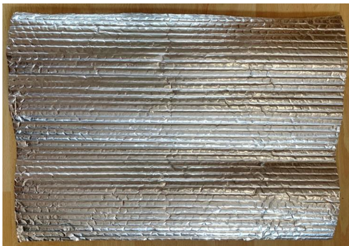
Obrázek 13 Reflexní izolační folie Typ AB.
