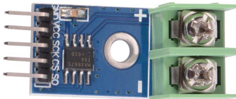
Obrázek 21 Převodníkový modul MAX6675 [33].
