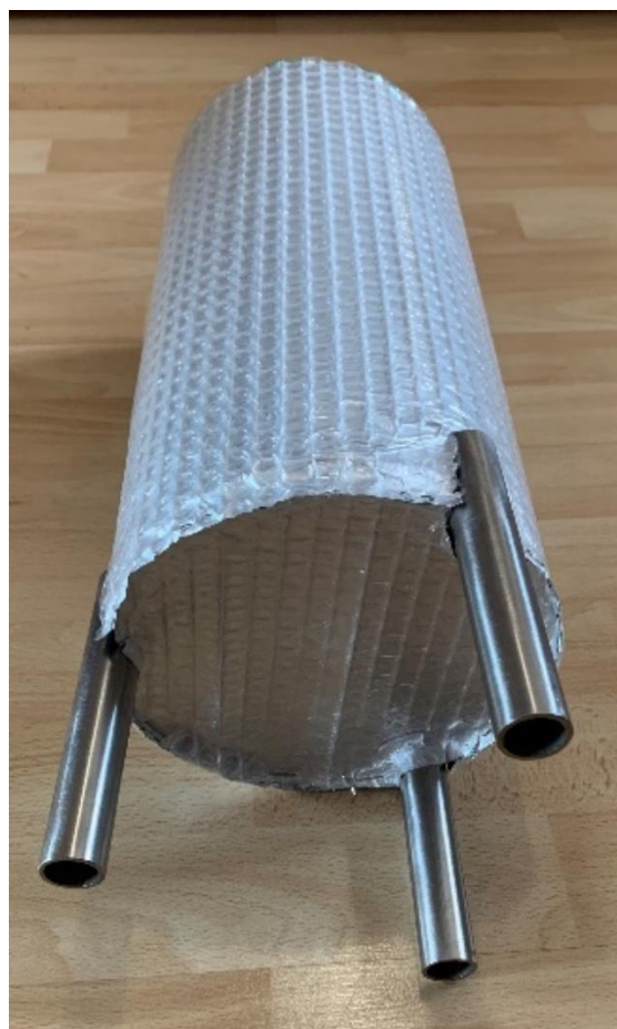
Obrázek 34 Pohled na izolaci dna akumulční nádoby
