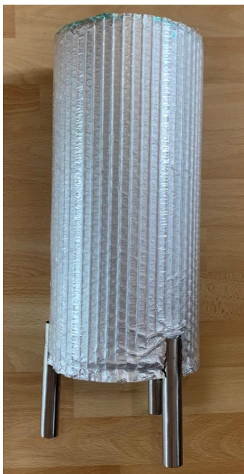
Obrázek 33 Pohled na izolaci pláště akumulční nádoby
