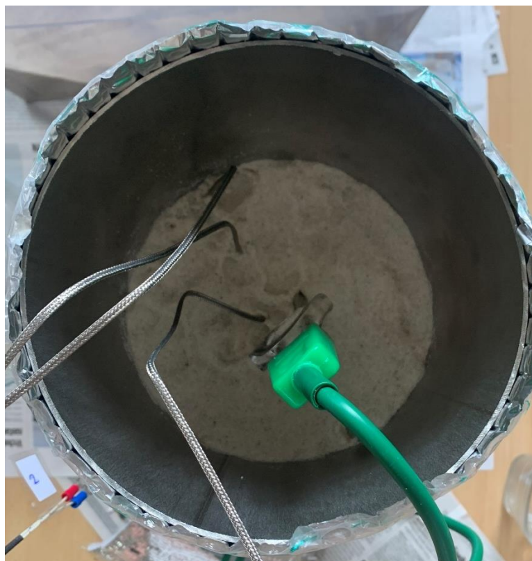
Obrázek 39 Pohled do akumulární nádoby ve fázi přípravy měření
