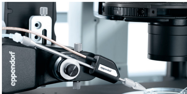
Obr. 6.5: Umístění piezoaktuátoru na držák pipety, Eppendorf PiezoXpert [2]
