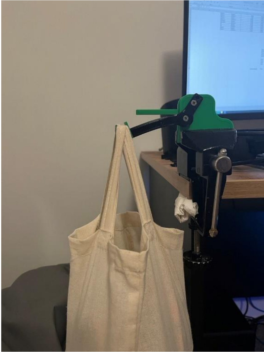
Obr. 35 Domáci testování odolnosti páčky (materiál PETG)
