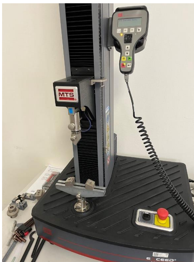
Obr. 28 Zkušební stroj MTS Exceed E42 pro zkoušku ohybem
