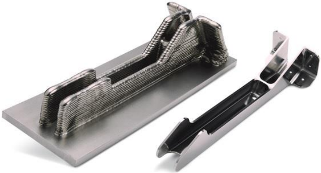
Obr. 15 Titanový díl letounu Boeing 787 vyráběný pomocí technologie RPD [46]
