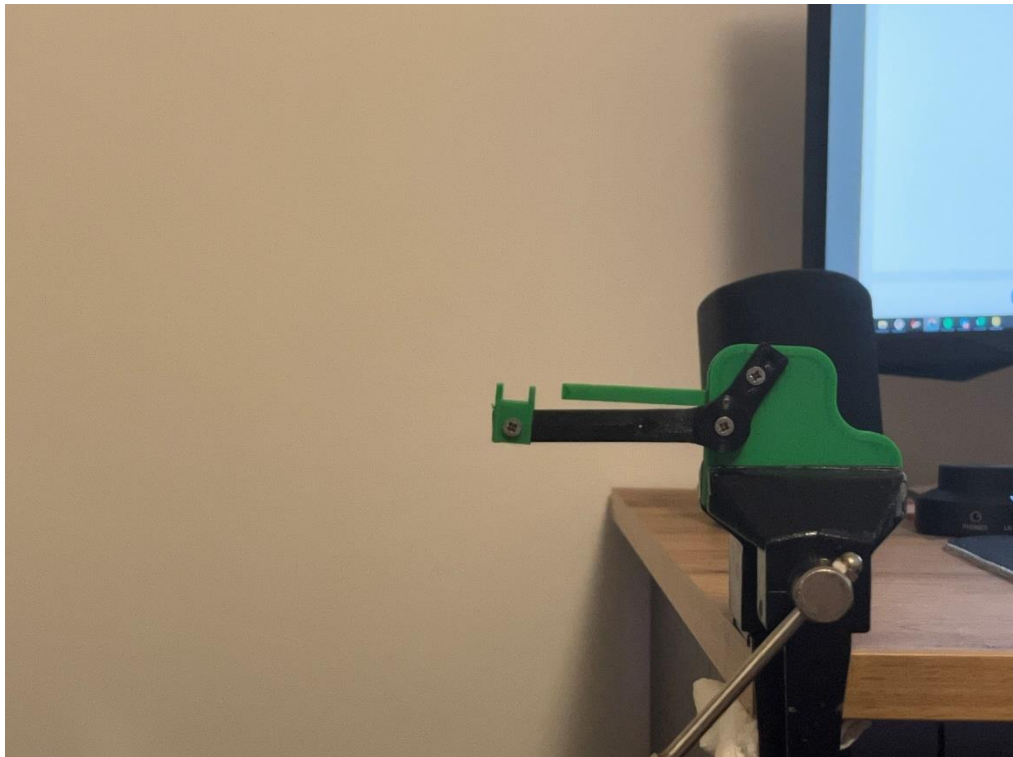
Obr. 38 Deformace vzorku (PC, plné perimetry)
