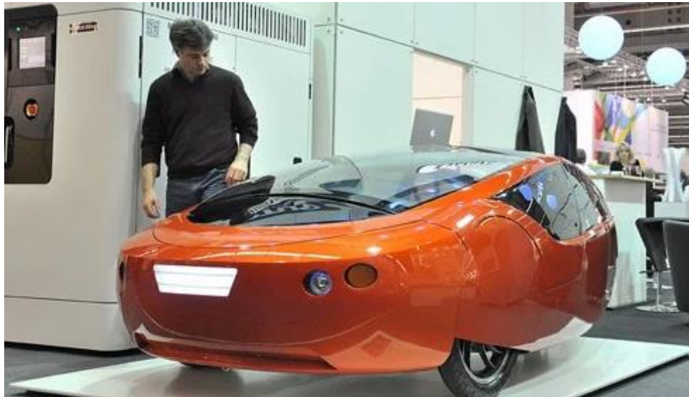
Obr. 3 Prototyp 3D tištěného vozidla Urbee [5]
