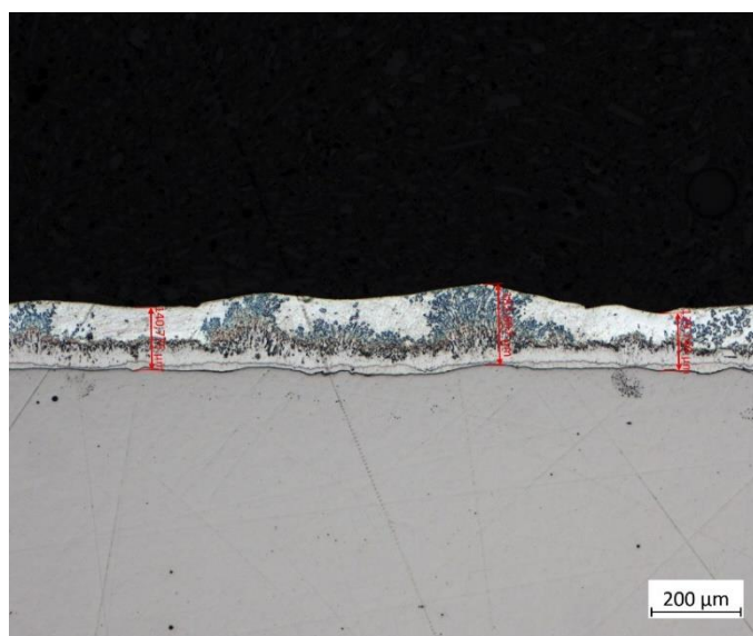
Obr. 38: Metalografický výbrus (vzorek 2.2.3-1) měření tloušťky
