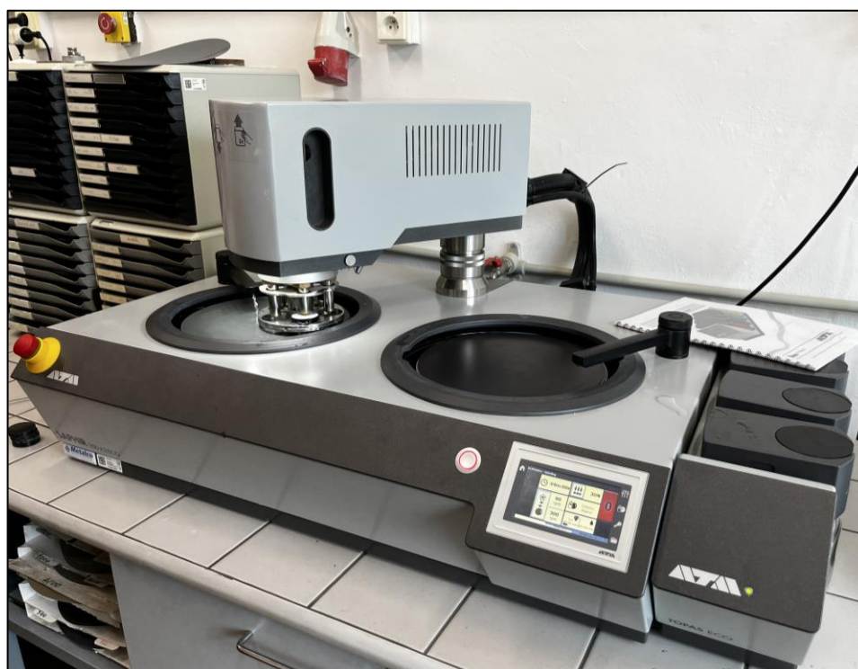
Příloha 13 – Automatická dvoukotoučová bruska a leštička SAPHIR 250 A2 – ECO (Struers) [autor práce]
