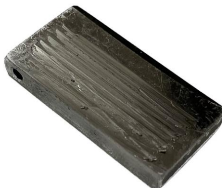
Obr. 49 – Nenapovlakovaný vzorek po provedeném měření [autor práce]
