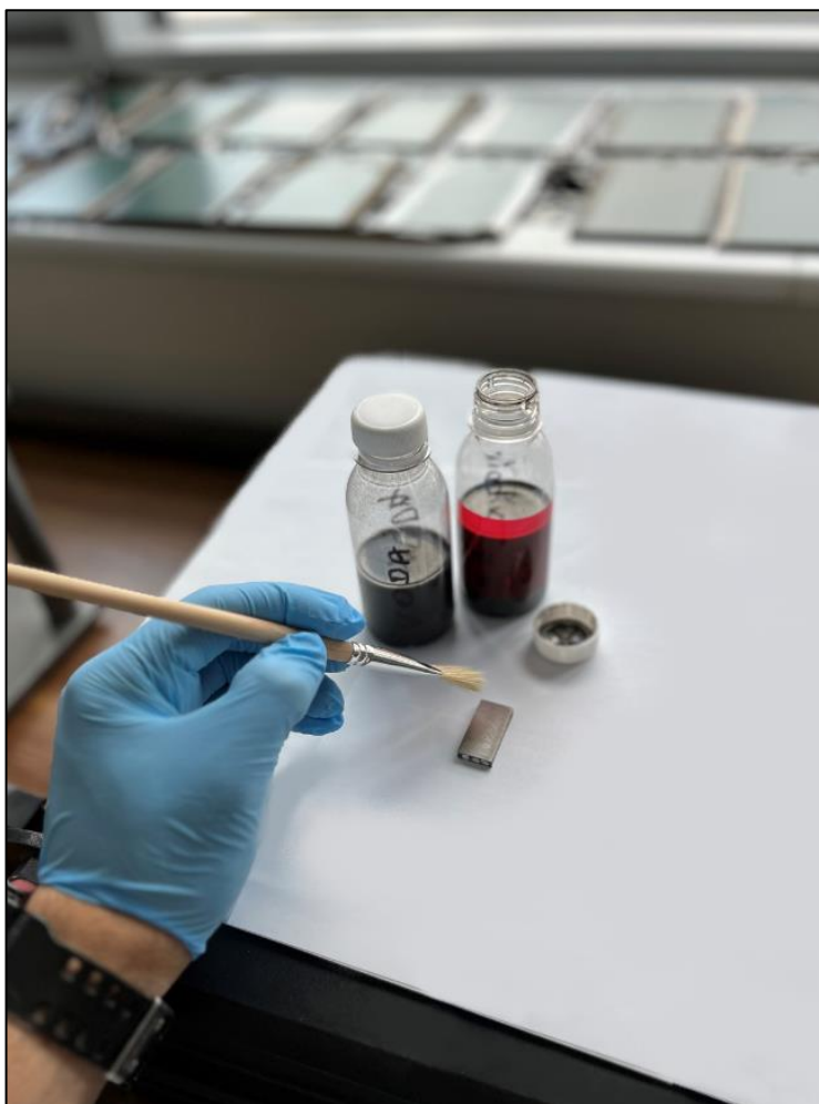
Obr. 27 – Nanášení povlaku RMA a MA štětcem [autor práce]
