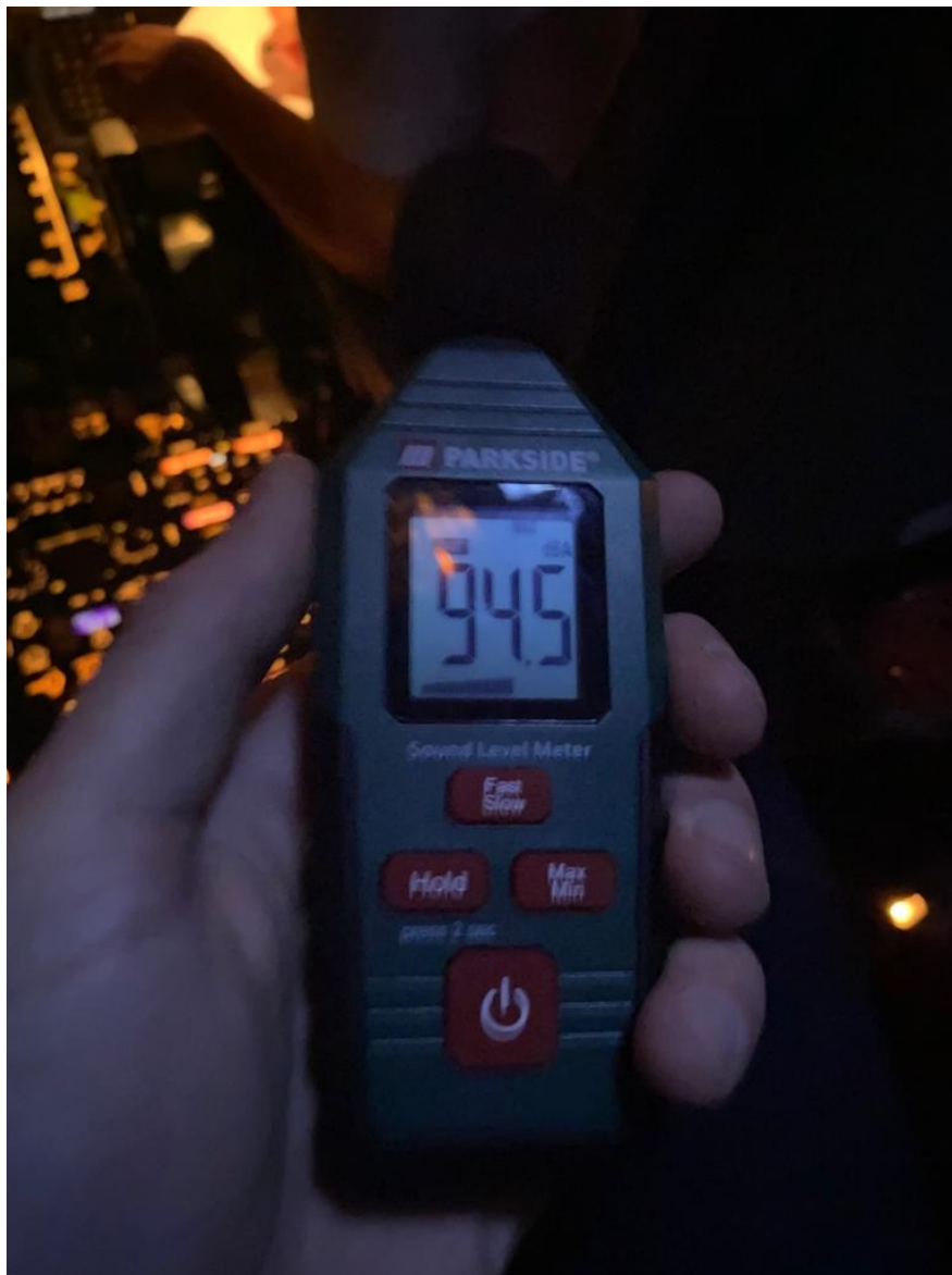
Obrázek 2.1: Ukázka měření hladiny intenzity zvuku v kokpitu letounu B737
