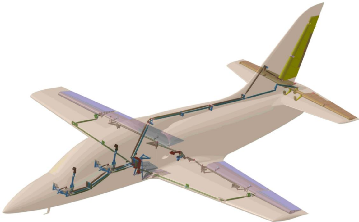
Obrázok 5 Znážornenie trás ovládania lietadla L-39 NG [10]
