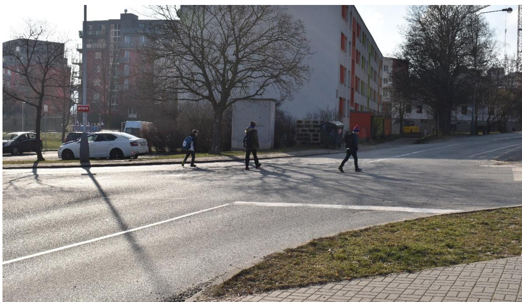
Obrázek 36 - nebezpečný pohyb chodců v prostoru křižovatky v důsledku absence přechodů pro chodce
