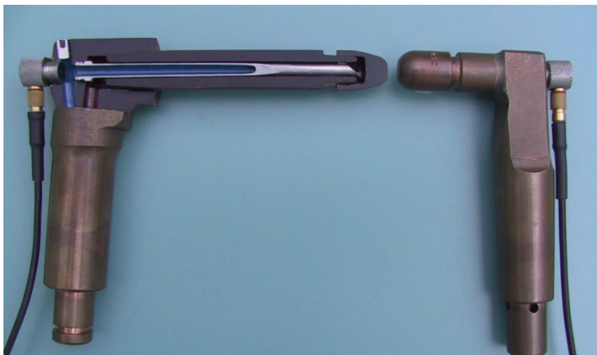
Obrázek 22: Vogt SPOTline – ultrazvukové sondy integrované do svařovacích kleští. [26]
