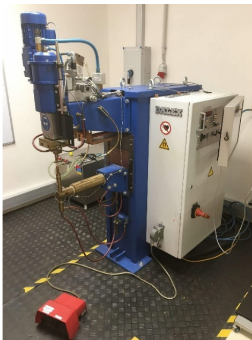
Obrázek 26: Svařovací lis DALEX PMS 11-4.
