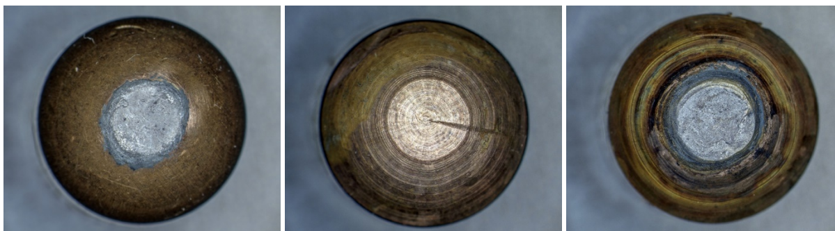
Obrázek 34: Snímky opotřebovaných čepiček. Těsně před prvním ofrézováním (vlevo). Po ofrézování (uprostřed). Opotřebovaná po posledním ofrézování (vpravo).
