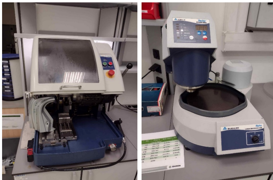
Obrázek 41: Metalografická pila Buehler AbrasiMet (vlevo) a bruska Buehler Alpha (vpravo) ve Škoda Auto a.s.
