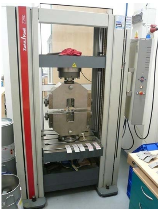
Obrázek 38: Univerzální zkušební trhací stroj ZWICK Z250 ve Škoda Auto a.s.
