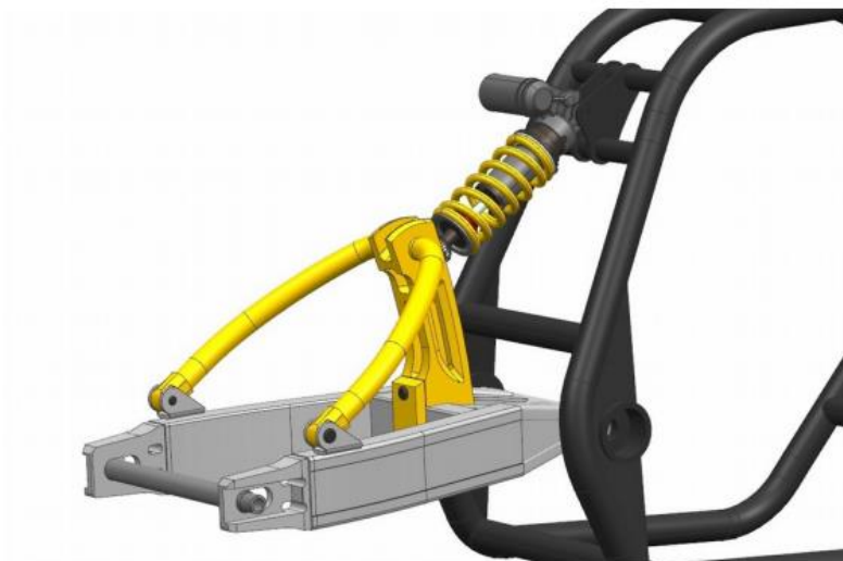
Obrázek 1.4: Zadní kyvná vidlice „Cantilever“ [5]
