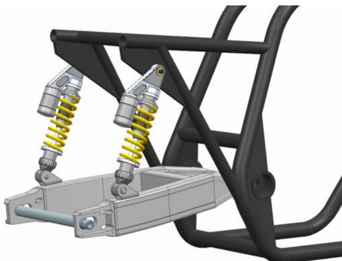
Obrázek 1.3: Konvenční dvouramenná zadní kyvná vidlice [5]
