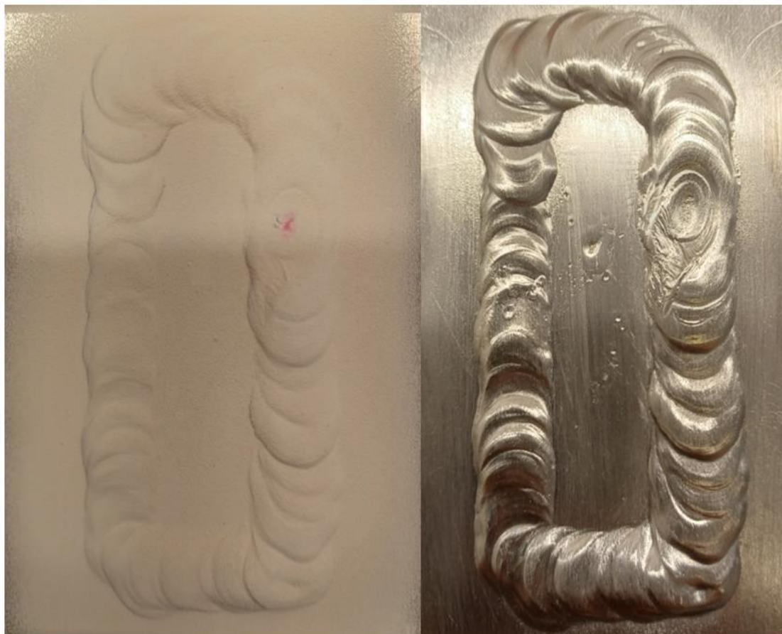
Obrázek 4.6: Kapilární zkouška - zobrazení indikace ve svaru (vlevo); svar před aplikací kapilární zkoušky (vpravo) [archiv autora]
