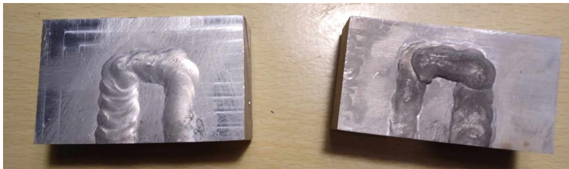
Obrázek 3.16: Nařezané vzorky pro TZ a měření tvrdosti [archiv autora]
