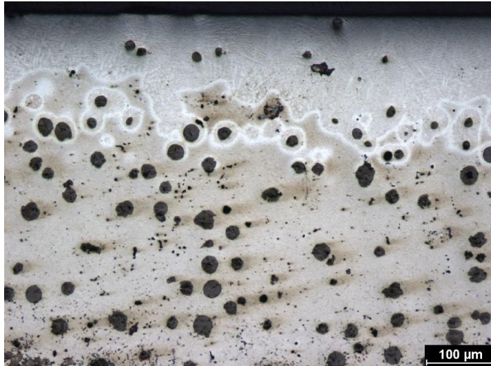
Obrázek 12 Mikrostruktura NiCu litiny v průřezu A, zvětšeno 100x
