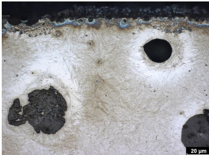
Obrázek 21 Mikrostruktura NiCu litiny v průřezu C, zvětšeno 400x
