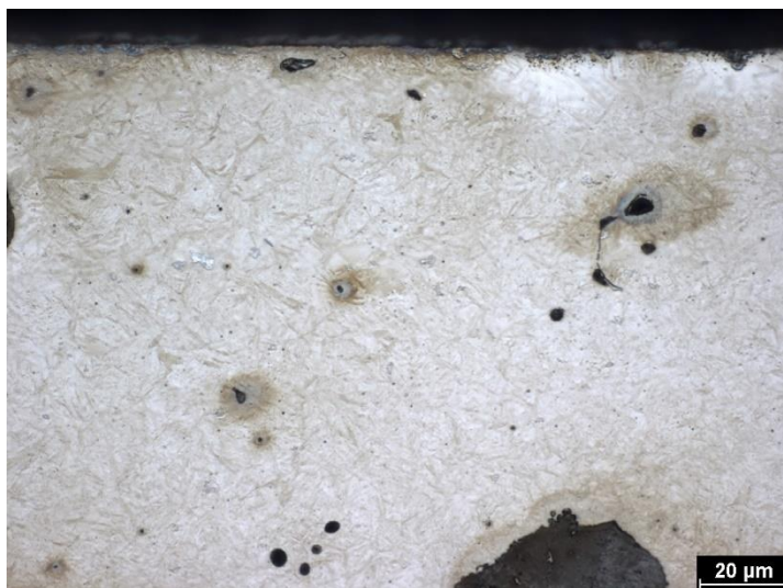
Obrázek 29 Mikrostruktura NiCu litiny v průřezu E, zvětšeno 400x
