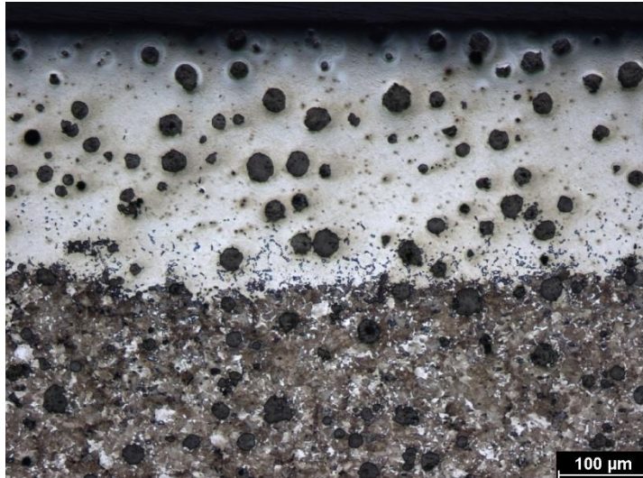
Obrázek 28 Mikrostruktura NiCu litiny v průřezu E, zvětšeno 100x
