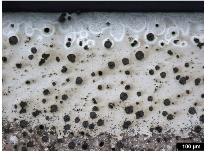
Obrázek 20 Mikrostruktura NiCu litiny v průřezu C, zvětšeno 100x
