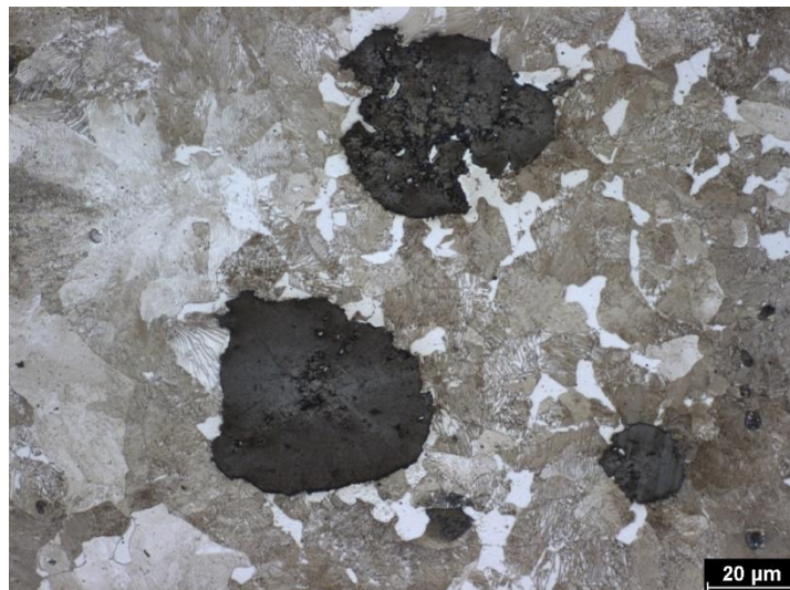
Obrázek 9 Mikrostruktura jádra NiCu litiny, zvětšeno 400x
