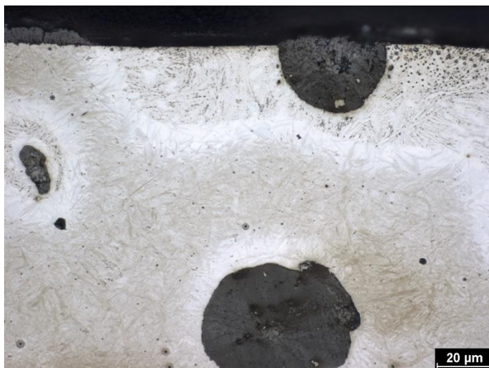
Obrázek 13 Mikrostruktura NiCu litiny v průřezu A, zvětšeno 400x
