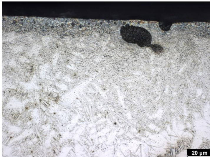
Obrázek 25 Mikrostruktura NiCu litiny v průjezdu D, zvětšeno 400x
