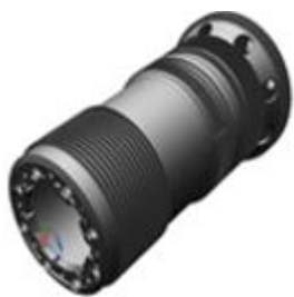
Obrázek 3 - Hlavní hřídel (Zdroj: GE Aviation)
