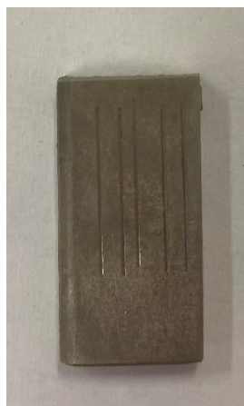
Příloha 4 Vzorek 2 pokoven lokálně, po tribologické zkoušce
