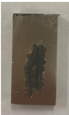
Příloha 1 Zkušební vzorek pro nastavení zkušebních parametrů pro tribologickou zkoušku
