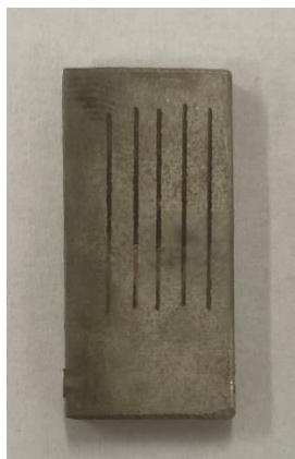
Obrázek 37 Prodřené dráhy na vzorku zhotoveného lokálně
