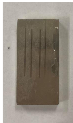
Obrázek 38 Prodřené dráhy na vzorku zhotoveného lokálně
