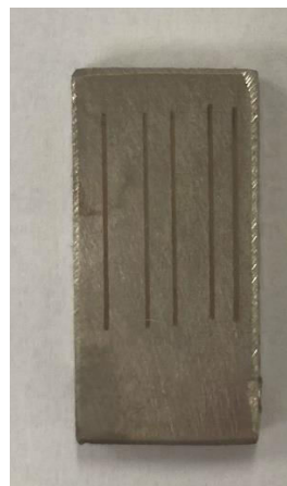
Příloha 5 Vzorek 3 pokoven lokálně, po tribologické zkoušce
