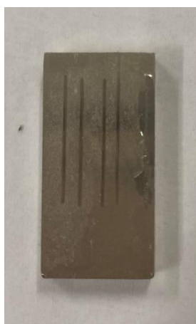
Obrázek 35 Znamky odlupování povlaku na vzorku 1
