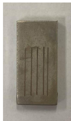
Příloha 3 Zkušební vzorek pro nastavení zkušebních parametrů pro tribologickou zkoušku
