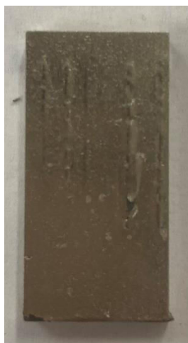
Příloha 2 Vzorek 3 pokoven ponorem, po tribologické zkoušce
