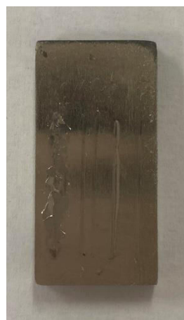
Obrázek 36 Znamky odlupování povlaku na vzorku 2
