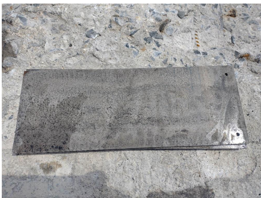
Obrázek 52 - vzorky po tryskání ultravysokotlakou vodou
