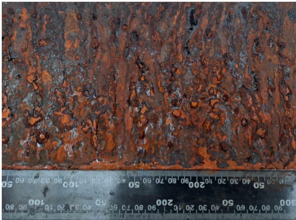
Obrázek 32 - vzorek v solné komoře po 672 hodinách
