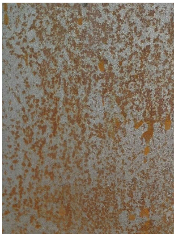
Obrázek 37 - vzorek v atmosféře po 10 dnech
