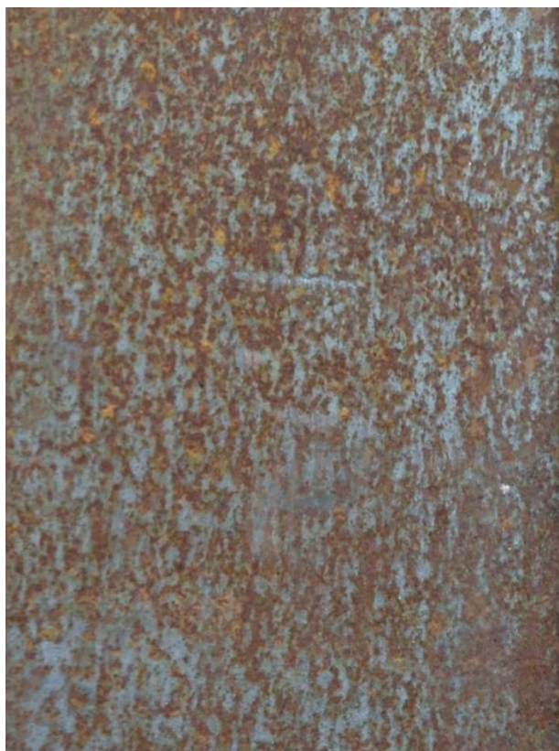
Obrázek 40 - vzorek v atmosféře po 60 dnech
