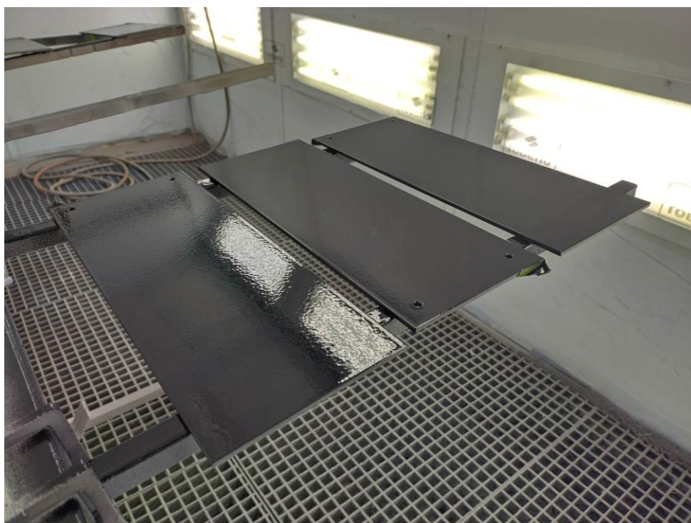
Obrázek 56 - vzorky A, D a E s naneseným nátěrem Sigmafast 210 HS
