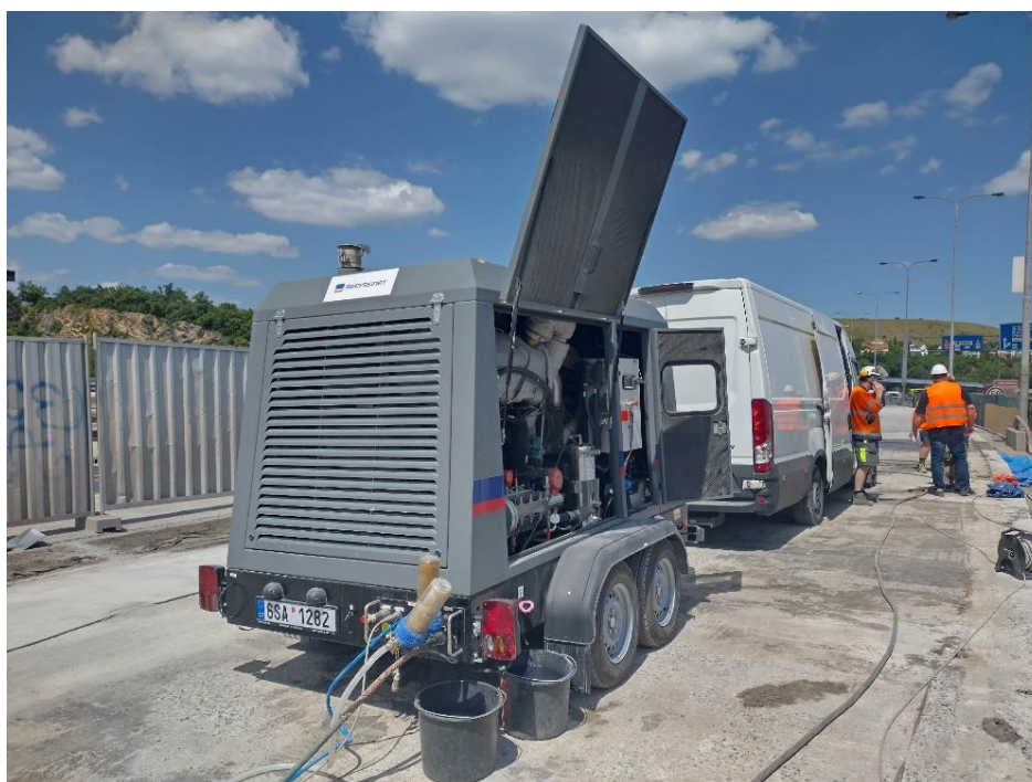
Obrázek 50 - ultravysokotlaký vodní tryskací stroj EcoMaster MK3 2500/26
