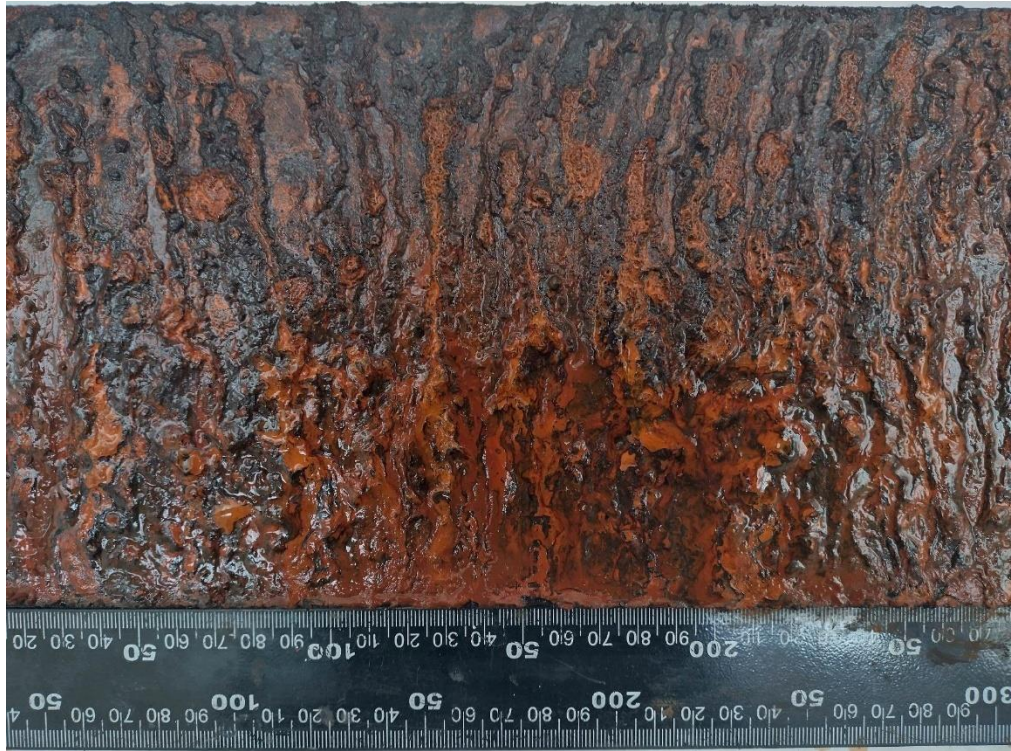
Obrázek 31 - vzorek v solné komoře po 504 hodinách
