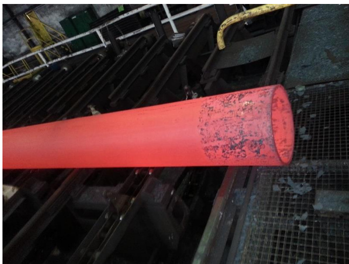
Obrázek 3 - tvorba okují na polotovaru zpracovaném za tepla [12]
