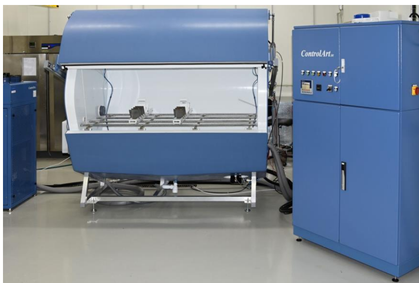
Obrázek 6 - komora pro cyklické korozní zkoušky [19]
