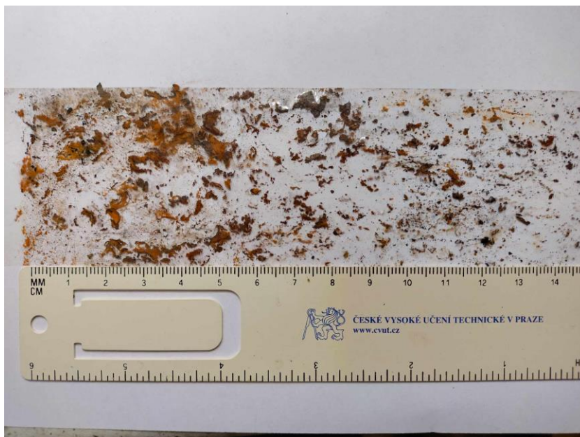
Obrázek 42 - zkouška odtržením pásky, vzorek ze solné komory
