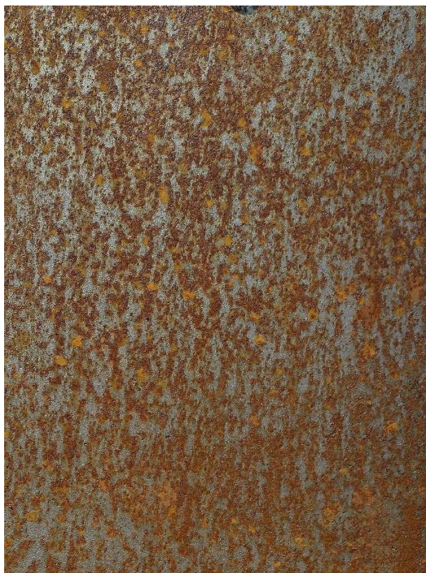
Obrázek 39 - vzorek v atmosféře po 40 dnech
