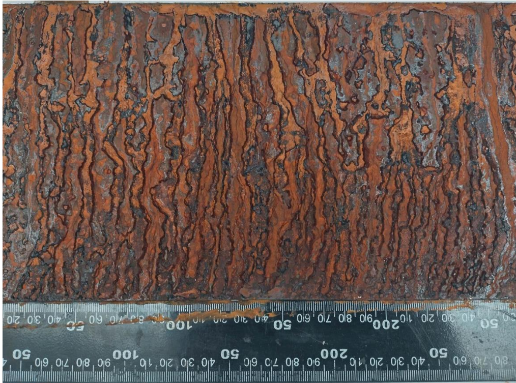
Obrázek 27 - vzorek v solné komoře po 72 hodinách
