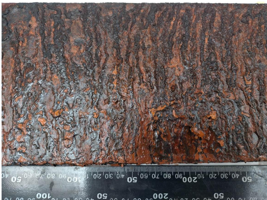
Obrázek 29 - vzorek v solné komoře po 168 hodinách
