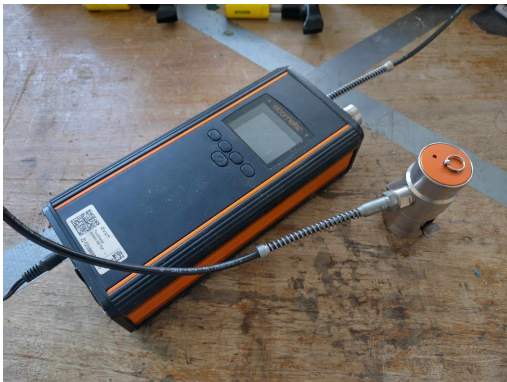
Obrázek 57 - odtrhoměr Elcometer F510-20T
