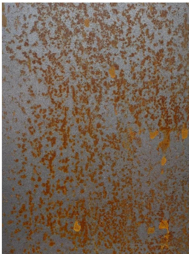
Obrázek 36 - vzorek v atmosféře po 1 dni
