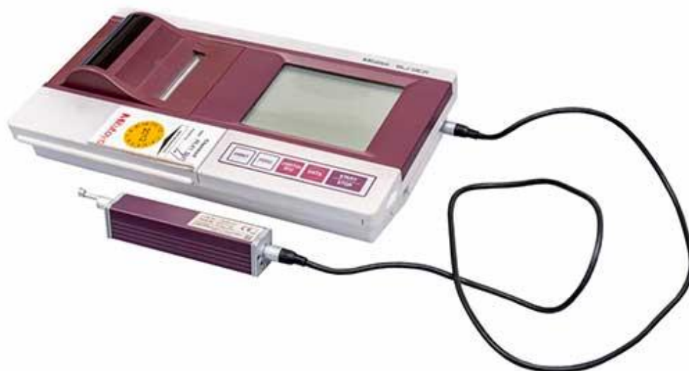
Obrázek 48 - drsnoměr Mitutoyo SJ-301 [47]
