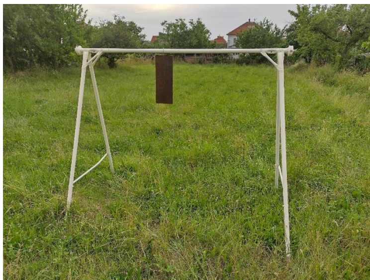
Obrázek 21 - konstrukce se zavěšeným vzorkem pro atmosférickou zkoušku
