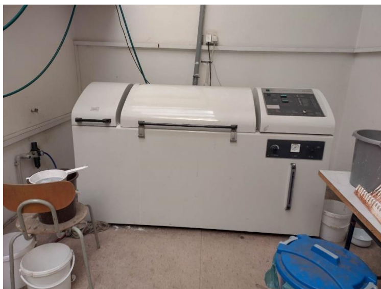
Obrázek 20 - korozní komora pro zkoušku v solné mlze
