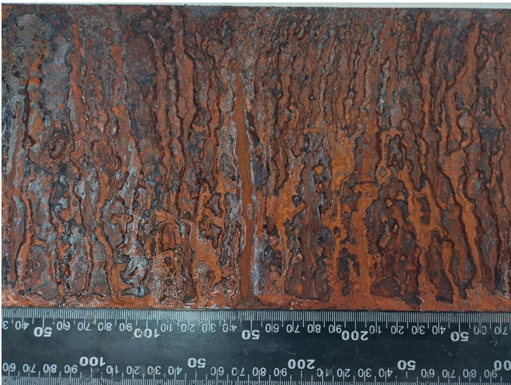
Obrázek 28 - vzorek v solné komoře po 96 hodinách
