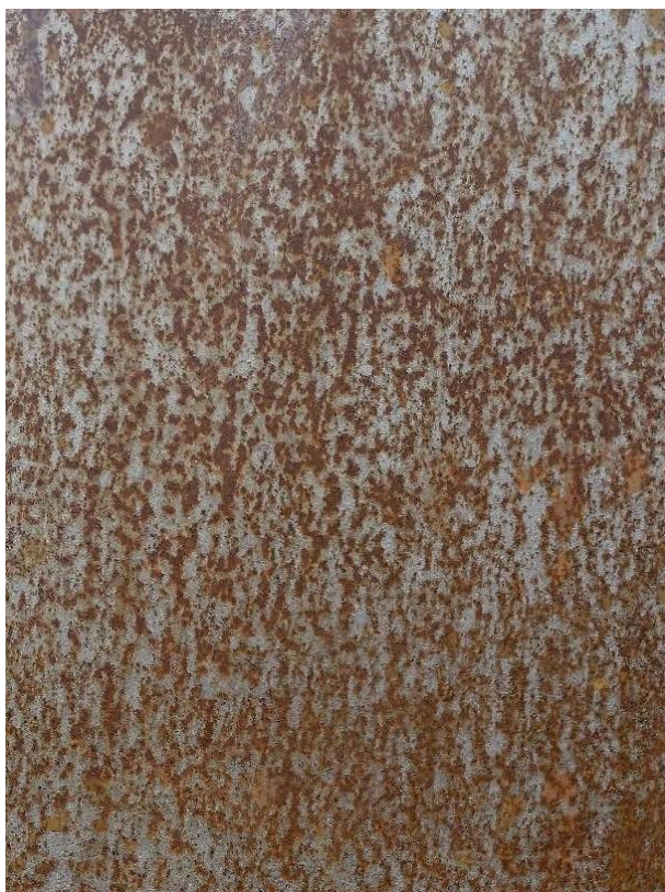
Obrázek 38 - vzorek v atmosféře po 20 dnech
