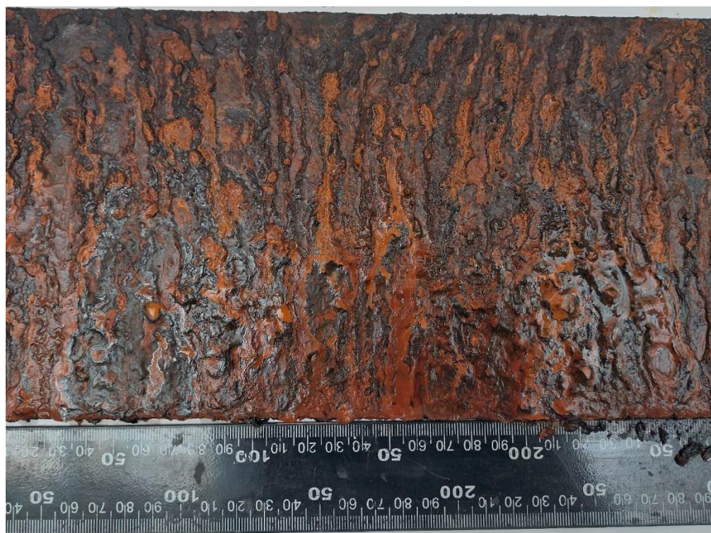
Obrázek 30 - vzorek v solné komoře po 336 hodinách
