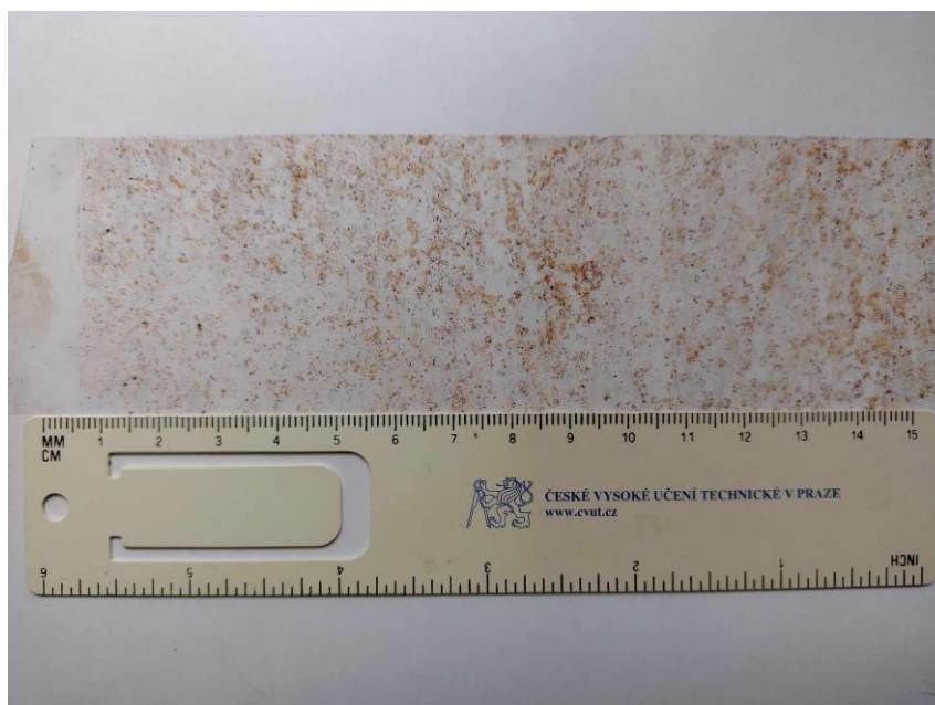
Obrázek 43 - zkouška odtržením pásky, vzorek z atmosférické zkoušky
