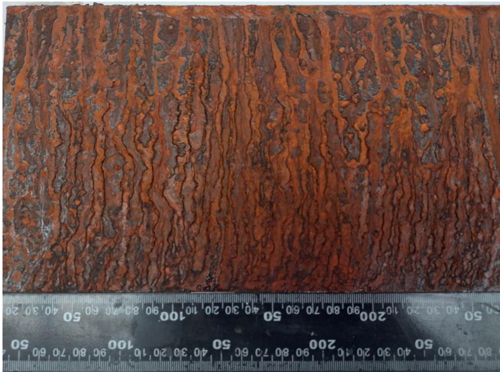
Obrázek 26 - vzorek v solné komoře po 48 hodinách
