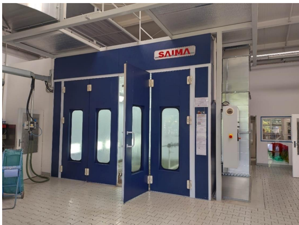
Obrázek 53 - stříkací box Saima s filtrací a vytápěním
