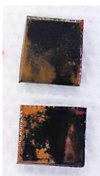
Obr. 21: Stav plíšků korodovaných v 5% NaCl po vyjmutí z roztoku (nahore po 1 týdnu, dole po 2 týdnech).
