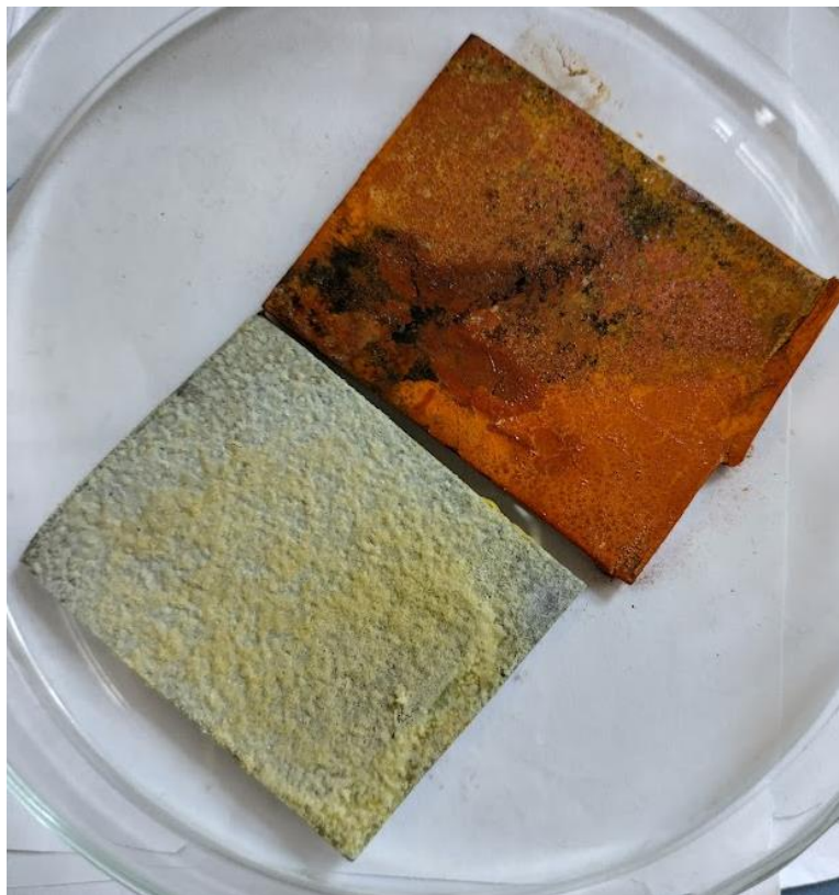
Obr. 27: Stav plíšků z oceli B korodovaných v parách HCl (vlevo) a v 5% roztoku NaCl (vpravo) po vyjmutí a osušení.
