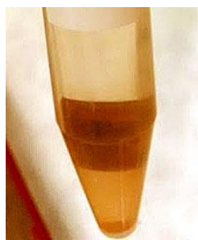
Obr. 20: Stav plíšku č. 1 v 5% NaCl po 2 týdnech.
