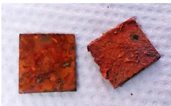
Obr. 17: Elektrochemicky zkorodované plíšky.
