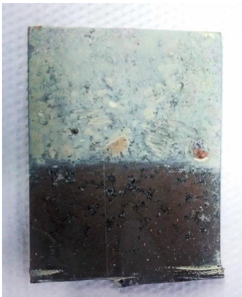
Obr. 39: Plíšek po vysušení a očištění poloviny povrchu.
