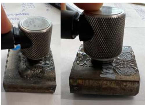
Obrázek 32 Měření návaru z vrchní strany a) a ze spodní strany b)
