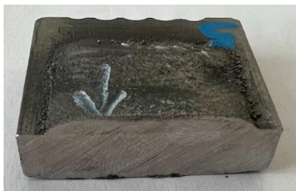
Obrázek 25 Inconel 625 – niklový návar s příměsí bóru
