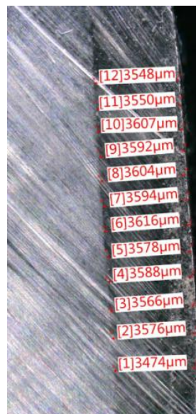
Obrázek 47 Rozměry vzorku s návarem
