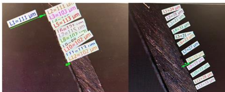
Obrázek 34 Rozměry bílého smaltu a) a rozměry černého smaltu b)
