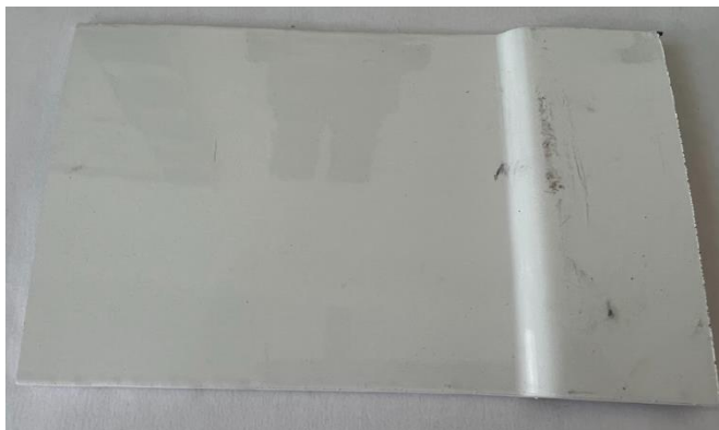
Obrázek 21 Bílý práškový plast na oceli s chemickou předúpravou povrchu
