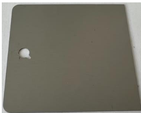
Obrázek 22 Anodická oxidace na slitině hliníku
