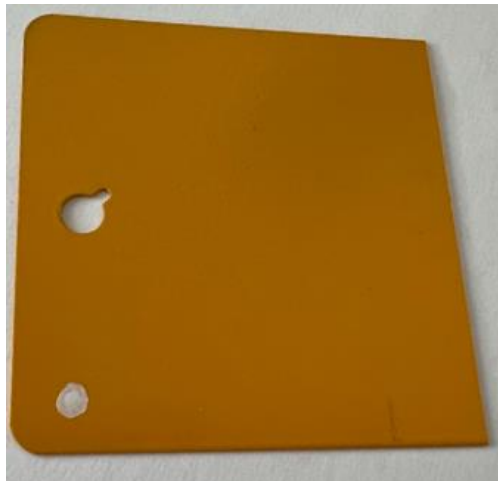
Obrázek 23 Žlutý práškový plast na slitině hliníku
