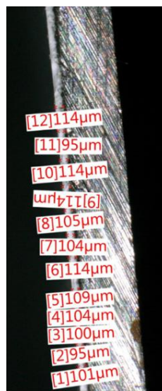
Obrázek 46 Rozměry smaltovaného vzorku
