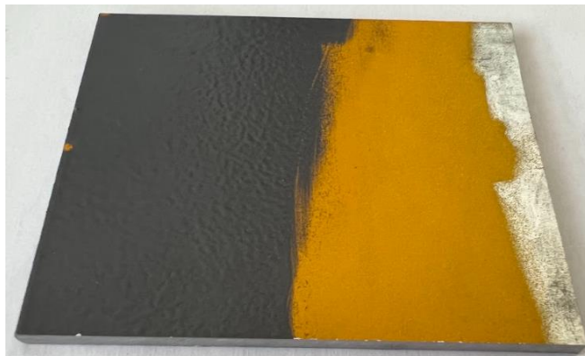
Obrázek 24 Duplexní povlak (žárový zinek a dvojitý povlak z práškového plastu) na oceli
