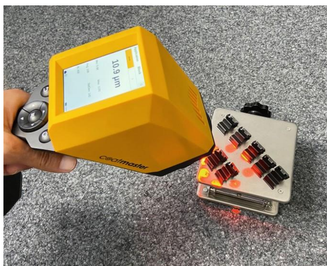
Obrázek 12 Reálný příklad měření tloušťky povlaku [18]
