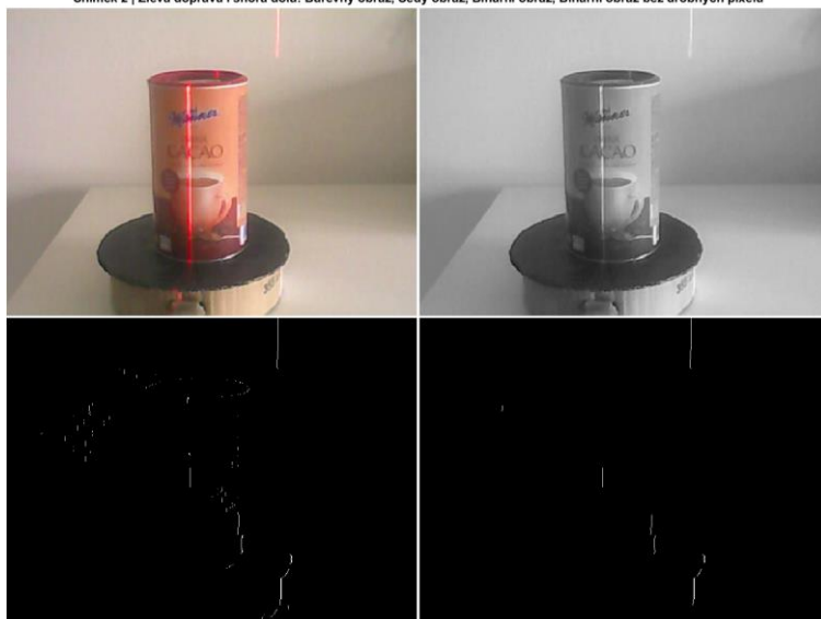
Snímek 3 | Zleva doprava i shora dolů: Barevný obraz, Šedý obraz, Binární obraz, Binární obraz bez drobných pixelů
