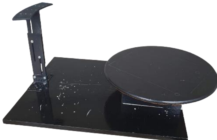
Obr. 12 – Původní konstrukce: železný stojan (zleva) a otočný stolek (zprava) [autor]
