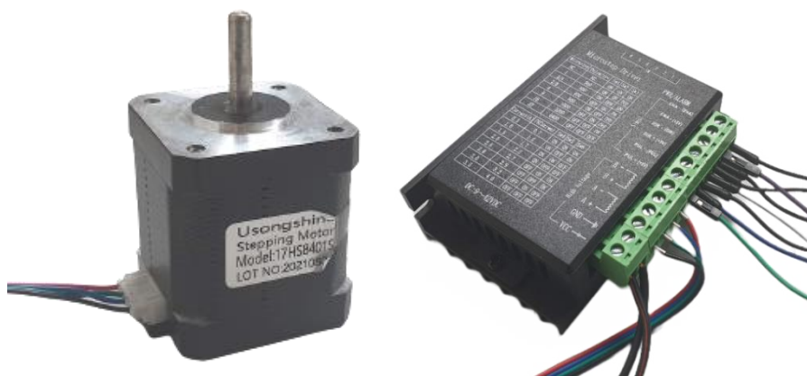
Obr. 15 – Krokový motor (zleva) a driver (zprava) [autor]
