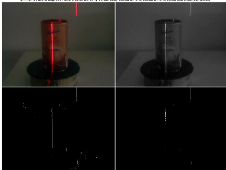
Snímek 5 | Zleva doprava i shora dolů: Barevný obraz, Šedý obraz, Binární obraz, Binární obraz bez drobných pixelů
