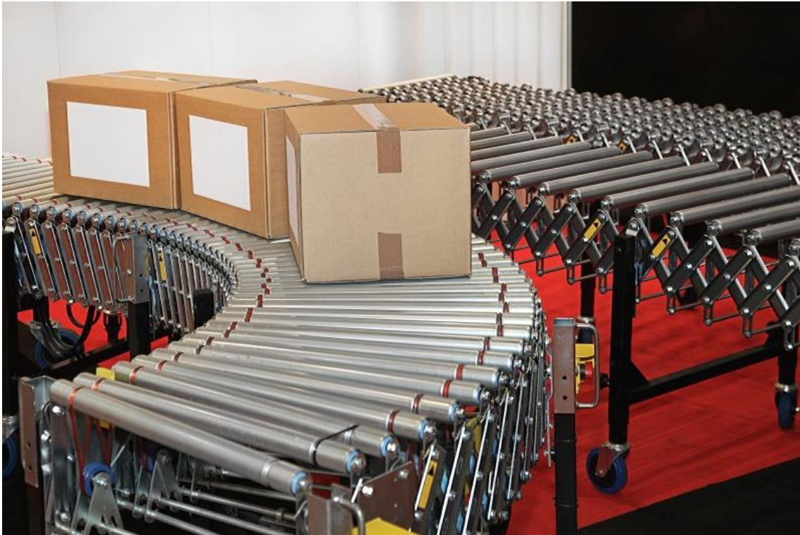
Obr. 13 Teleskopická válečková dráha do zatáčky, v pozadí nepoháněná teleskopická válečková dráha [10]
