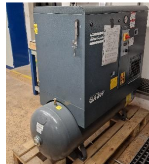
Obr. 88 Šroubový kompresor ATLAS COPCO GX3FF [Autor]
