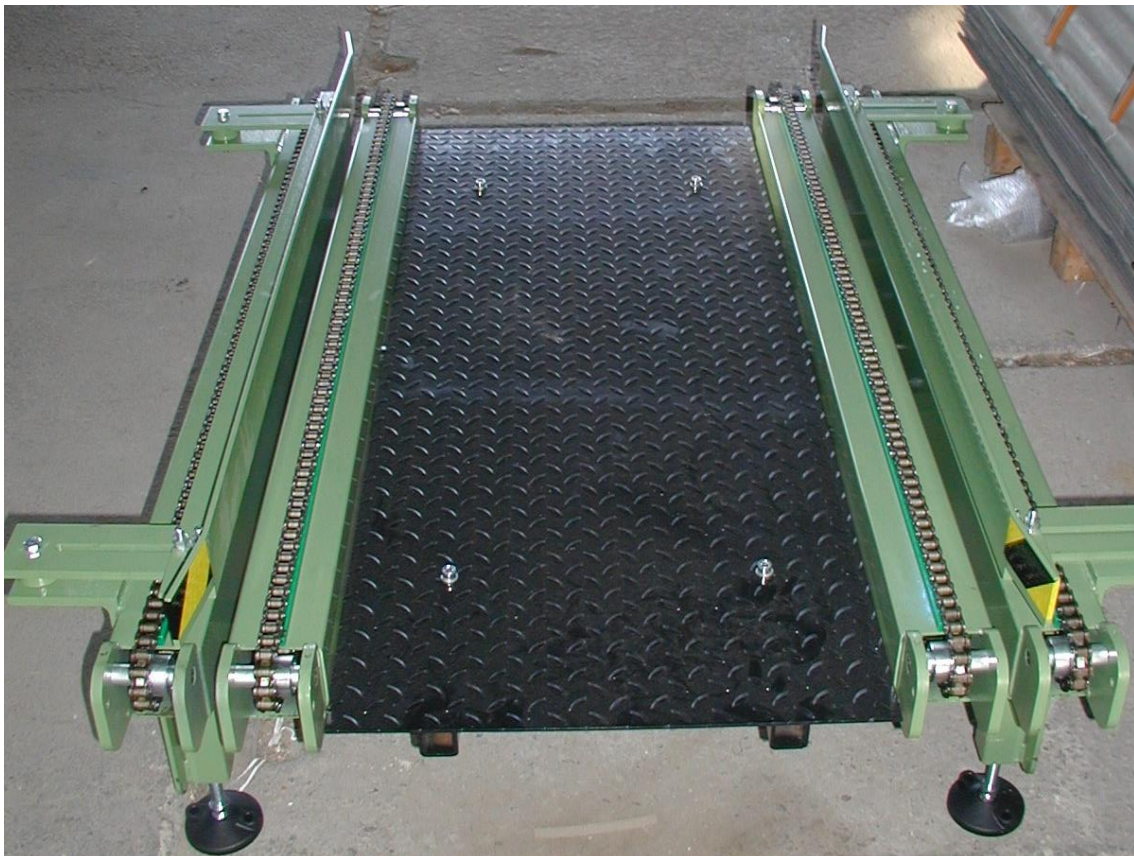
Obr. 111 Řetězový dopravník s nastavitelnou šířkou dopravované palety [Autor]
