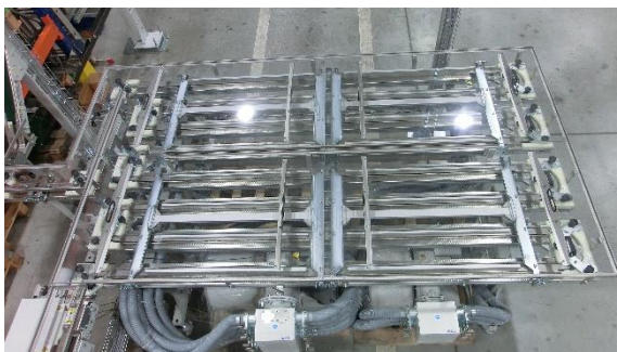
Obr. 61 Jet operační mezizásobník ocelových vík [Autor]
