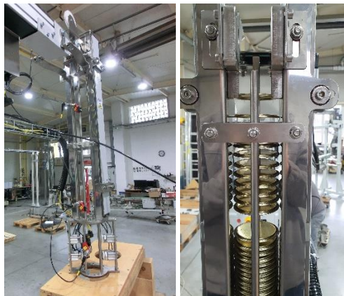
Obr. 52 Obr. 53 Magnetický stohovač vík „magazín“ [Autor]
