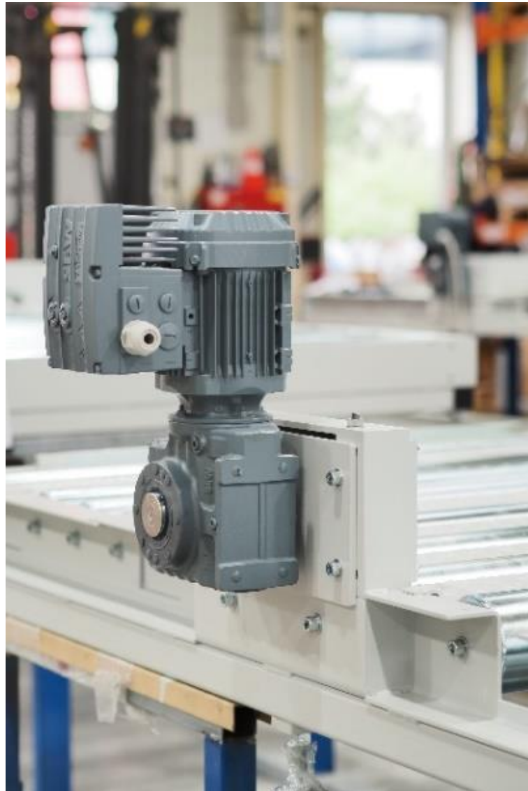
Obr. 10 Pohonná jednotka válečkové tratě s elektropřevodovkou SEW Eurodrive [Autor]
