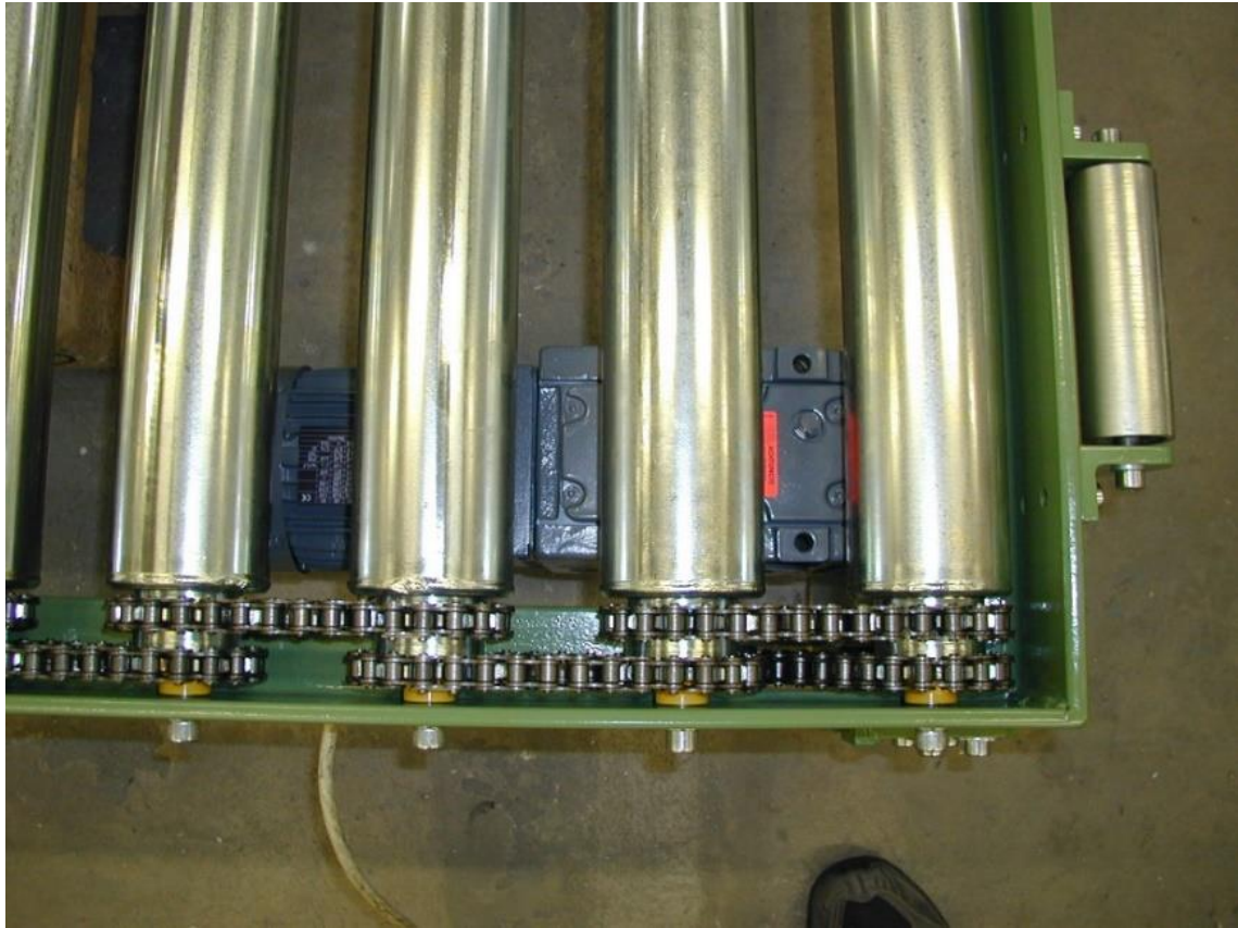
Obr. 11 Pohon systémem propojených sousedních válečků [Autor]
