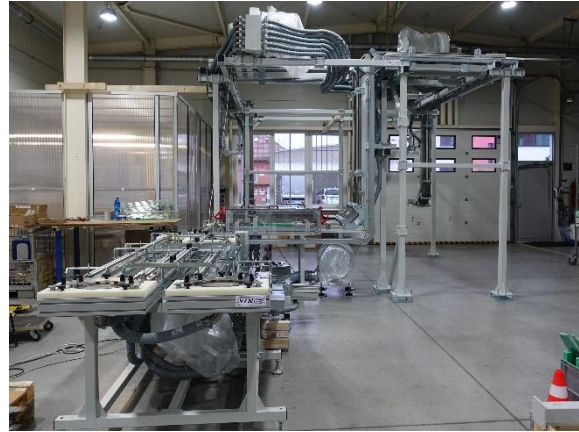
Obr. 64 JET dopravní linka pro papírové kroužky včetně výhybky, dvou svislých elevátorů a dvou svislých deelevátorů [Autor]
