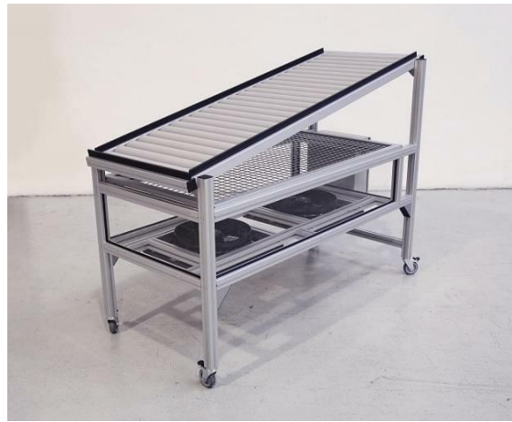
Obr. 41 Gravitační válečková dráha [4]
