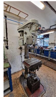
Obr. 80 Sloupová vrtačka PRŮMYSLOVÝ KOMBINÁT DAČICE VS32A [Autor]
