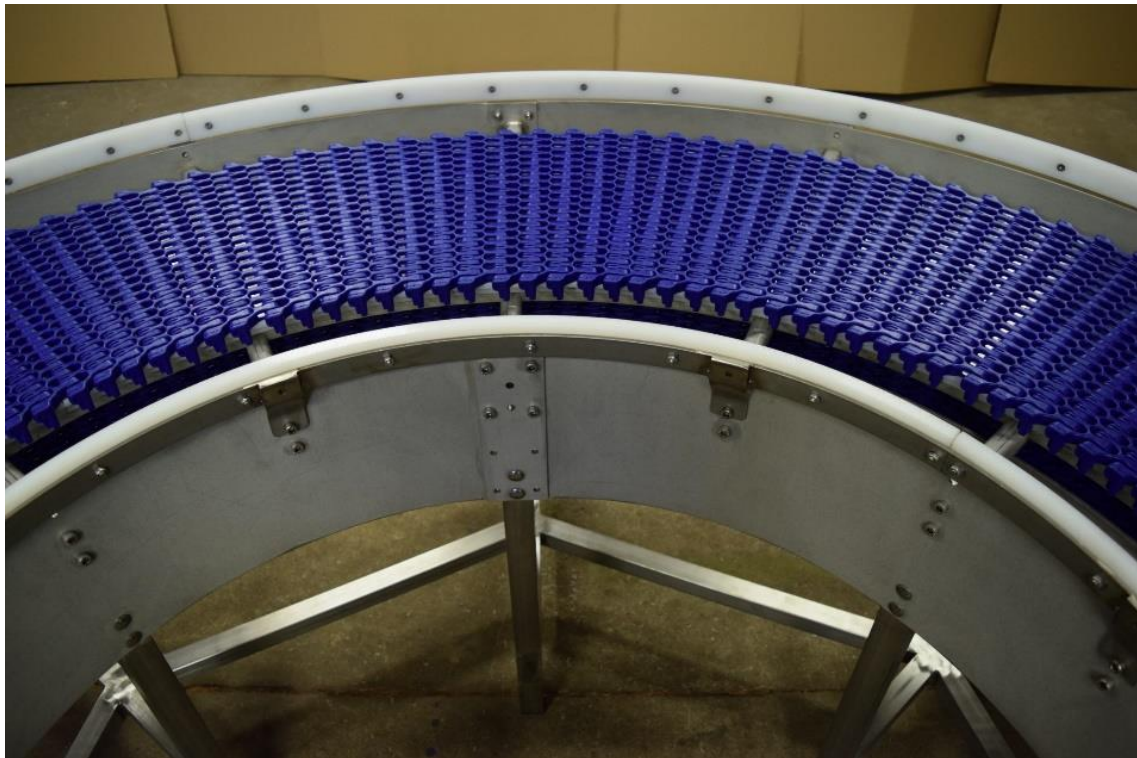
Obr. 33 Modulární dopravník – zatáčka [21]
