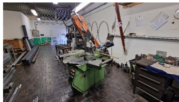
Obr. 68 Pásová pila ve skladu hutního materiálu FMB MAJOR [Autor]
