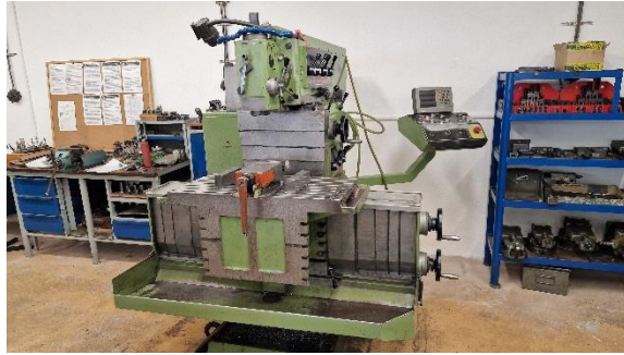
Obr. 77 Frézka s elektronickým odečítáním TOS Čelákovice FNGJ 32 [Autor]
