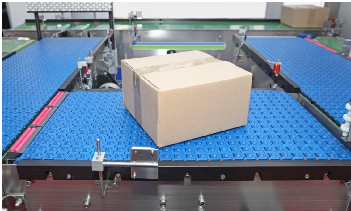
Obr. 24 Modulární trať s kuličkovým modulárním pásem [10]
