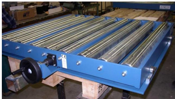
Obr. 46 Válečková dráha s příčným posuvem [Autor]
