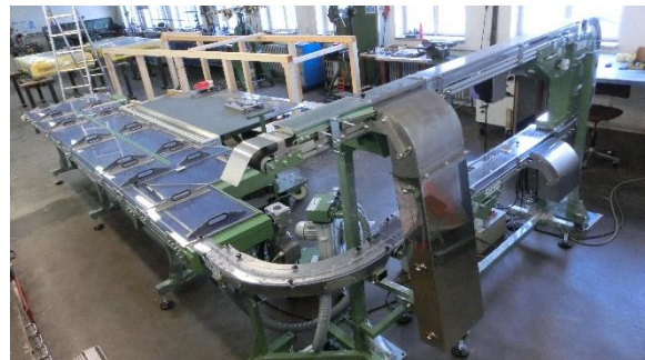
Obr. 47 Zásobní stůl s modulárním pásem, JET zatáčkou a navazující vakuovou dopravou [Autor]
