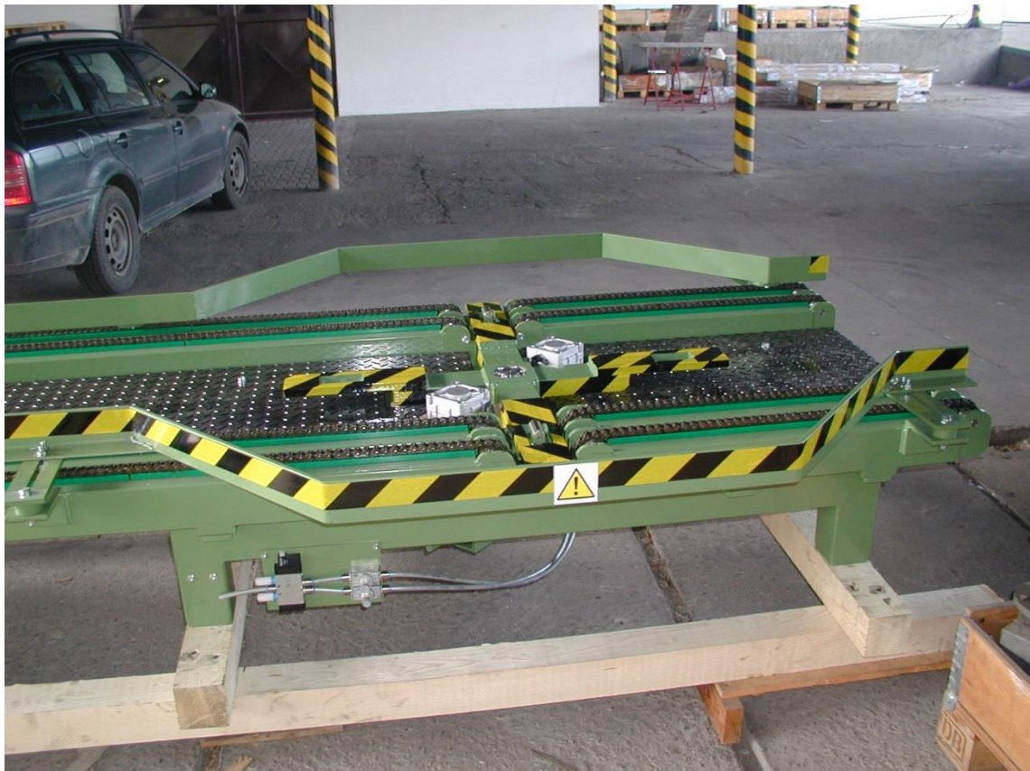
Obr. 15 Řetězová trať s válečkovým řetězem se svařovanou konstrukcí z jechlů a točnou [Autor]
