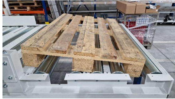
Obr. 110 Doprava palety v příčném směru [Autor]
