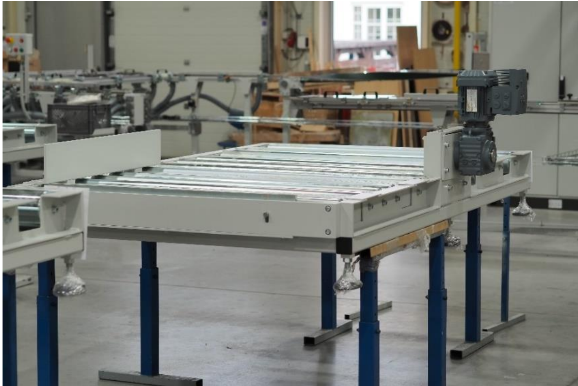
Obr. 5 Válečková dráha svařovaná z laserem opracovaných plechů a U normalizovaných profilů [Autor]
