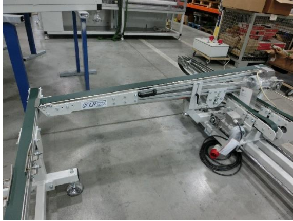
Obr. 44 Magnetický pásový dopravník [Autor]
