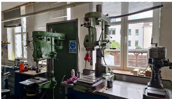
Obr. 91 Sloupové vrtačky zleva: JIHOKOV HUSTOPEČE V 10, TOS SVITAVY V 20 A, TOS VS 20 [Autor]
