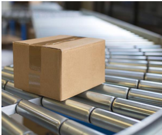
Obr. 40 Nepoháněná válečková dráha [25]
