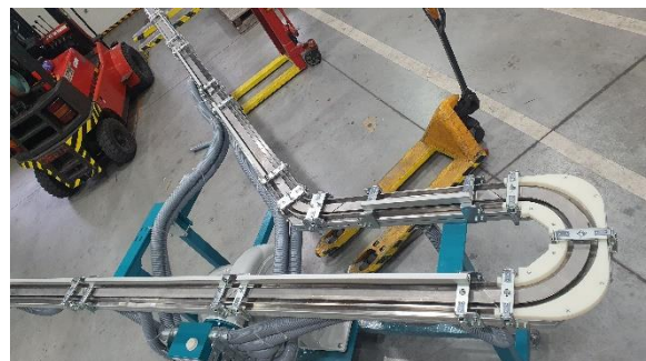
Obr. 62 Jet doprava plastových vík [Autor]
