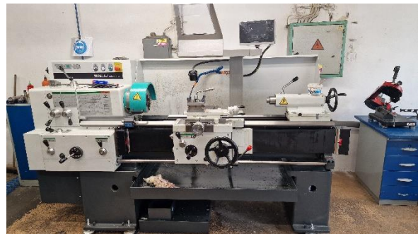
Obr. 82 Soustruh s elektronickým odečítáním TRENŠ SN32/1000 [Autor]
