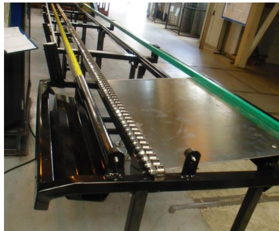
Obr. 43 Gravitační dopravník s ložiskovou lištou [25]
