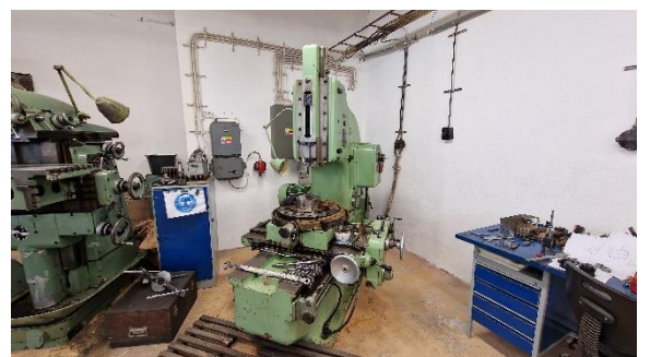
Obr. 76 Vertikální obrážečka MAS Kovosvit HOV25 [Autor]
