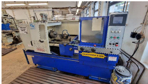
Obr. 81 NC Soustruh PINACHO SMARTTURN 5/200 [Autor]
