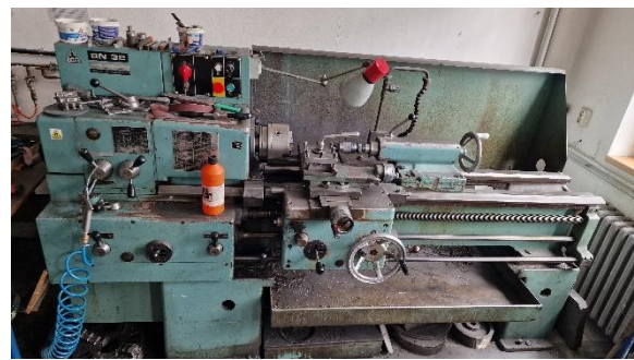
Obr. 95 Soustruh s vyjímatelným ložem pro velké průměry TOS Trenčín SN 32 [Autor]
