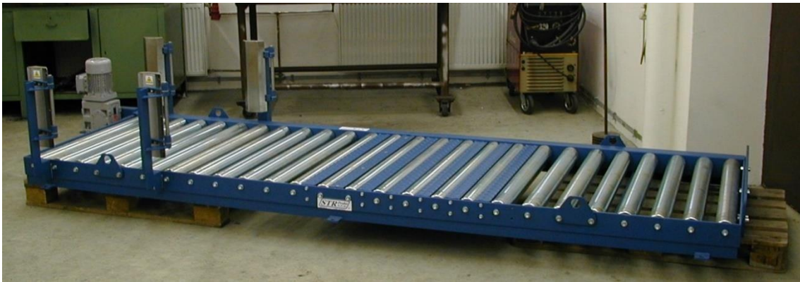
Obr. 3 Válečková dráha s rozdělovacími magnety plechů [Autor]
