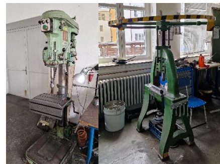
Obr. 92 Sloupová vrtačka PRŮMYSLOVÝ KOMBINÁT DAČICE VS 32 A a Obr. 93 šroubový lis STROJÁREŇ PIESOK LRD16/360 [Autor]
