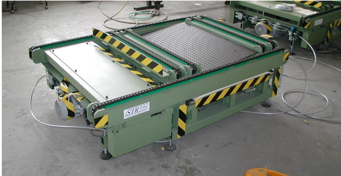
Obr. 112 Přejezd mezi řetězovými dopravníky – zdvihnutí kolmé části pomocí měchů [Autor]
