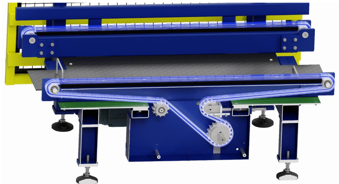
Obr. 128 Vedení řetězu v řetězové trati [Autor]
