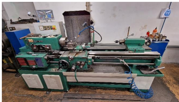
Obr. 83 Soustruh s elektronickým odečítáním STAP SV 18 RD [Autor]
