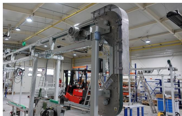
Obr. 56 G magnetický elevátor [Autor]
