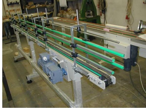
Obr. 45 Řetězový dopravník pro pláště aerosolových plechovek [Autor]
