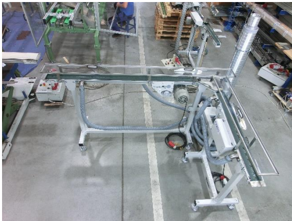
Obr. 59 Vakuový pásový dopravník [Autor]
