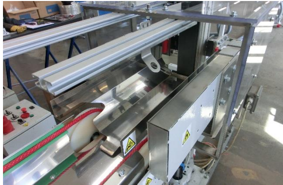
Obr. 50 Magnetický odstohovač vík [Autor]
