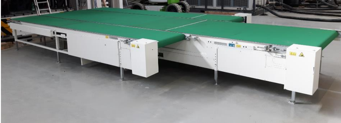
Obr. 34 Pásová dopravní trať na kusový materiál [22]
