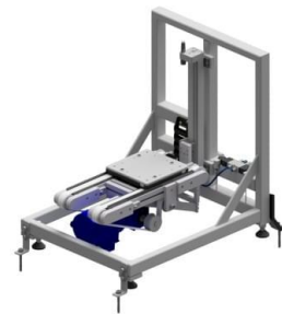
Obr. 39 Zvedací jednotka (výtah) [24]
