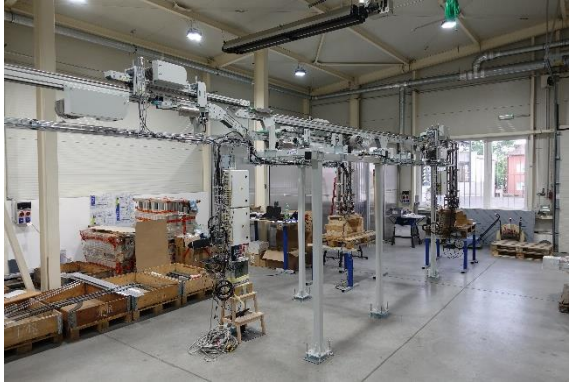
Obr. 57 Rozdělování dopravovaných vík do více proudů [Autor]
