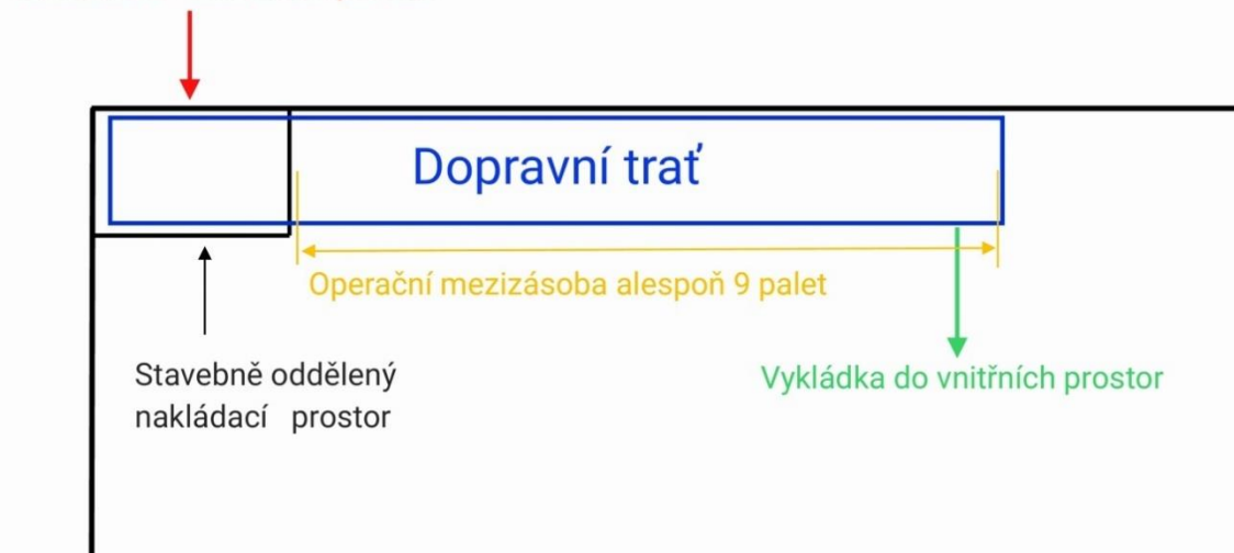
Obr. 1 Skica prostorového rozložení navrhované dopravní tratě [Autor]
