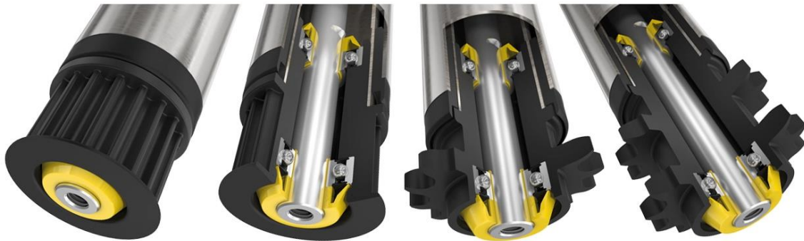
Obr. 8 Válečky s třecím elementem pro tvorbu mezioperační zásoby [7]
