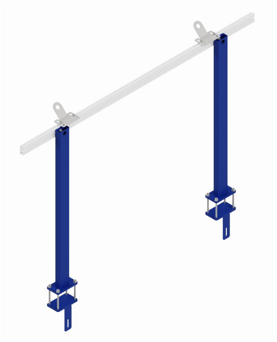
Obr. 116 Konstrukce držáků senzorů [Autor]
