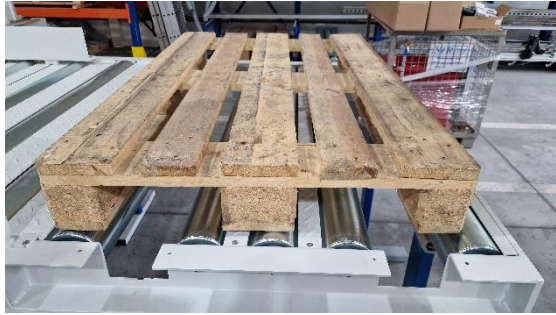
Obr. 109 Doprava palety v příčném směru [Autor]
