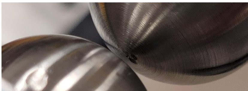
Obrázek 52: Detail poškozené elektrody
