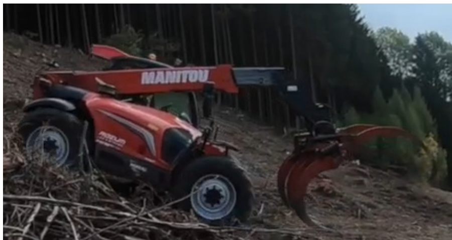
Obr. 3.2.3 – Pružinově jištěný shrnovač na manipulátoru při práci [7]
