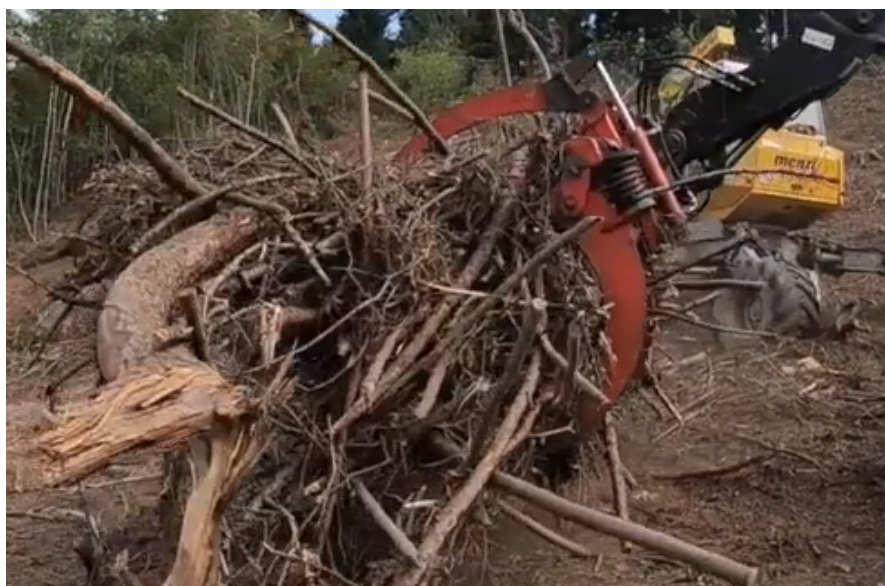
Obr. 3.2.4 – Pružinově jištěný shrnovač na manipulátoru při práci – detailní pohled [7]
