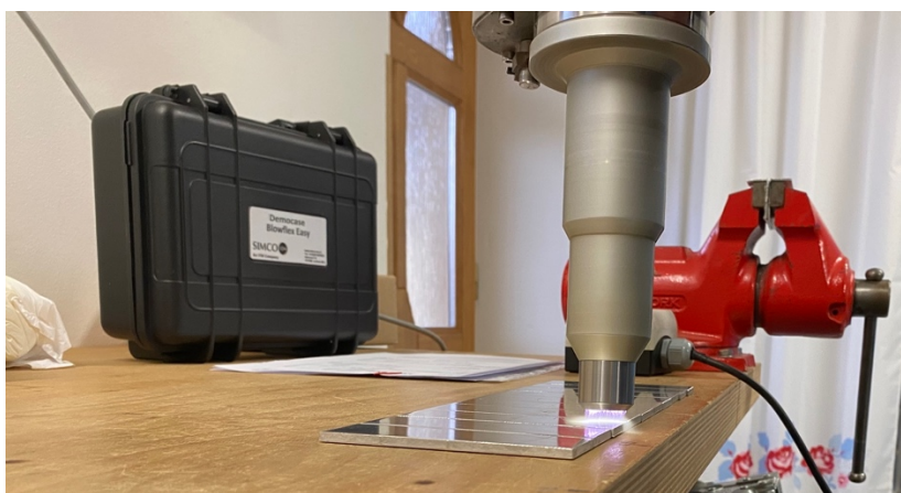
Obr. 25 Proces čištění plazmou
