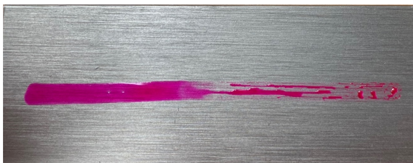
Obr. 9 Testovací inkoust na vzorku. Vlevo je odmaštěný materiál (inkoust tvoří souvislou vrstvu), vpravo je mastný povrch (inkoust tvoří kapičky, není slitý)
