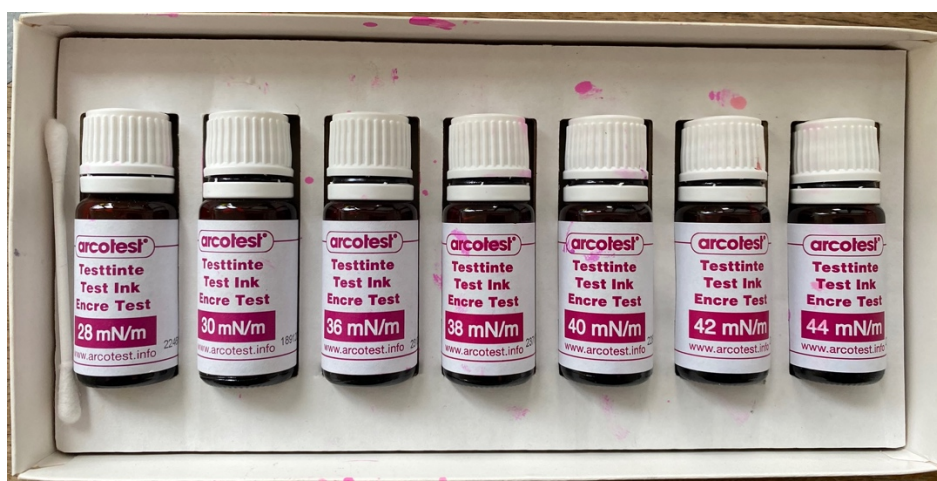
Obr. 42 Inkousty Arcotest pro zkoušku smáčivosti povrchu
