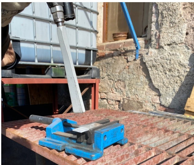
Obr. 32 Proces tryskání suchým ledem
