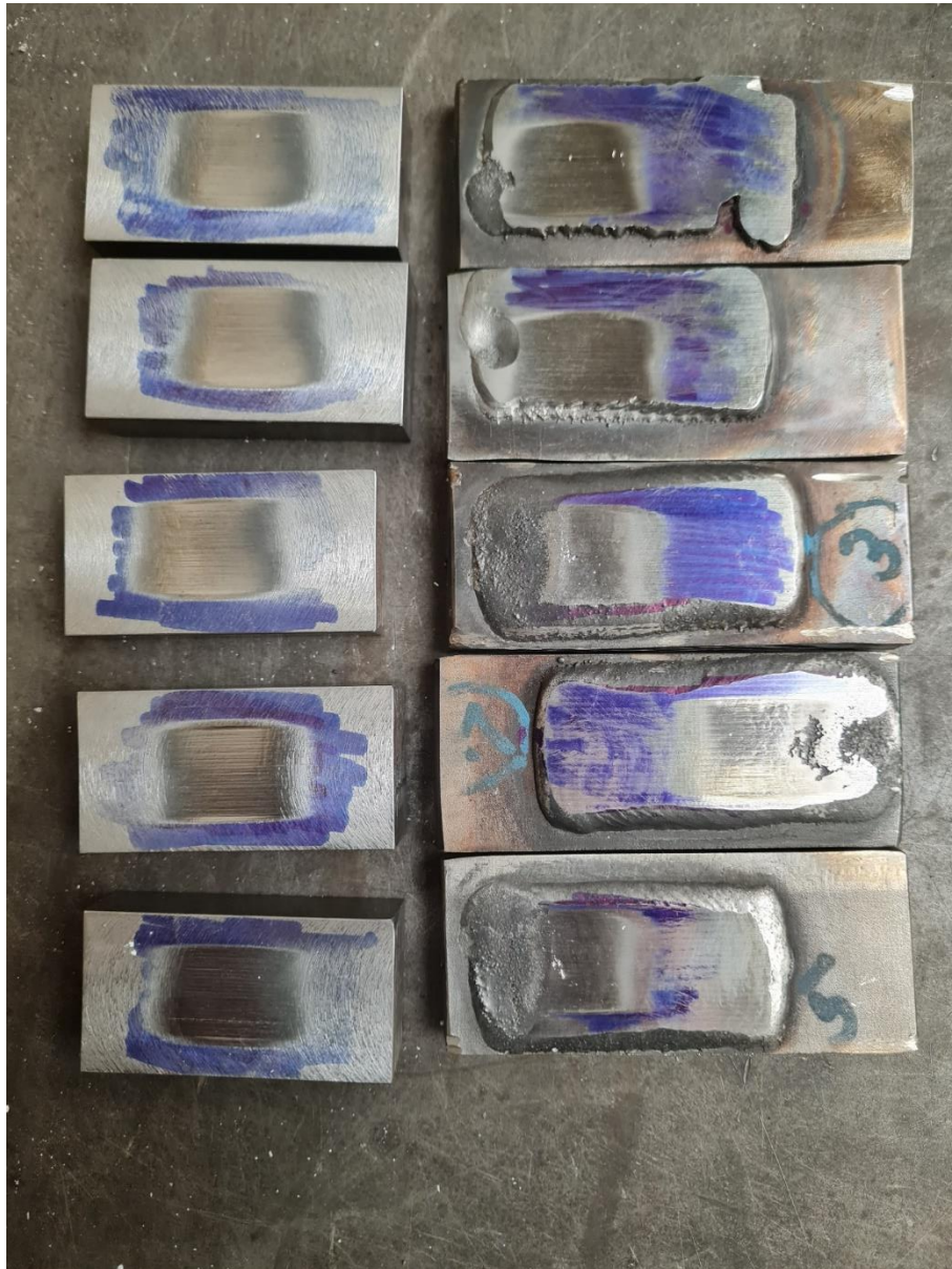
Obrázek 41 Vzorky a etalony po abrazivní zkoušce
