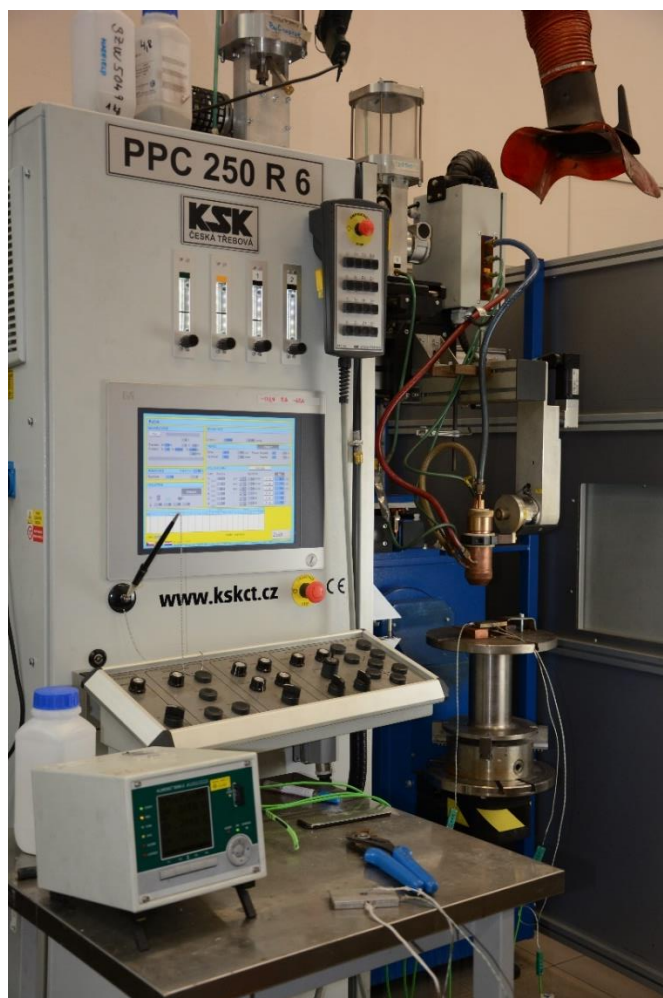
Obrázek 19 Plazmový navařovací automat PPC 250 R 6
