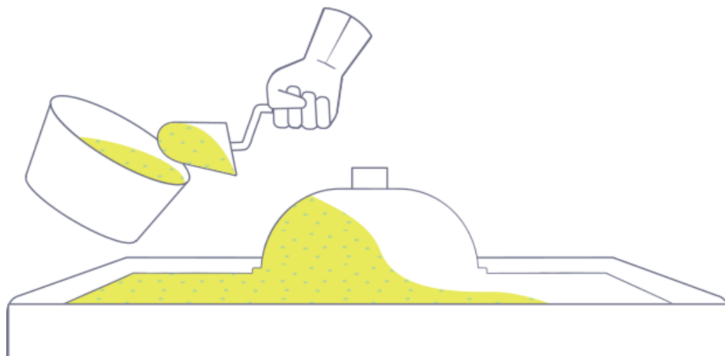
Obrázek 5 Metoda Gel coat (gelem potažený kultivovaný kámen) [24]
