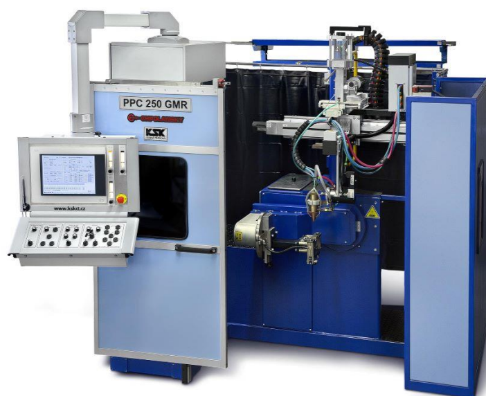
Obrázek 8 - Univerzální navařovací automat PPC 250 GMR [18]
