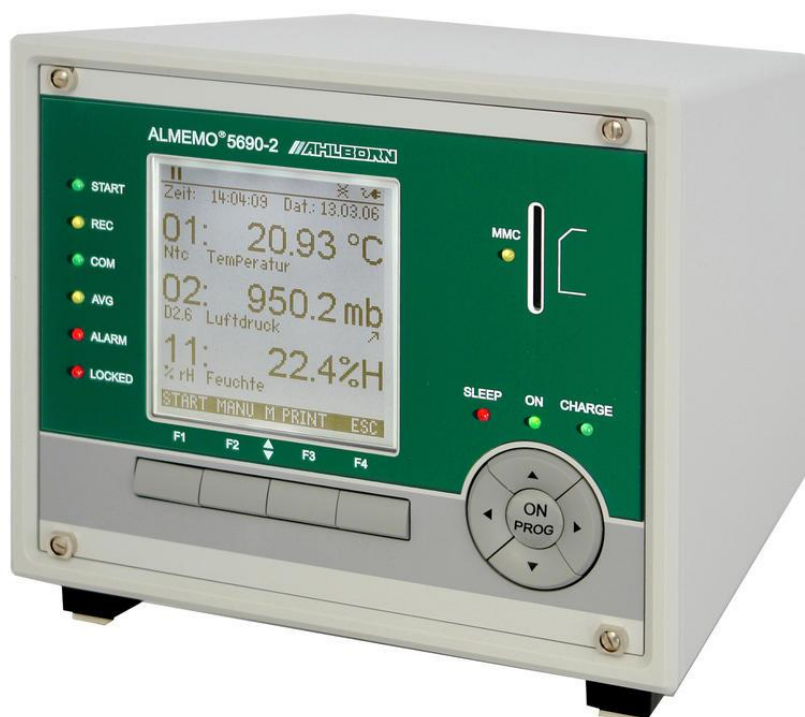
Obrázek 16 - Univerzální měřicí ústředna ALMEMO 5690-2 [45]
