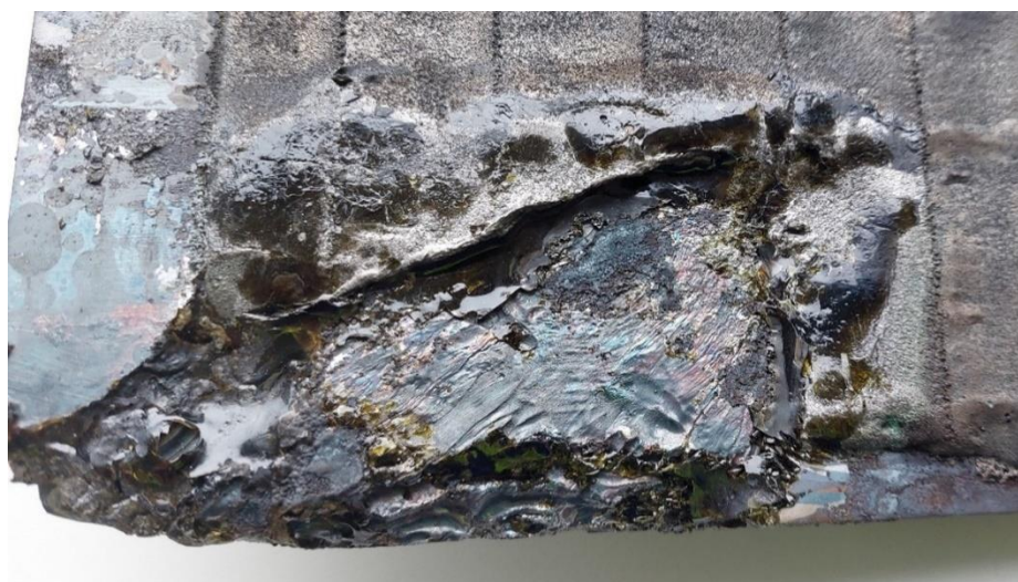
Obrázek 46 - Stav vzorku po očištění od ztuhlé taveniny [47]
