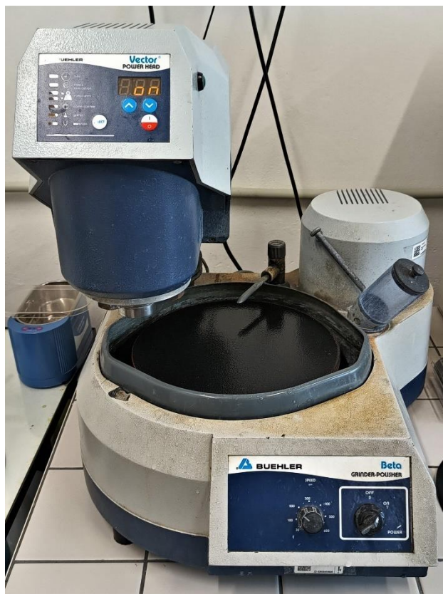
Obrázek 21 - Buehler Beta s automatickou hlavou Buehler Vector Power Head
