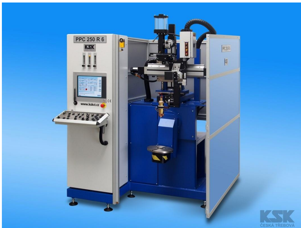
Obrázek 12 - Plazmový navařovací automat PPC 250 R6 (KSK, s.r.o., Česká Třebová) [18]
