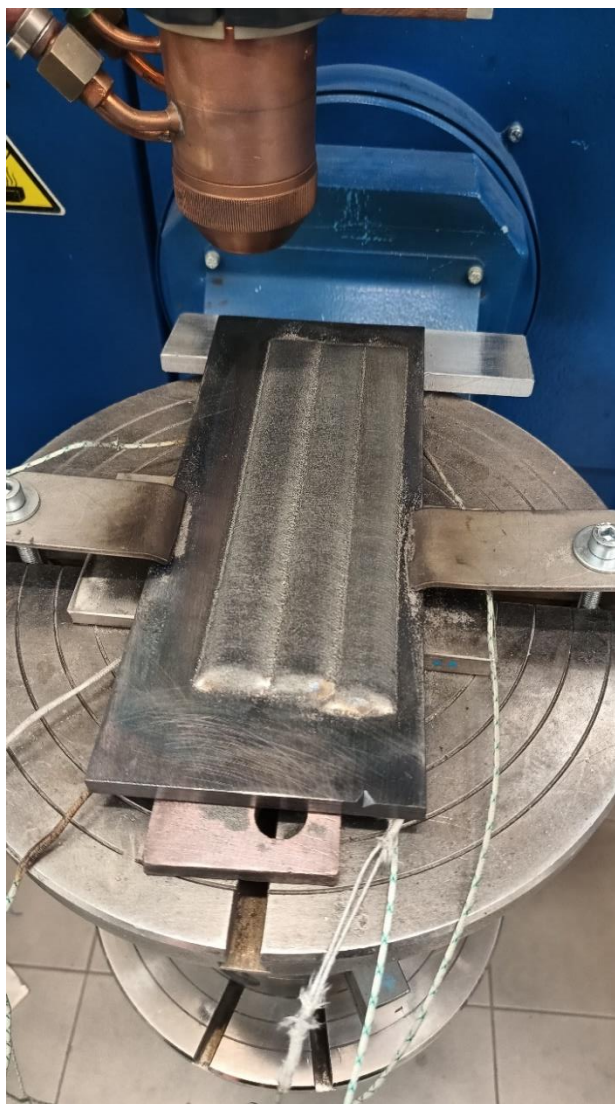
Obrázek 15 - Příklad upnutí vzorku
