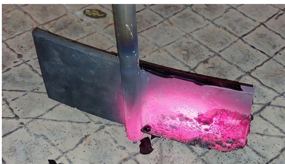
Obrázek 45 - Spodní strana vzorku po vytažení z proudu lávy [47]
