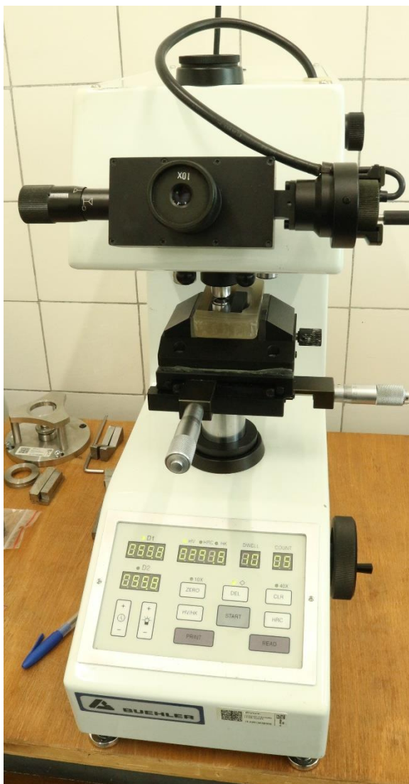
Obrázek 20 - Tvrdoměr IndentaMet 1104 (Buehler) s upnutým vzorkem
