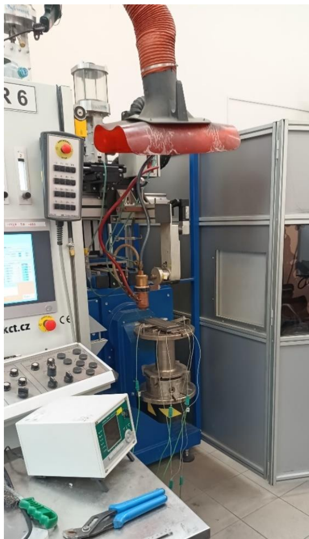
Obrázek 13 - Pracoviště připravené pro navaření vzorku
