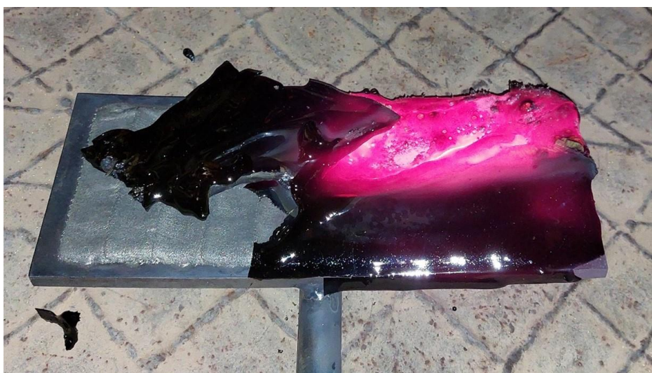
Obrázek 44 - Stav vzorku po vytažení z proudu lávy [47]
