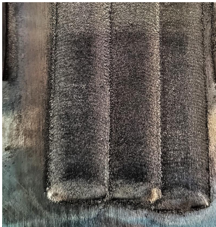
Obrázek 27 – Vzorek číslo 9 v průběhu navařování první vrstvy
