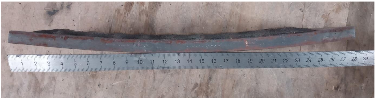
Obrázek 28 - Deformace vzorku číslo 9 vlivem tepla [foto: Ing. Pavel Rohan, Ph.D.]
