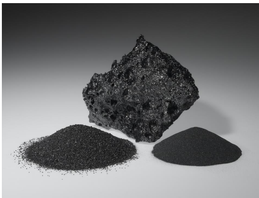
Obrázek 11 - Karbid bóru v práškové formě (hrubá a jemná frakce) [40]
