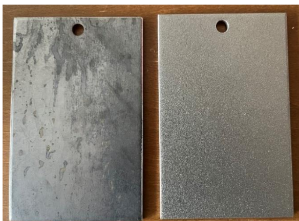
Obr. 12: Vzorek před a po tryskání ocelovými kuličkami
