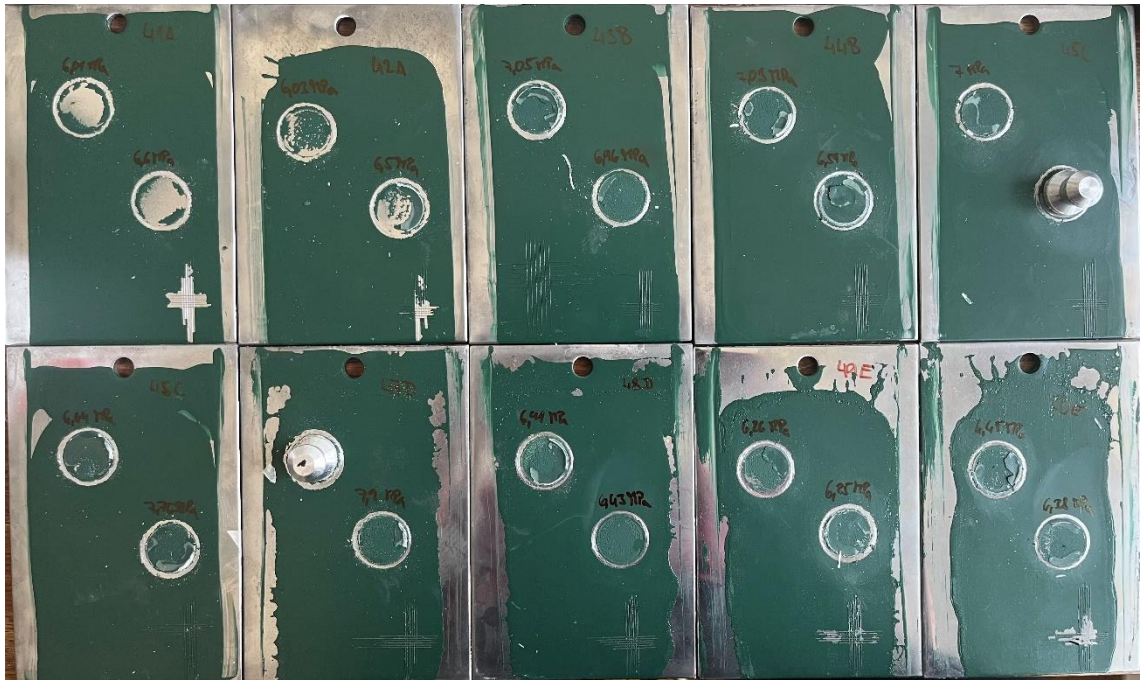
Ručně leštěné vzorky po zkouškách přilnavosti nátěru
