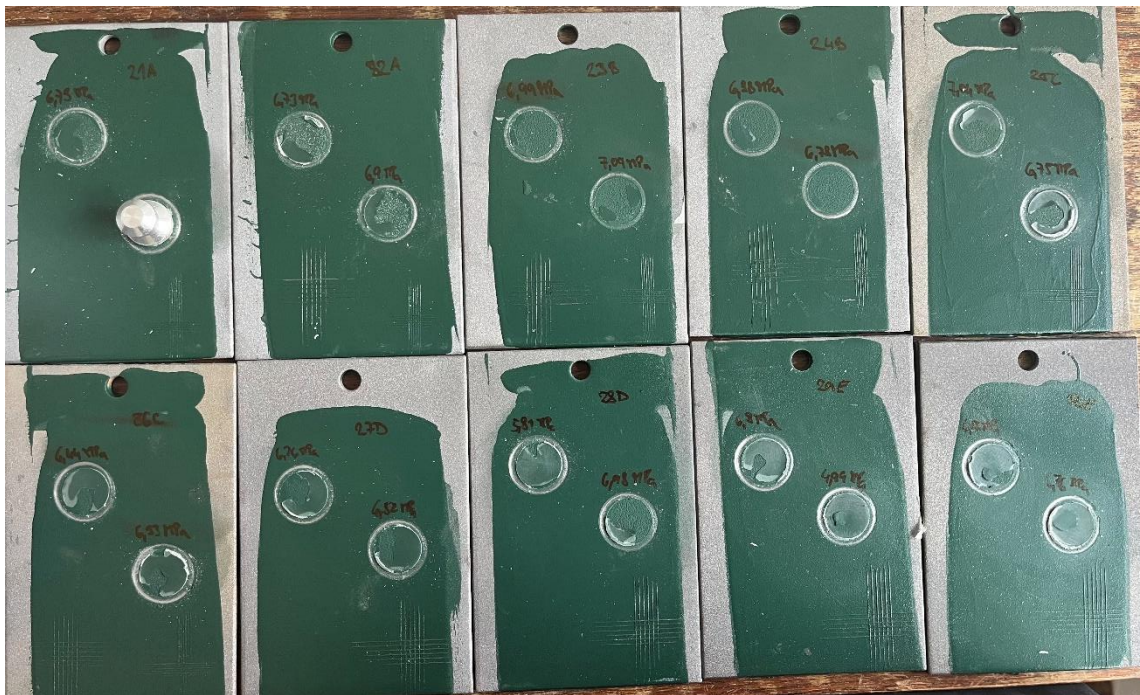
Vzorky otryskané křemičitým pískem po zkouškách přilnavosti nátěru
