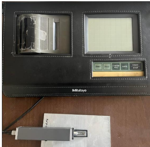
Obr. 5: Drsnoměr Mitutoyo SJ-301
