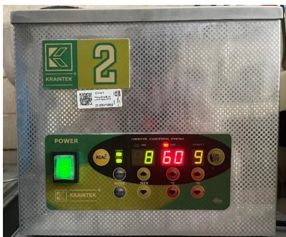
Obr. 16: Ultrazvukové odmašťovací zařízení s nastavenými hodnotami
