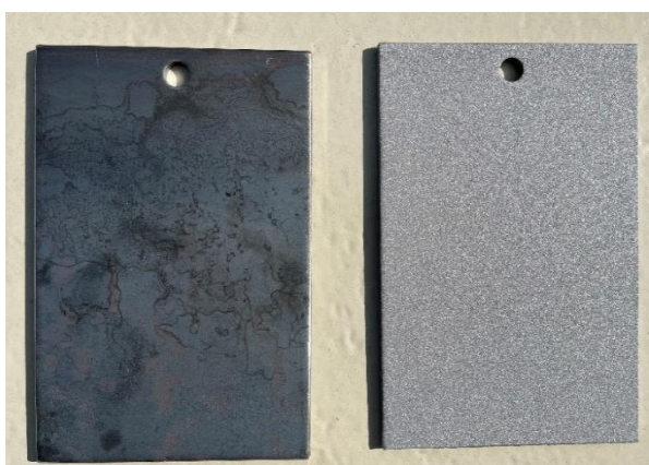
Obr. 14: Vzorek před a po tryskání křemičitým pískem
