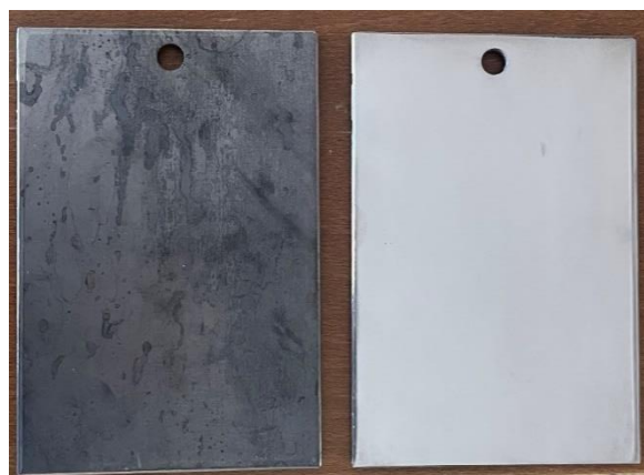
Obr. 15: Vzorek před a po ručním leštění
