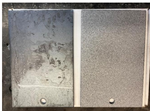
Obr. 13: Vzorek před a po tryskání ocelovou drtí
