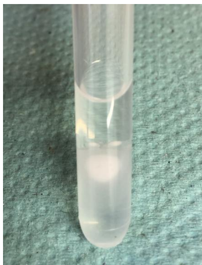
Obrázek 7: Fotografie bílé sraženiny vzniklé v systému 0,01M HCl/0,2M Aliquat 336 a 1 % obj. oktanolu.
