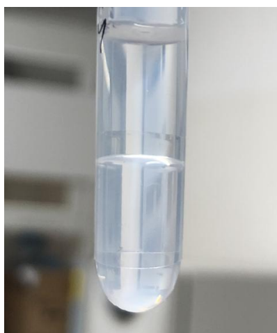
Obrázek 3: Fotografie třetí fáze vytvořené v systému 5,0M HCl/0,2M Aliquat 336 - kerosen s 1 % obj. oktanolu
