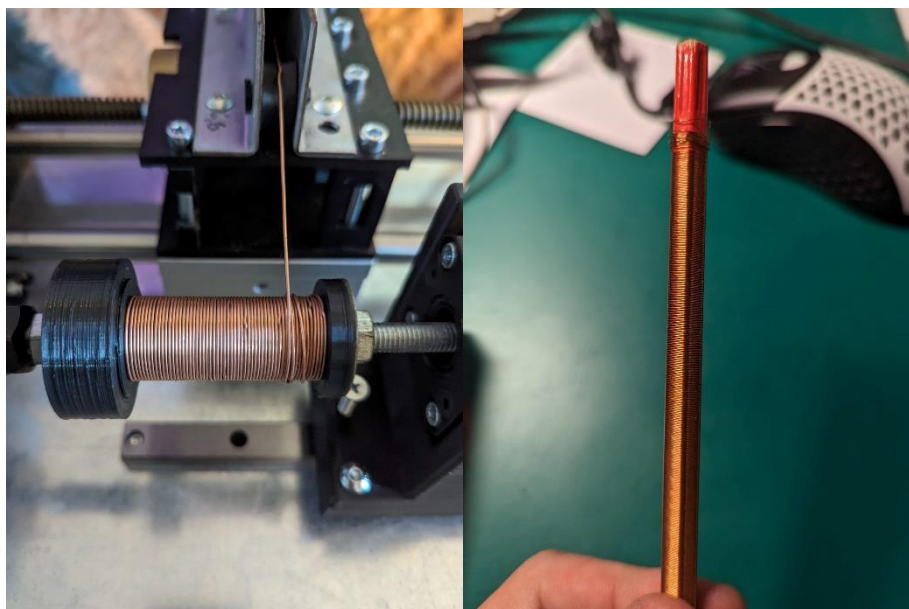
Obr. 33 - Cívka ze drátu \varnothing 0,8\text{mm} (vlevo)
