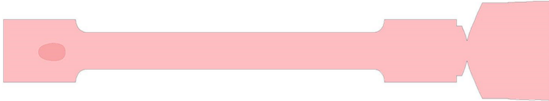
Obr. 35 Detail na smrštění vzorku vyrobeným gravitačním litím
