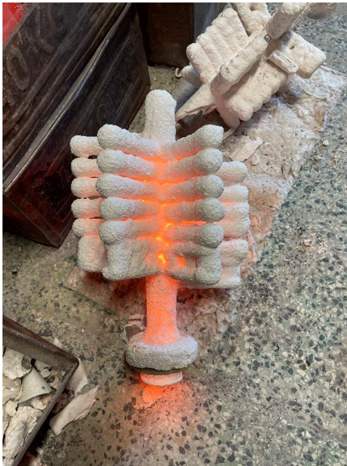
Obr. 14 Skořepina těsně po odlití
