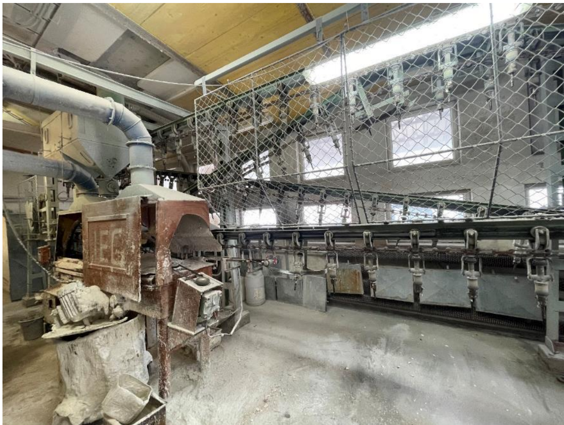
Obr. 12 Výrobní linka na nanášení keramické břechky
