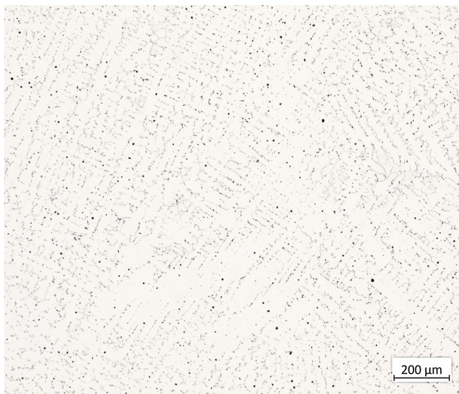
Obr. 23 Vnitřní struktura po odlití (neleptáno)
