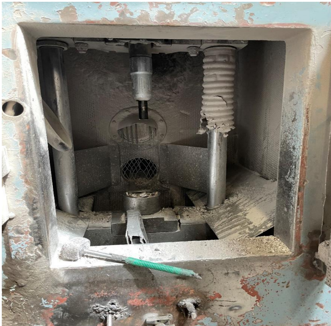
Obr. 15 Stroj odstraňující skořepiny vibracemi
