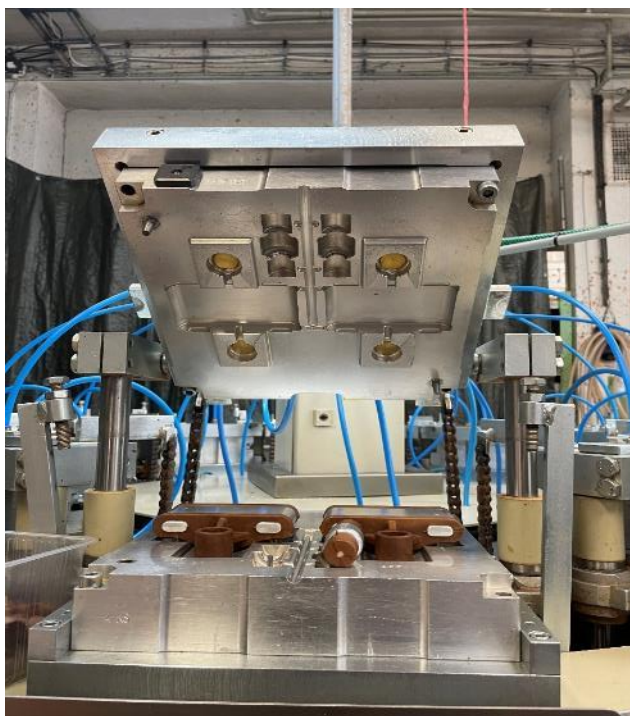
Obr. 7 Forma na vstřikování vosku
