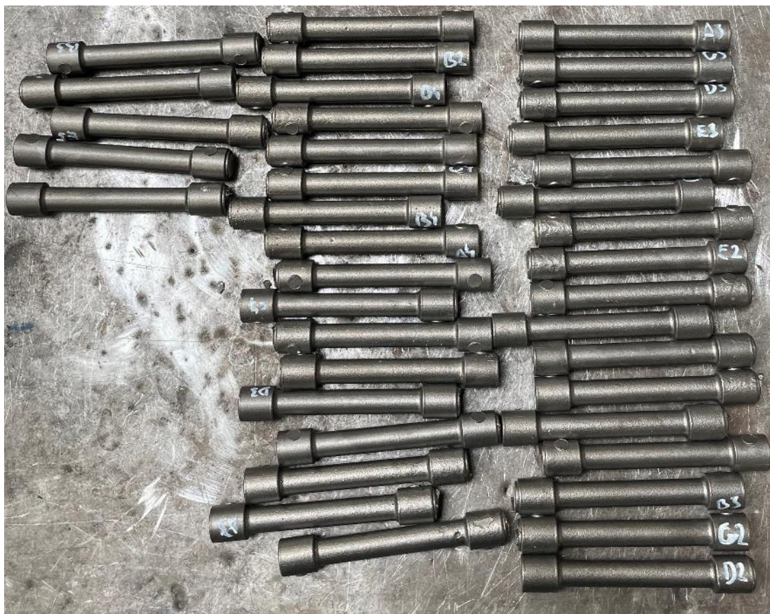
Obr. 52 Popsané vzorky připravené na tahovou zkoušku
