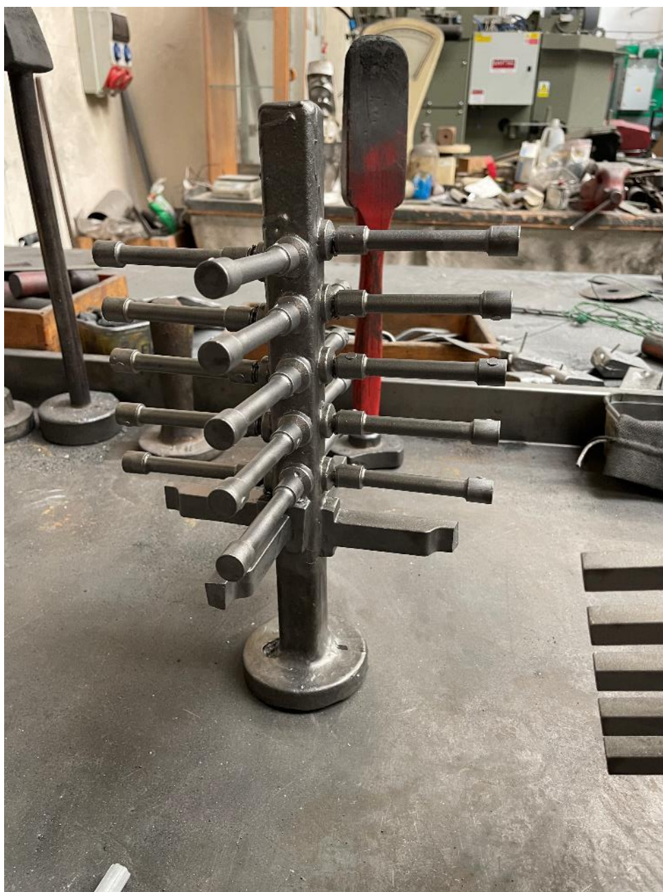
Obr. 51 odlitý stromeček před odřezáním vzorků
