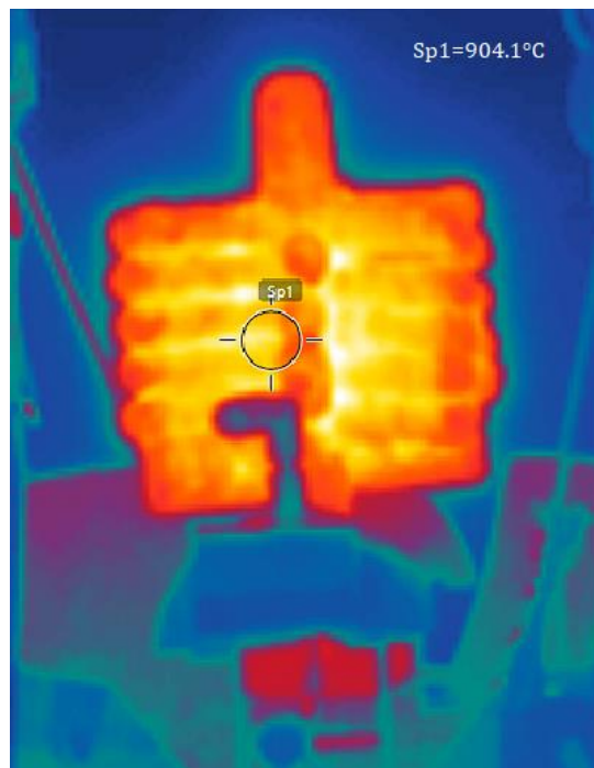
Obr. 50 Detail na skořepinu 46 s po odlití kovu
