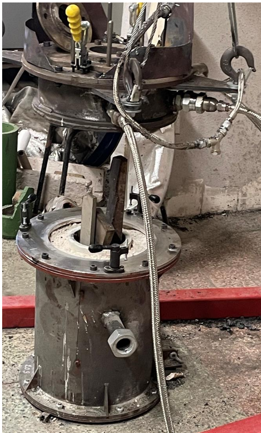
Obr. 30 Plnění stroje materiálem určeného k roztavení
