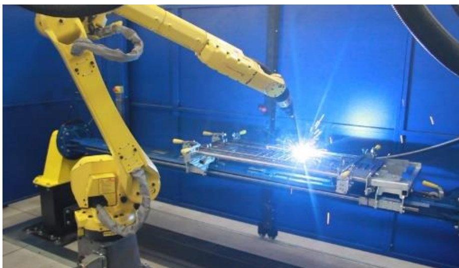
Obrázek 2: Ukázka robotizovaného procesu navařování [2]
