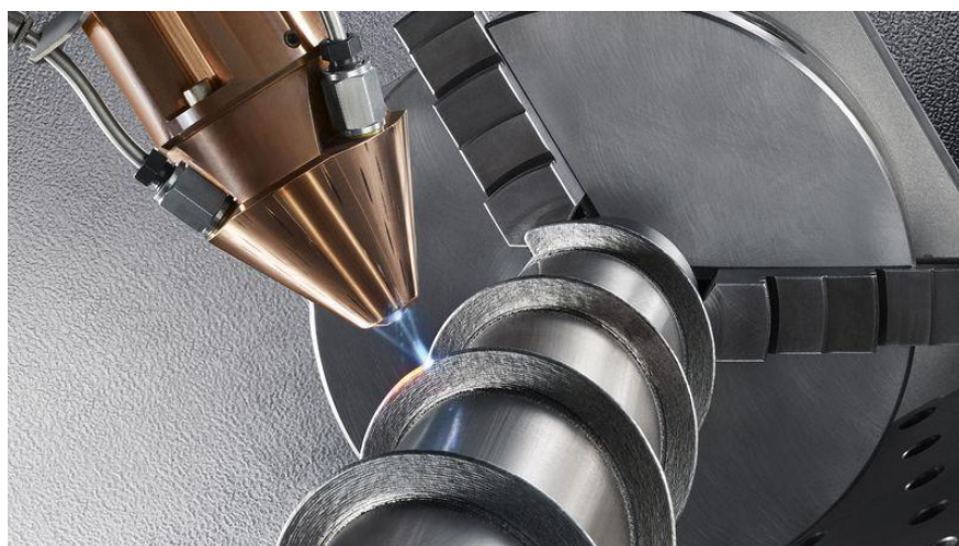
Obrázek 3: Ukázka laserového práškového navařování [31]
