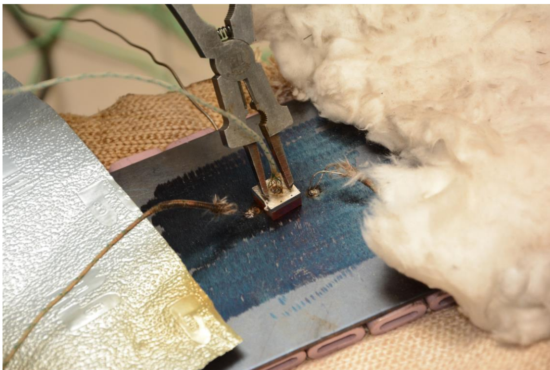
Obrázek 46: Zkoušení tepelné vodivosti vzorků
