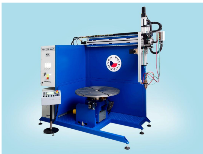
Obrázek 6: Jednoúčelový navařovací automat uzpůsobený pro navařování armatur [8]
