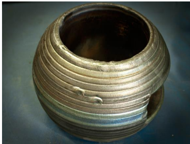
Obrázek 4: Povrch armatury s navařeným povrchem metodou PTA [32]
