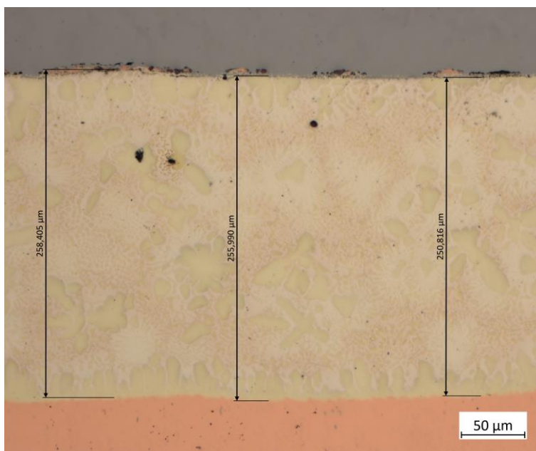
Obrázek 37: Vzorek 2_ Výbrus 1 (tloušťka – 200x)
