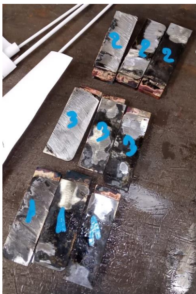
Obrázek 17: Vzorky po pájení
