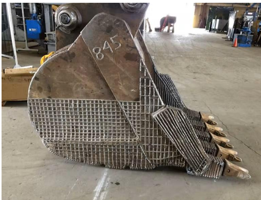
Obrázek 7: Hardfacing – ukázka ošetřeného rypadla [30]
