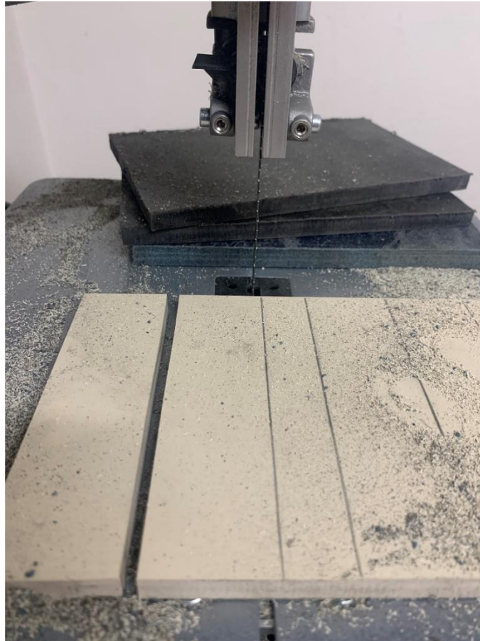
Obrázek 26: Řezání polotovarů na pásové pile
