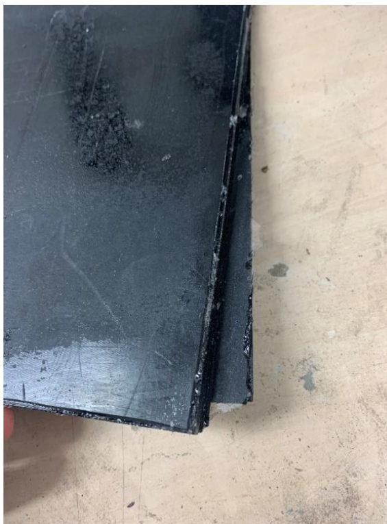
Obrázek 25: posunutí vrstev kompozitu
