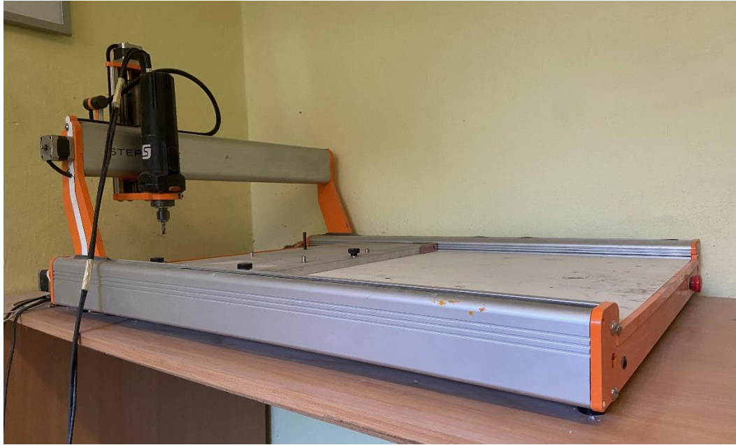
Obrázek 27: CNC frézka STEPCRAFT D840
