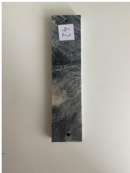
Obrázek 33: Epoxidová pryskyřice bez výztuže
