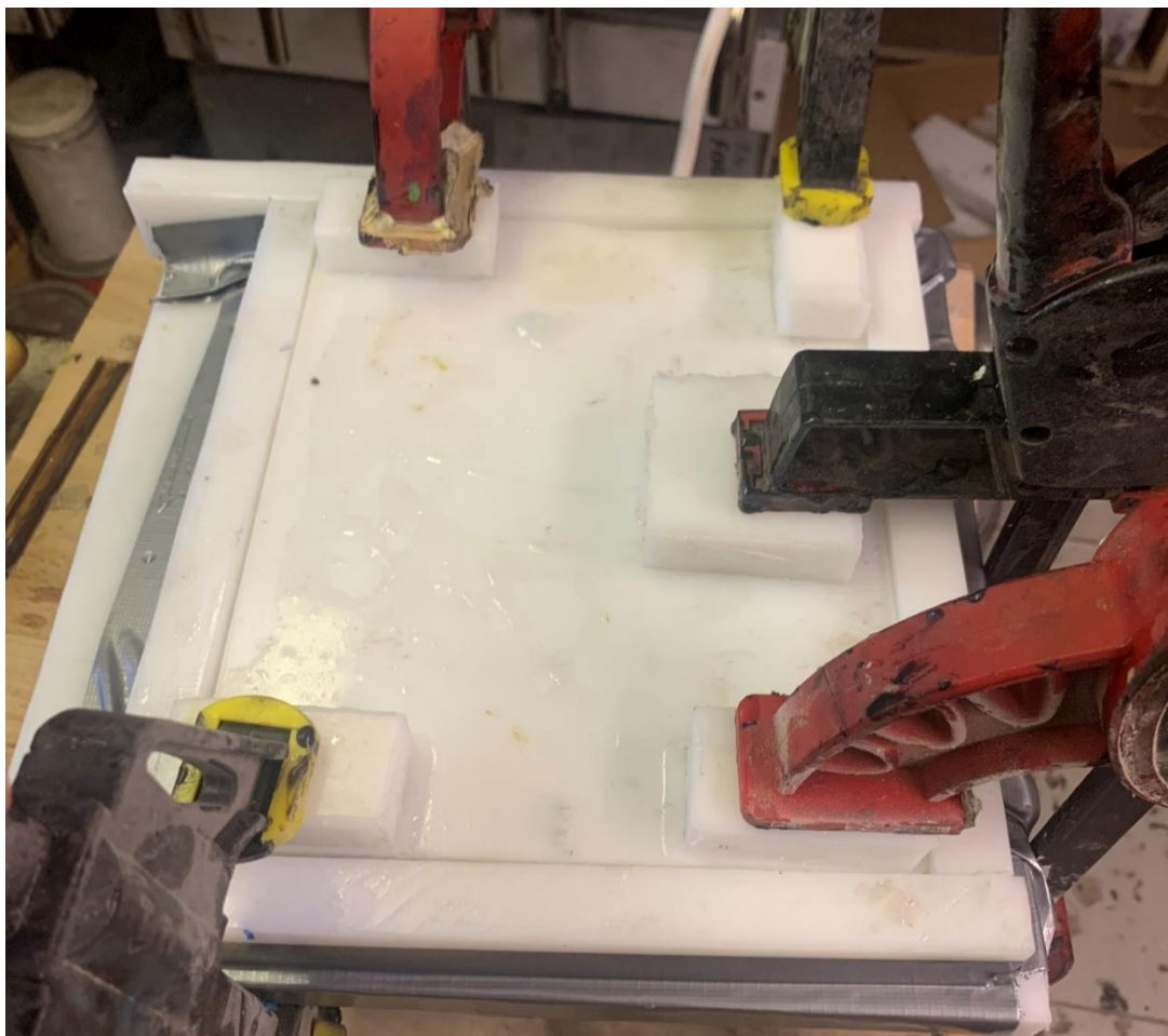
Obrázek 24: lisování kompozitu ve formě
