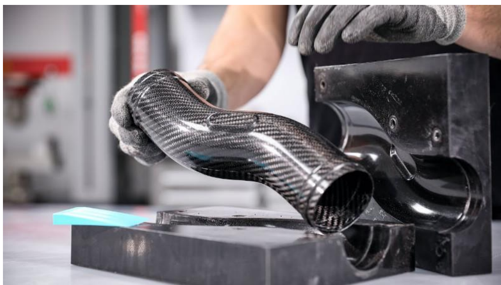
Obrázek 12: Výroba trubky z kompozitu s uhlíkovými vlákny [38]
