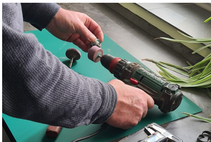
Obrázek 4.10: Broušení seříznuté hřídele
