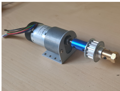
(a) : První část mechanismu u DC motoru s držákem
