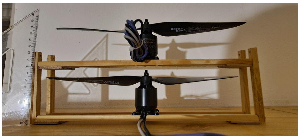
Obrázek 4.3: Schéma stojánku pro měření tahu pro dvě vrtule
