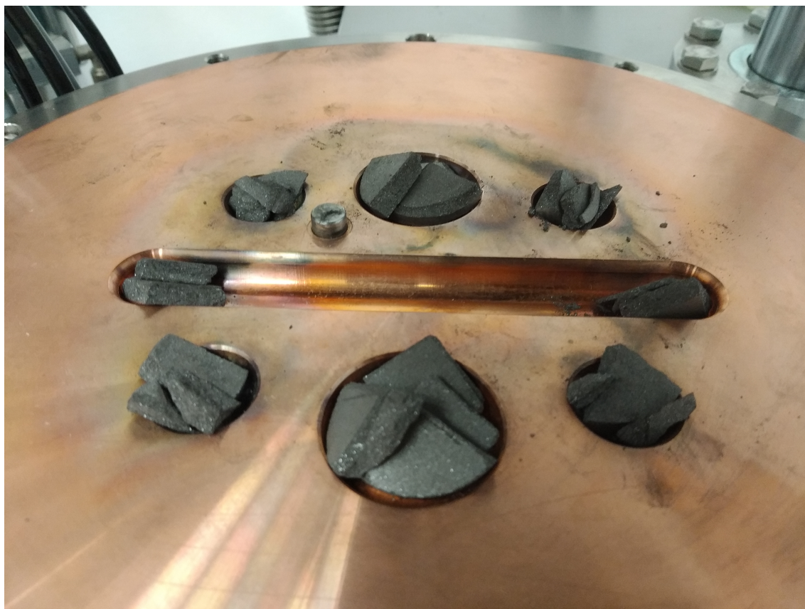
Obrázek 2.1: Nalámaná tableta připravená v základně obloukové pece
