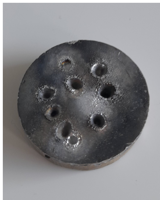
(a) Systém IJD během nanášení stříbra (b) Hliníkový terčík po depozicích bez rotace
