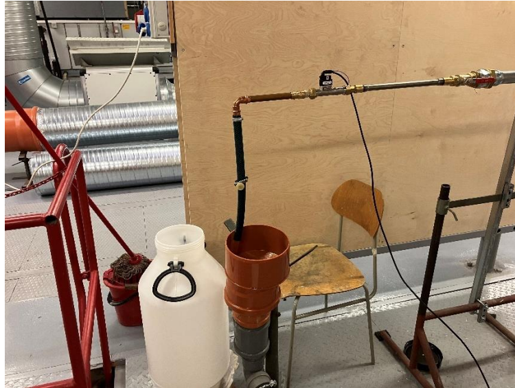
Obr. 26: Vyústění měřicí tratě s průtokoměrem a sběrnou nádobou
