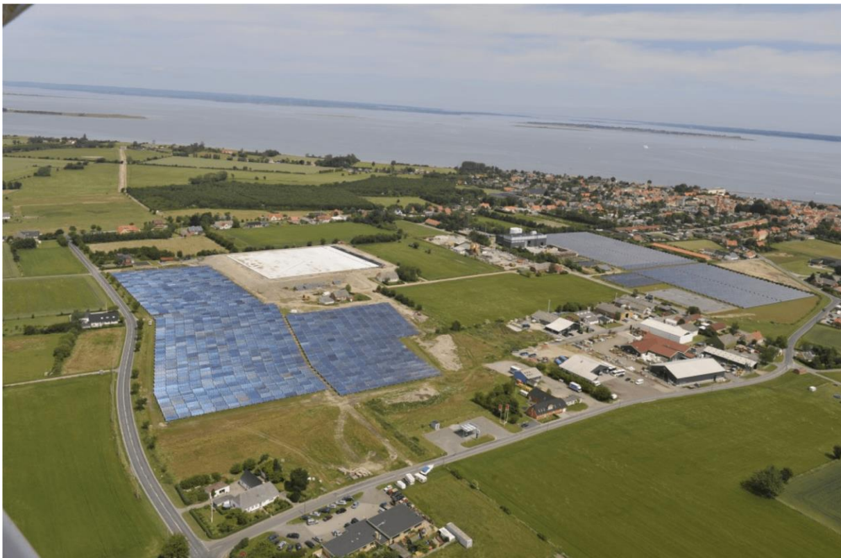
Obr. 4.6 – Pohled na kolektorová pole a akumulční zásobník ve městě Marstal [41]
