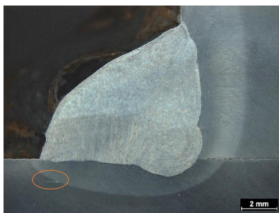
Detail – 1014 – podélná trhlinka v základním materiálu
