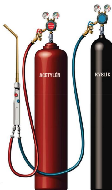
obr. 2- Soustava pro svařování plamenem [11] - upraveno
