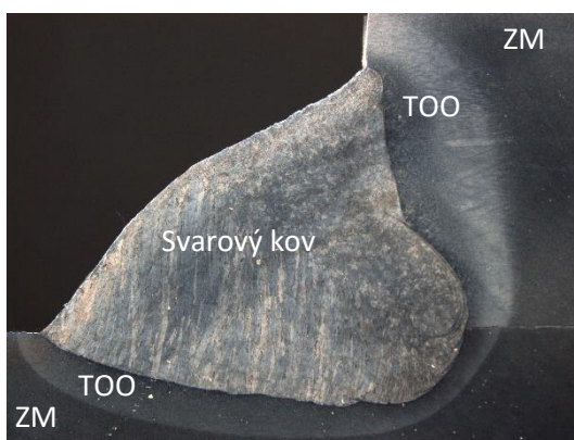
obr. 45 - Detail makrostruktur svaru 3
