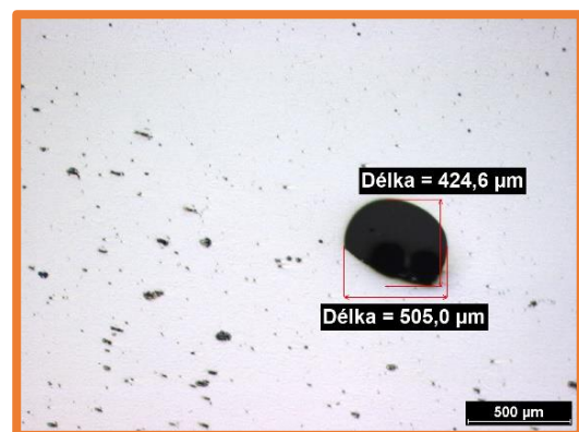
obr. 26 - Detail póru svaru 1
