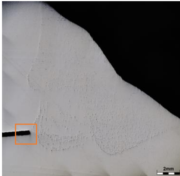
Neleptaná makrostruktura - 2012 - rovnoměrná pórovitost
