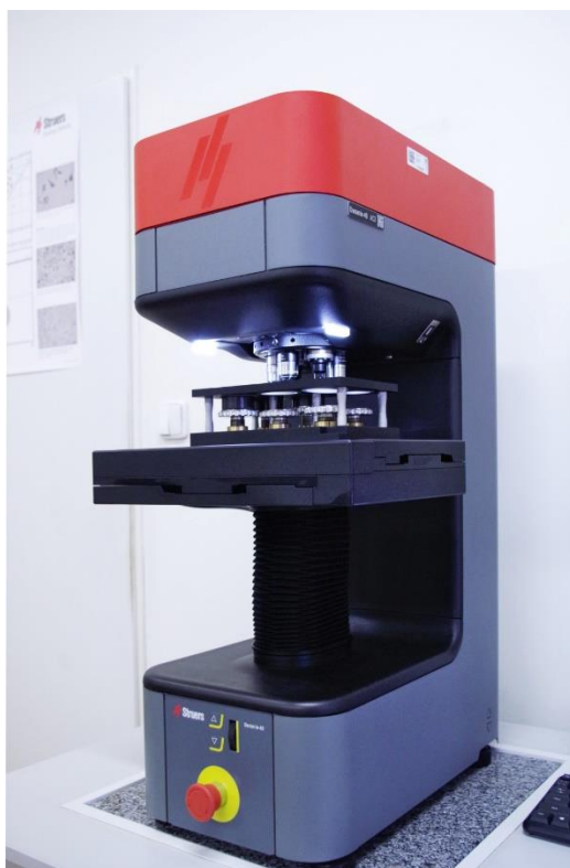
obr. 23 - Automatický tvrdoměr Struers Duramin 40AC3 [38]
