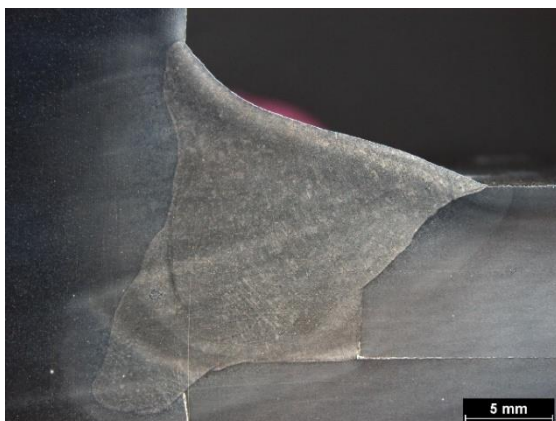
Detail – 512 – nadměrná asymetrie koutového svaru
