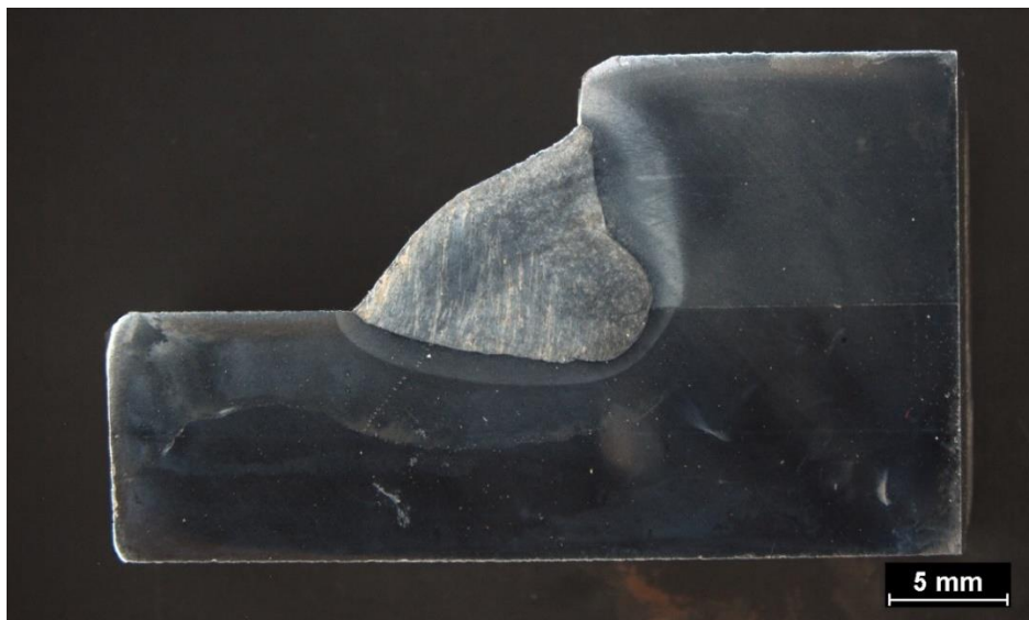
obr. 44 - Naleptaná makrostruktura svaru 3
