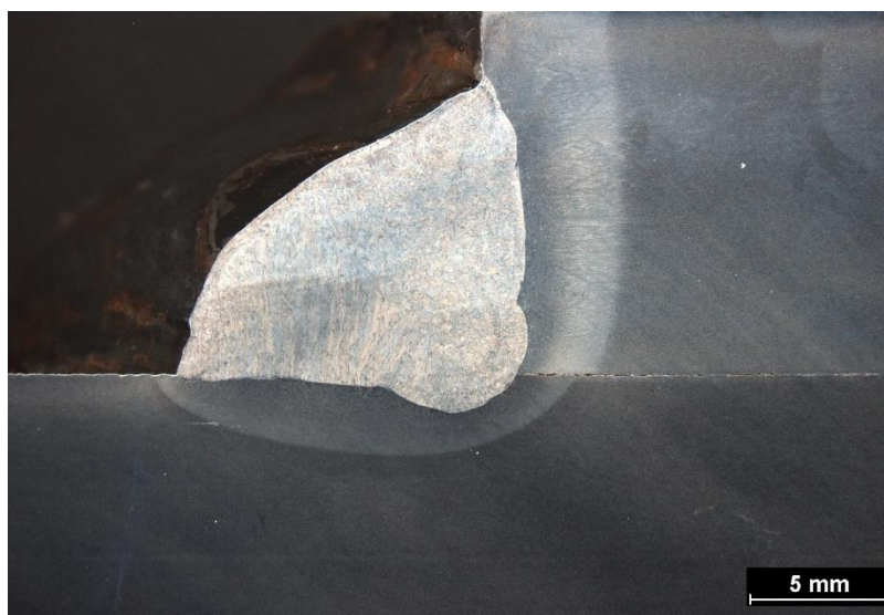
Makrostruktura – 514 – nadměrná nerovnost povrch
