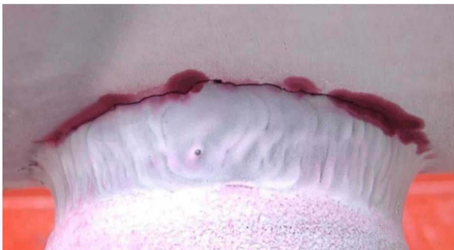
obr. 17 - Příklad indikací kapilárního zkoušení [35]
