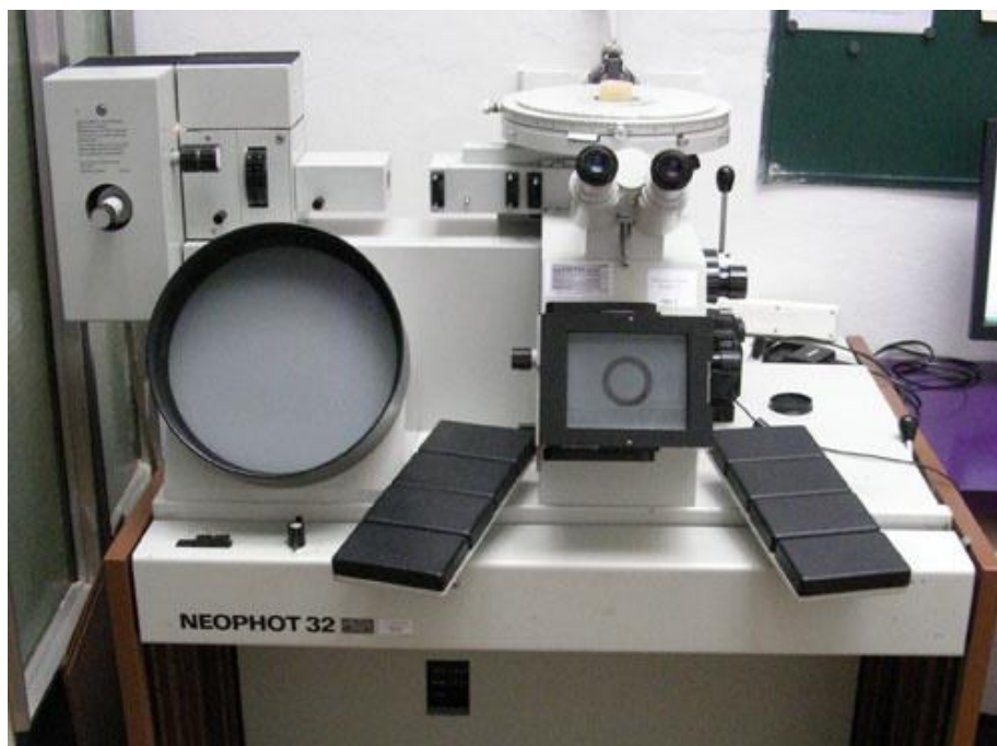
obr. 22 - Metalografický mikroskop Carl Zeiss Neophot 32 [35]
