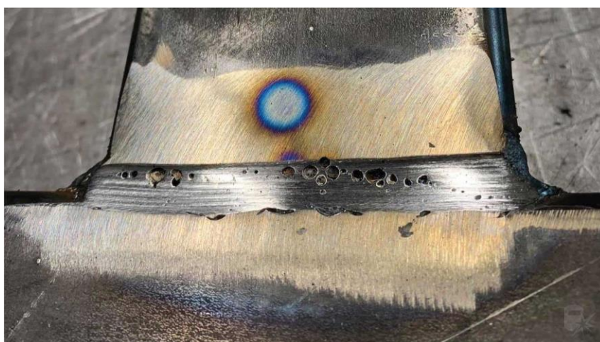
obr. 11 - Příklad výrazné pórovitosti [24]
