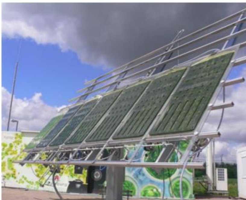
Obrázek 7 Deskový fotobioreaktor sledující slunce [21]
