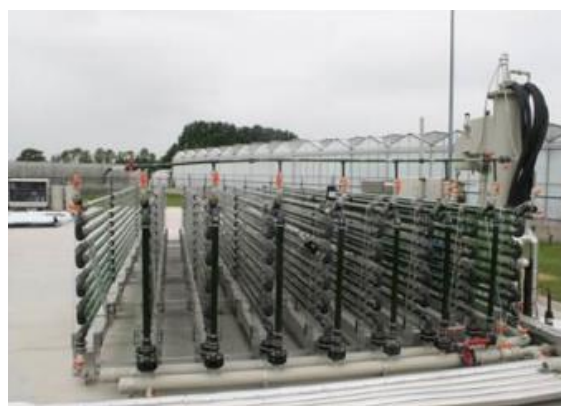
Obrázek 1 Vertikální trubkový fotobioreaktor [16]
