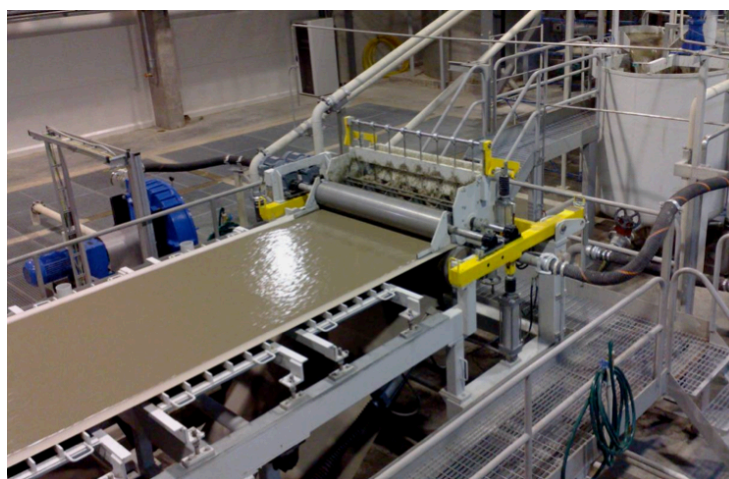
Obr. 8: Pohled na Flow-on stroj v provozu [2]
