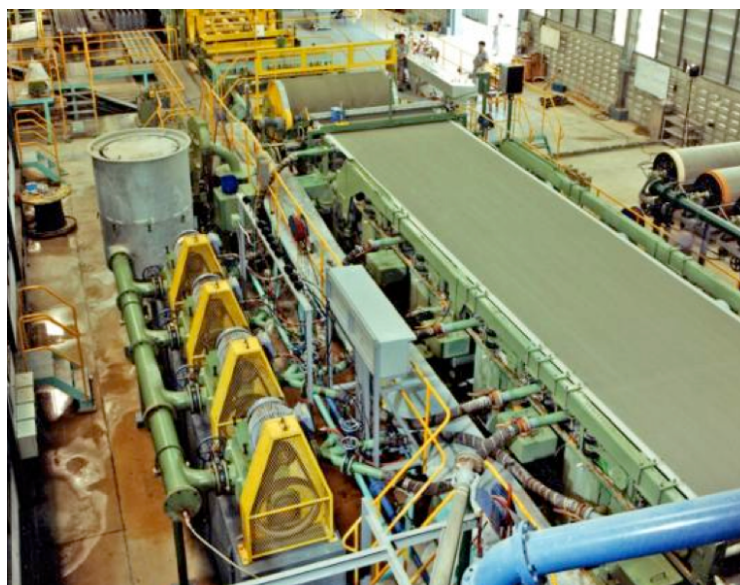
Obr. 5: Pohled na Hatschekův stroj v provozu [2]
