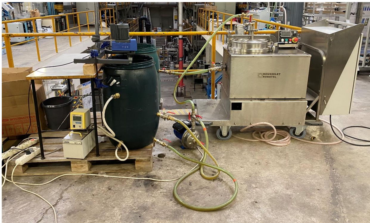
Obrázek 14 - Fotografie aparatury (zleva termostát, míchadlo, zásobní nádrž, čerpadlo, odstředivka)
