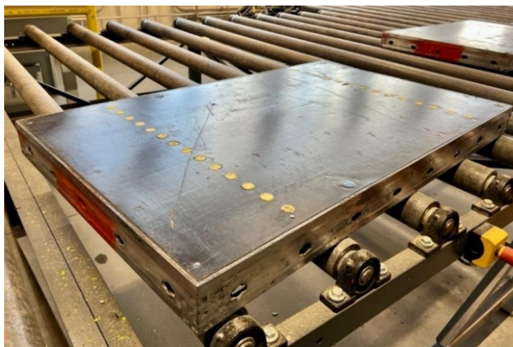
Obrázek 14 - Překližkové bednění se železným rámem [vlastní tvorba]
