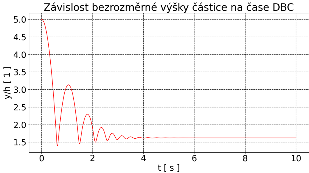
Obr. 2.19. Průběh y-ové souřadnice v závislosti na čase pro formulaci DBC
