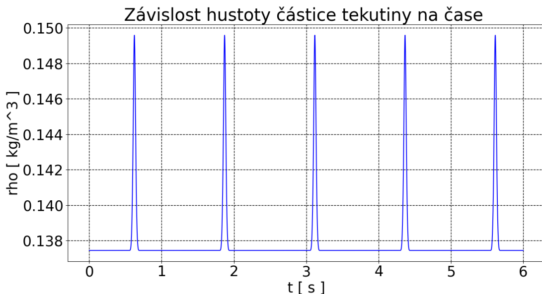
Obr. 2.6. Průběh hustoty pro SPH-BI simulaci volného pádu tekutiny na stěnu
