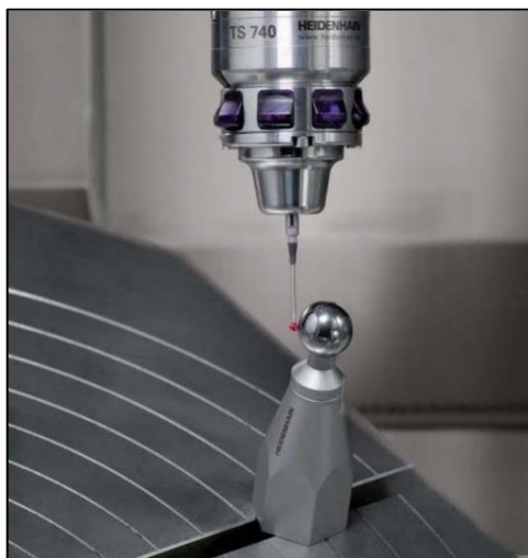
Obr. 33 Obrobková sonda a kalibrační kulička (50)
